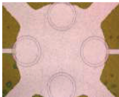
Figure I.6 : Photographie microscopique du système haptique à base de matériaux piézoélectriques
