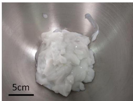
Figure 4-4 : Photographie d'un gel PEI/Silice à 15,5% en silice, ratio en masse PEI/Silice = 0,75.
