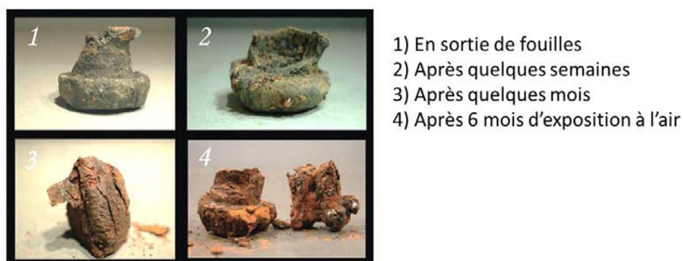
Figure 4 : Dégradation d'un rivet du sous-marin H.L. Hunley, mis au jour en 2001 et exposé à l'air, d'après [34].
