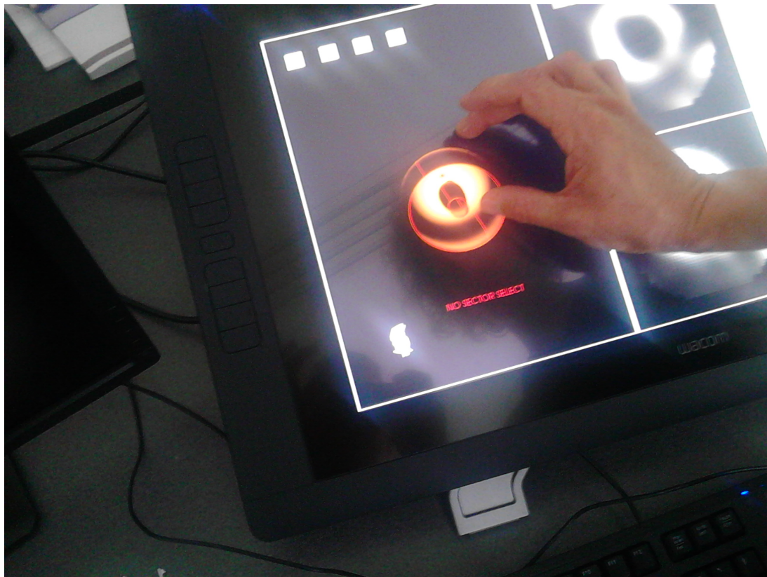
FIGURE 4.7 – Manipulation avec deux doigts de la surface 3D pour l'orienter dans l'espace.
