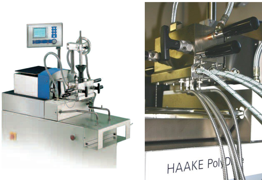
Figure 6.1 : photos d'un malaxeur Polydrive Haake. L'image de droite, tirée du site internet du CRIIT Matériaux Alsace, est un zoom de la chambre de malaxage.
