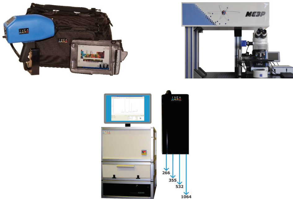
Figure 2.1 Instruments LIBS de la société IVEA acquis par le CRITT Matériaux Alsace : l'EasyLIBS (en haut à gauche) la MEEP (en haut à droite) et la MobiLIBS (en bas)
