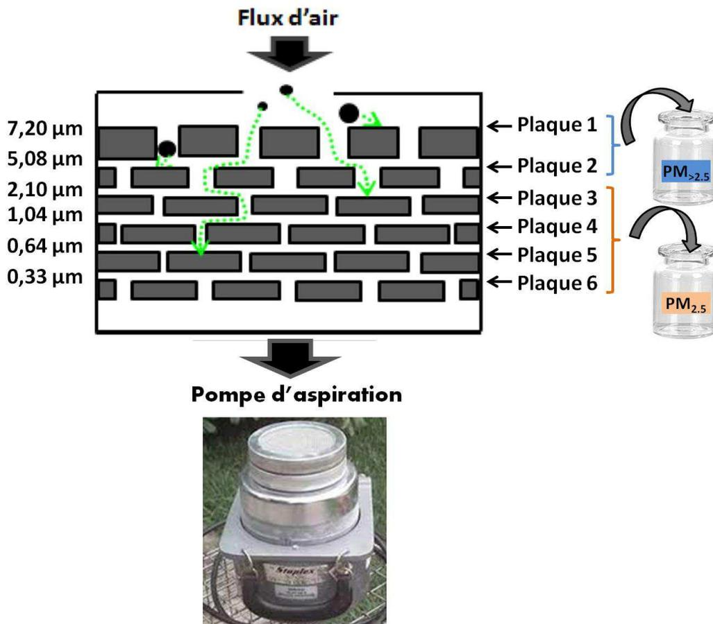
**Figure 50 : Schéma de l'impacteur en cascade utilisé pour le prélèvement**
