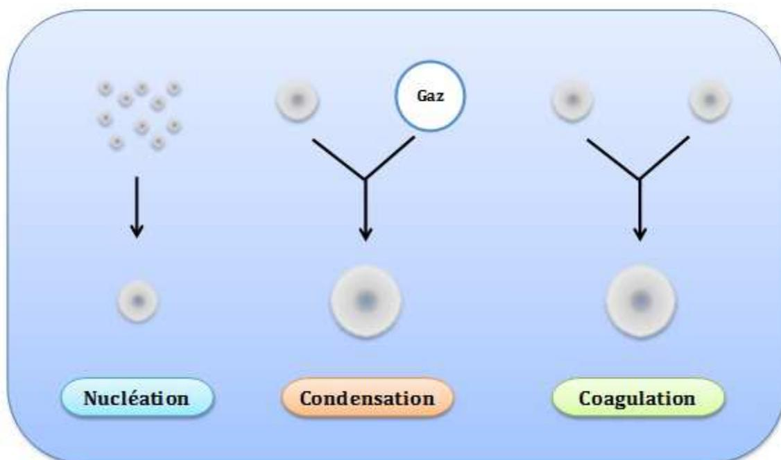
**Figure 3 : Mécanismes de formation des particules**
