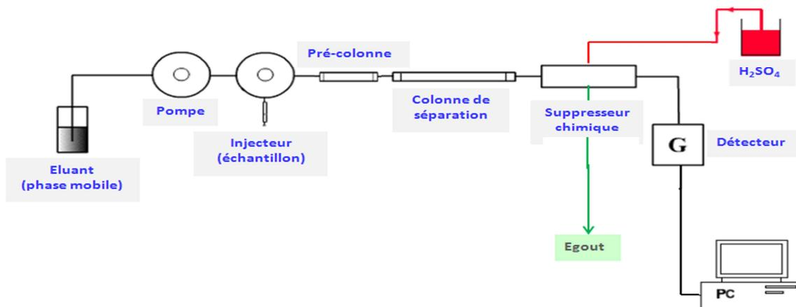
**Figure 55 : Schéma simplifié d'une chromatographie ionique**
