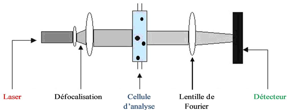
Figure 52 : Principe de la granulométrie laser
