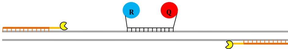
B. Hybridation et début de l'élongation, la Taq polymérase progresse le long du brin. Lorsque la sonde Taqman<sup>®</sup> est hybridée, la fluorescence du rapporteur est quenchée.
