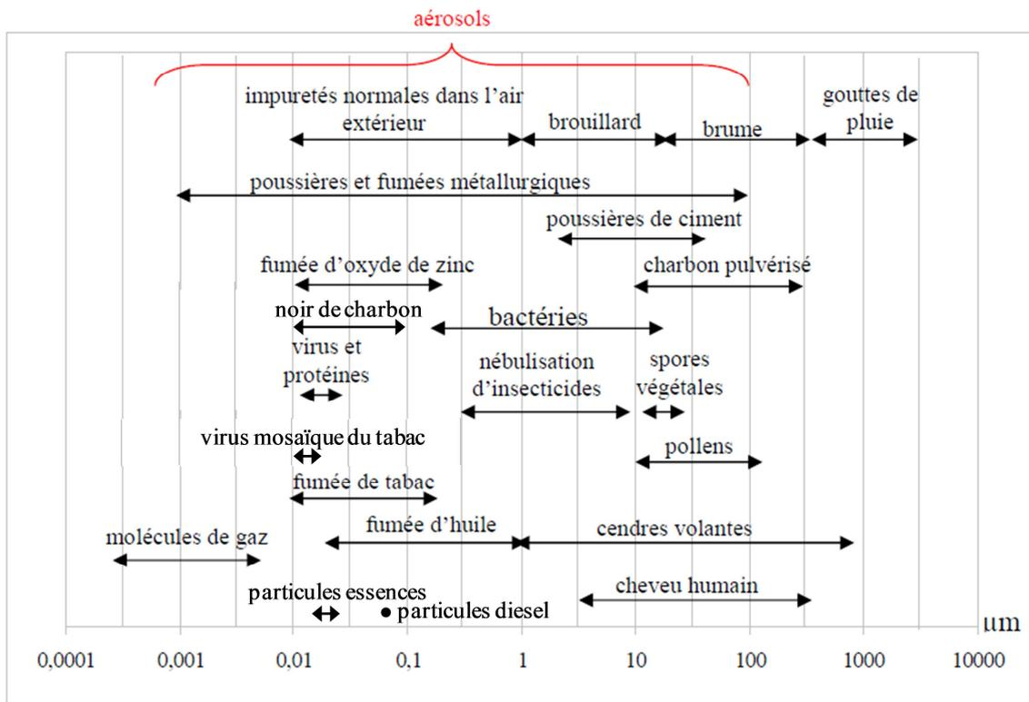
**Figure 2 : Diamètres aérodynamiques des aérosols dans l'atmosphère**
