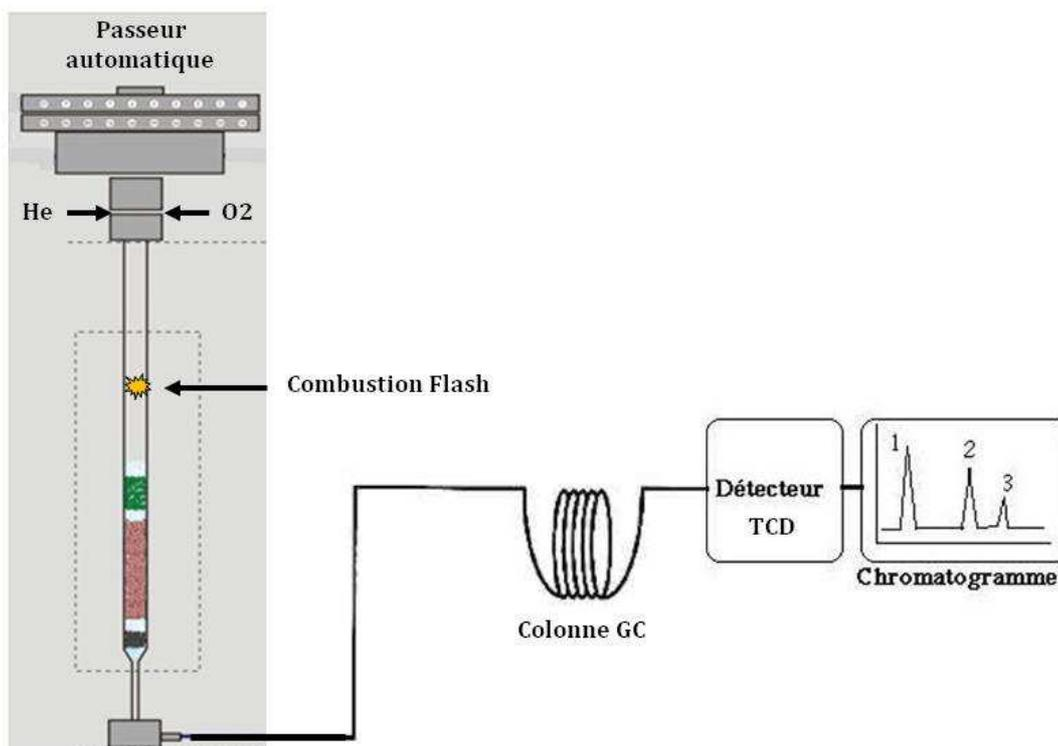
Figure 58 : Schéma simplifié de l'analyseur CHNS
