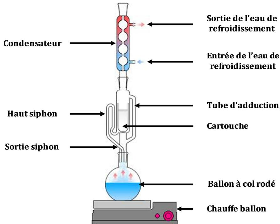
**Figure 57 :** Représentation schématique d'un extracteur soxhlet
