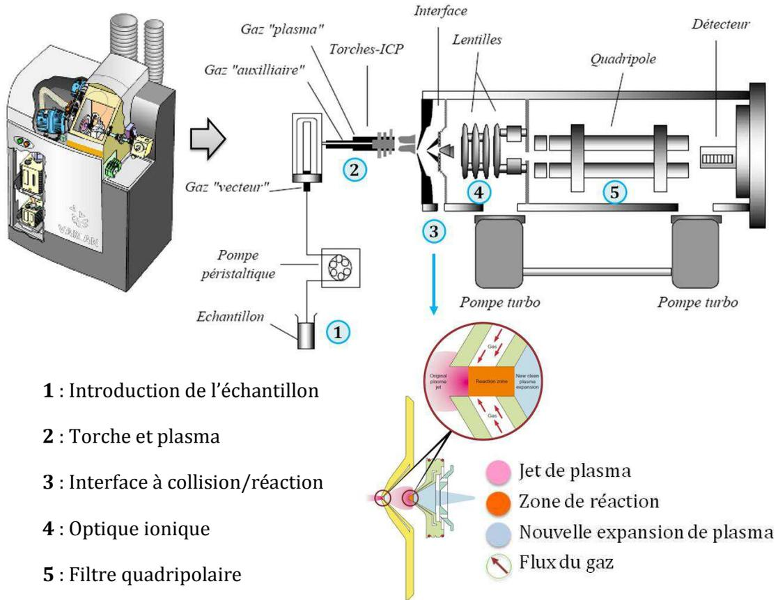
**Figure 54 : Principe de fonctionnement de l'ICP-MS**
