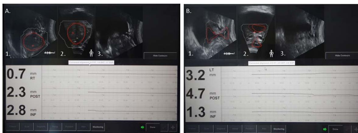
FIGURE 2.8 – Captures de l'écran de contrôle pendant la phase de monitoring pour un patient non opéré (A.) et un patient traité après une prostatectomie (B.). Les fenêtres 1. et 2. correspondent aux coupes sagittale et coronale de l'image 3D reconstruite. La fenêtre 3 correspond à l'acquisition 2D en temps réel. En-dessous de ces trois fenêtres, nous pouvons voir les décalages calculés par l'algorithme dans les trois directions.
