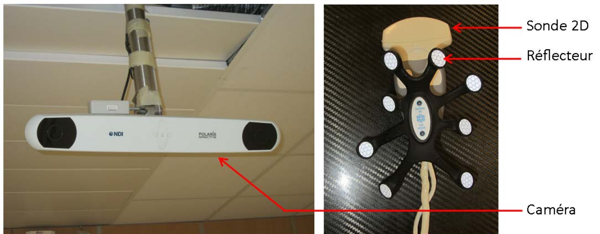
FIGURE 1.24 – Caméra infrarouge et réflecteurs associés à la sonde US.
