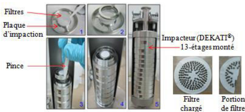
Figure 33 : Schéma du montage d'impaction en cascade - Dékati 13 étages (étapes 1 à 5), filtre chargé de particules (en entier et coupé).
