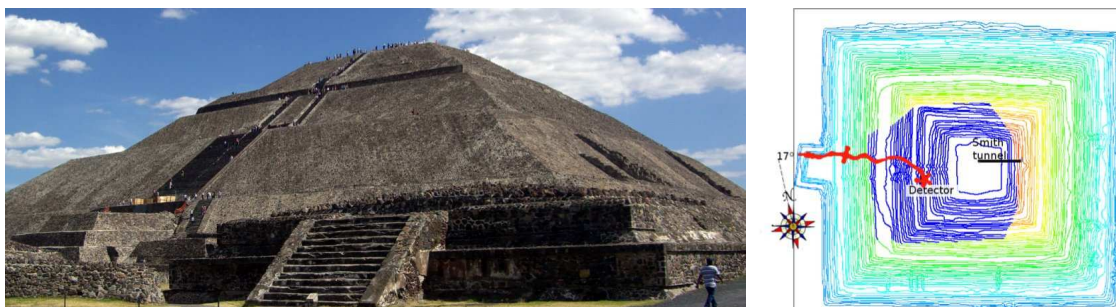
FIGURE 1.7: En bleu : le champ de vue du détecteur à l'intérieur de la pyramide (Aguilar et al. 2013)
