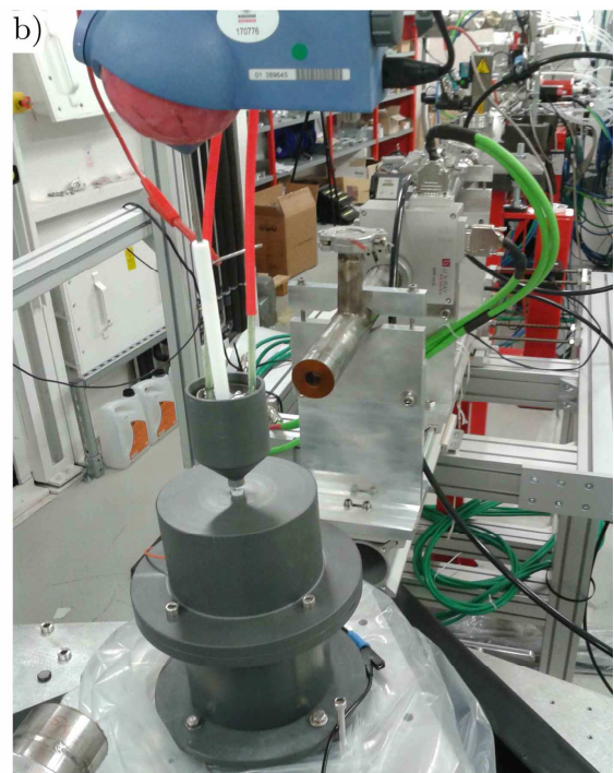
Figure 54 : Cellule électrochimique adaptée aux mesures GISAXS, a) schéma technique, b) photographie de la cellule sur la ligne SIXS.
