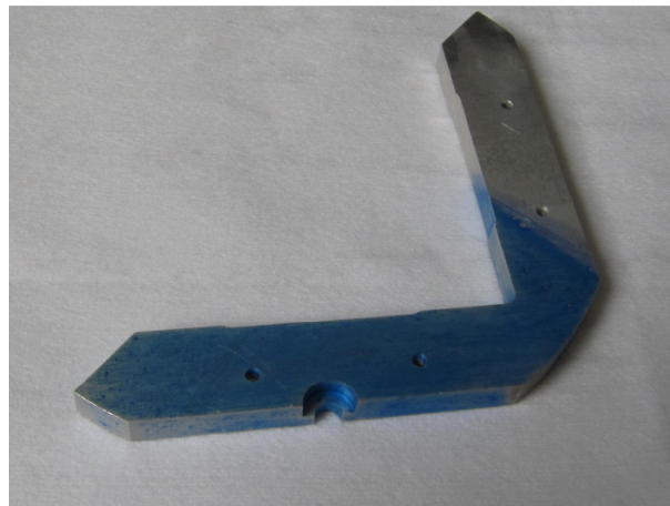
Figure 1 : photographie d'une pièce d'aluminium colorisée par la technique d'alumine anodique nanoporeuse.
