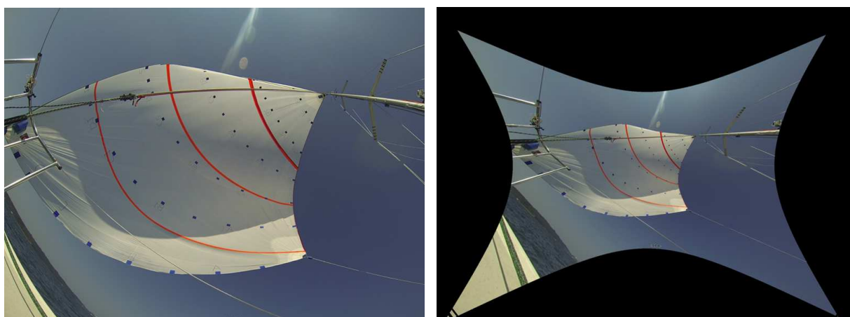
(a) Vue non calibrée du spinnaker d'une caméra GoPro placée sur le pont avant.
