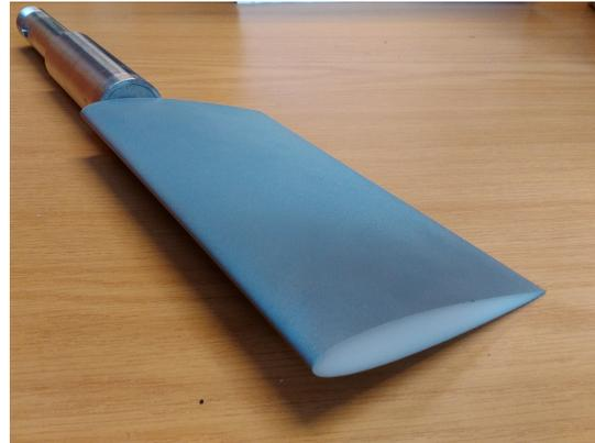
(b) Hydrofoil en POM (POM<sub>b</sub>, ici recouvert d'un film réfléchissant)
