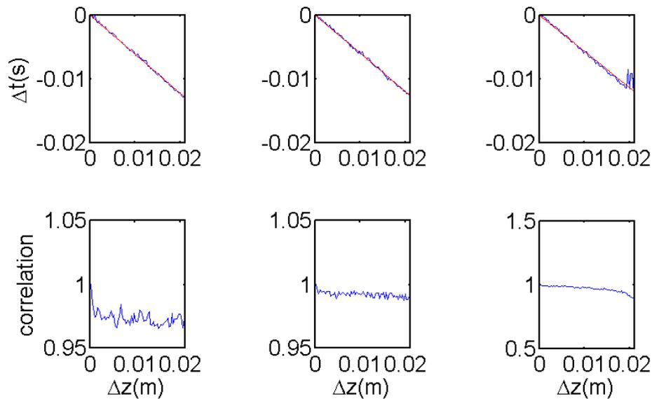
**Figure 4.15.** – Haut : Décalage temporel (ligne bleu)  $\Delta t$  mesuré entre les couples écartés de  $\Delta z$  pour les fréquences de  $100\text{Hz}$  (gauche),  $200\text{Hz}$  (milieu) et  $350\text{Hz}$  (droite) et régressions linéaires (ligne rouge). Bas : Coefficient de corrélation moyen entre les couples étudiés ci-dessus.
