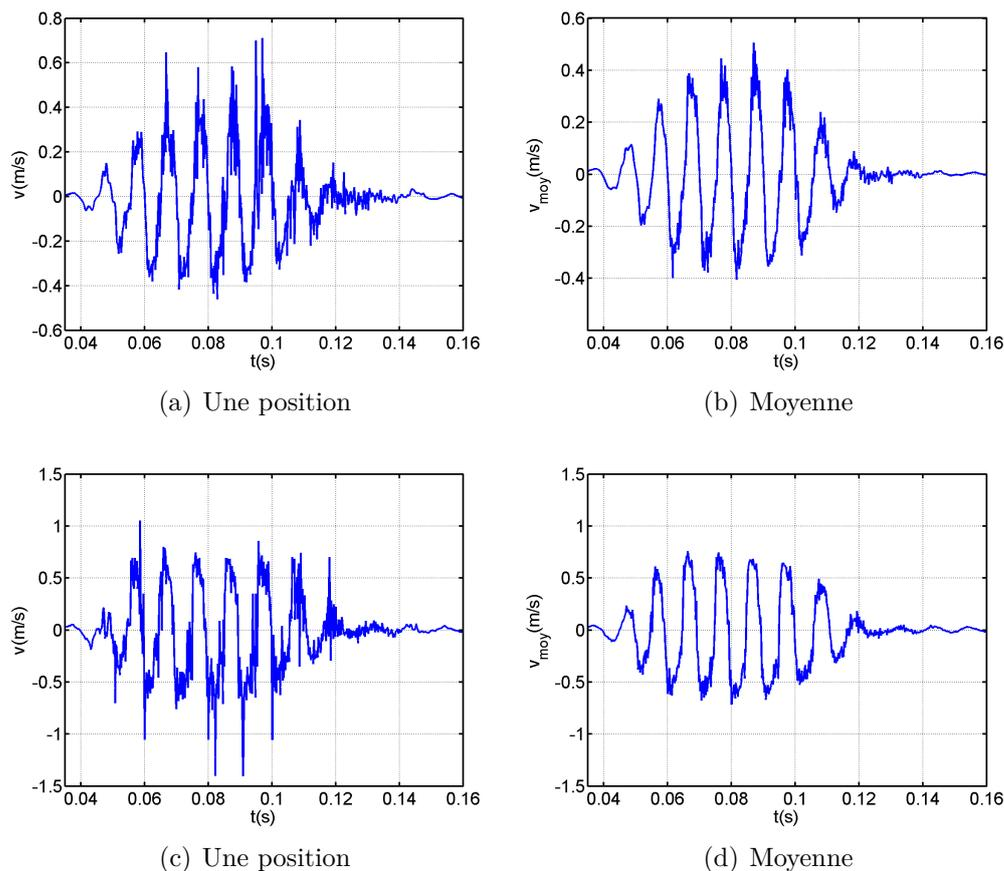
**Figure 4.8.** – Signaux temporels mesurés pour une émission d’amplitude  $500mV$  (haut) ou  $1000mV$  (bas) à une fréquence de  $100Hz$ . A gauche : exemple de signal mesuré en un point. A droite : exemple de signal après moyenne sur la profondeur de mesure.
