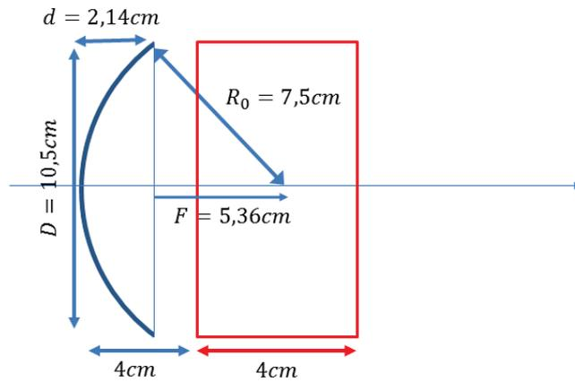
**Figure 5.1.** – Schéma de la source cylindrique (en bleu) et du domaine de mesure (en rouge)
