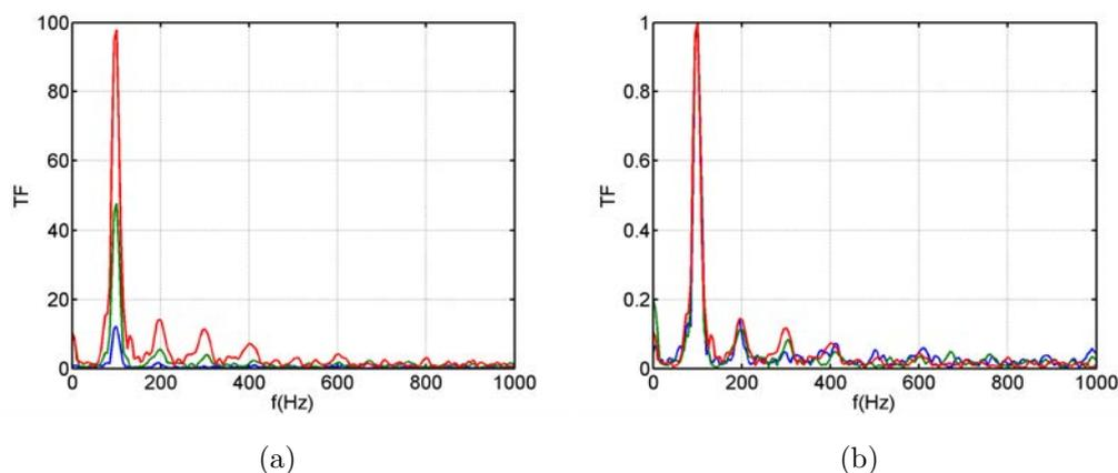
**Figure 4.10.** – Spectres des signaux moyennés mesurés dans le gel selon les mêmes conditions que Fig. 4.8 pour trois amplitudes d’émission  $200mV$  (bleu),  $500mV$  (vert) et  $1000mV$  (rouge). A gauche : spectre du signal (unité arbitraire). A droite : spectre normalisé par l’amplitude du fondamental.
