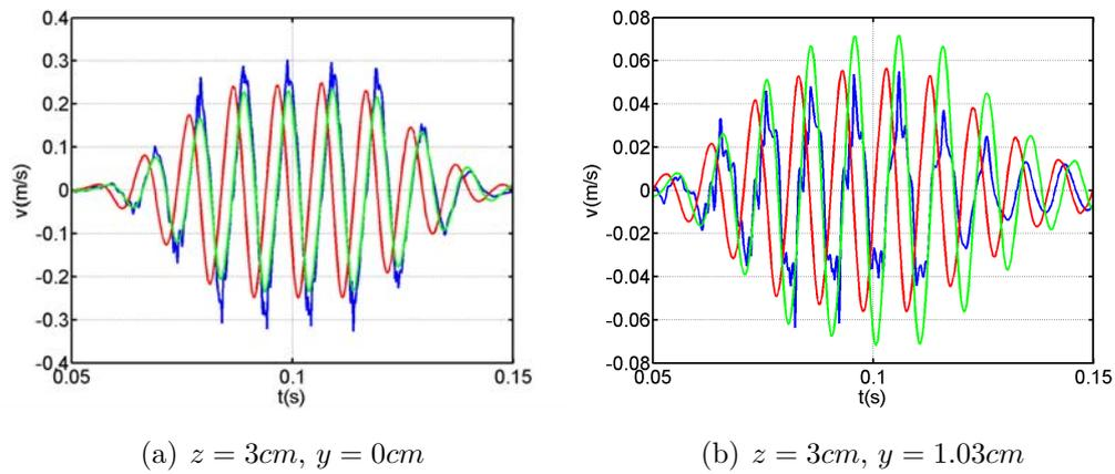
**Figure 5.9.** – Comparaison entre les résultats expérimentaux à  $200mV$  pic à pic (ligne bleue) avec les simulations pour  $\beta = 1$  avec  $c_T = 1.625m/s$  (ligne rouge) et  $c_T = 1.45m/s$  (ligne verte) en deux points de mesure sur (à gauche) et hors (à droite) de l'axe de propagation.
