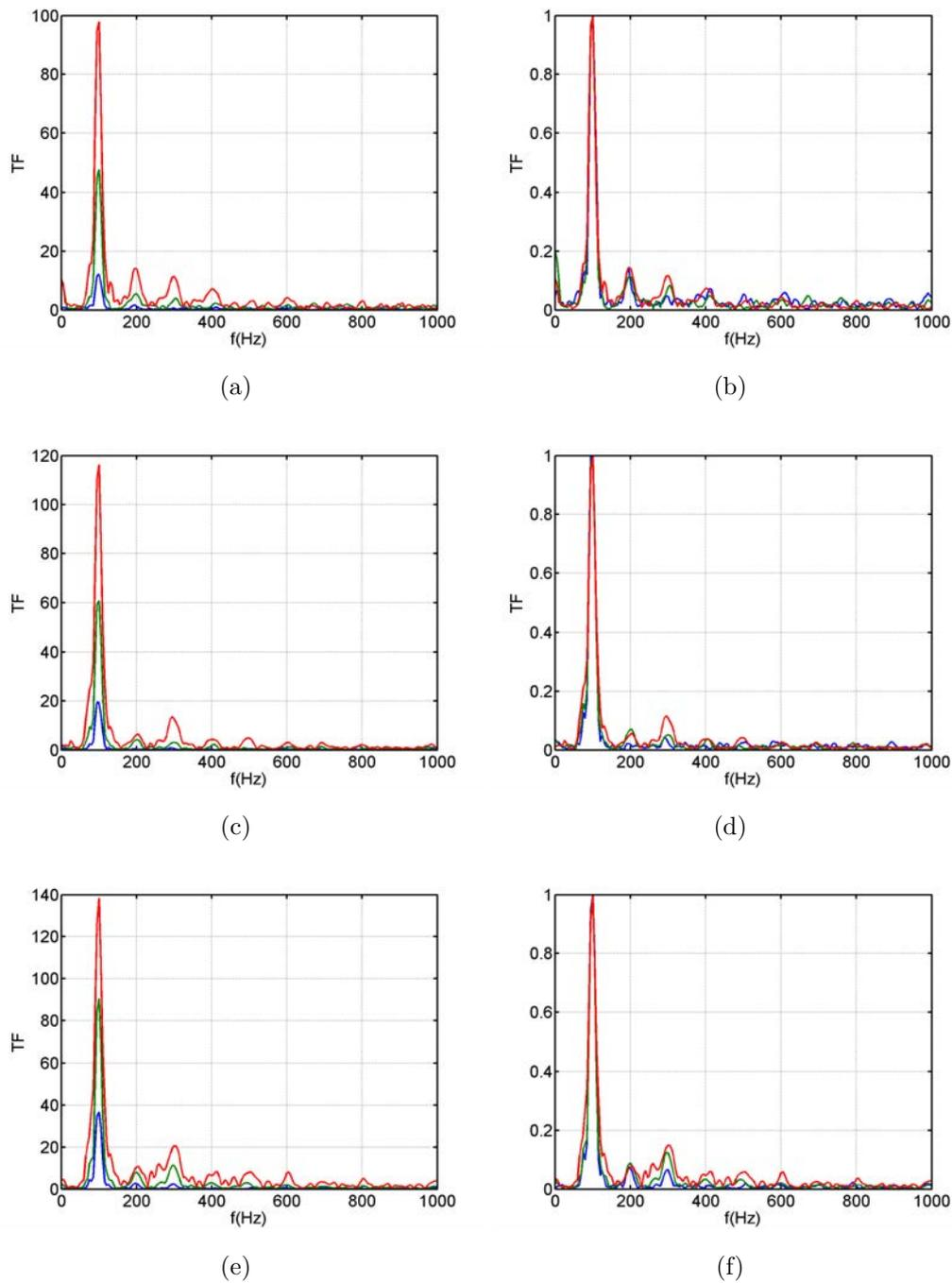
**Figure 5.5.** – Spectres des signaux de vitesse (à gauche) et spectres normalisés par l’amplitude du fondamental (à droite) aux points  $(0.27\text{cm}, 0\text{cm})$  (haut),  $(1.46\text{cm}, 0\text{cm})$  (milieu) et au point focal en énergie (bas) pour les trois amplitudes d’émission  $200\text{mV}$  (bleu),  $500\text{mV}$  (vert) et  $1000\text{mV}$  (rouge).
