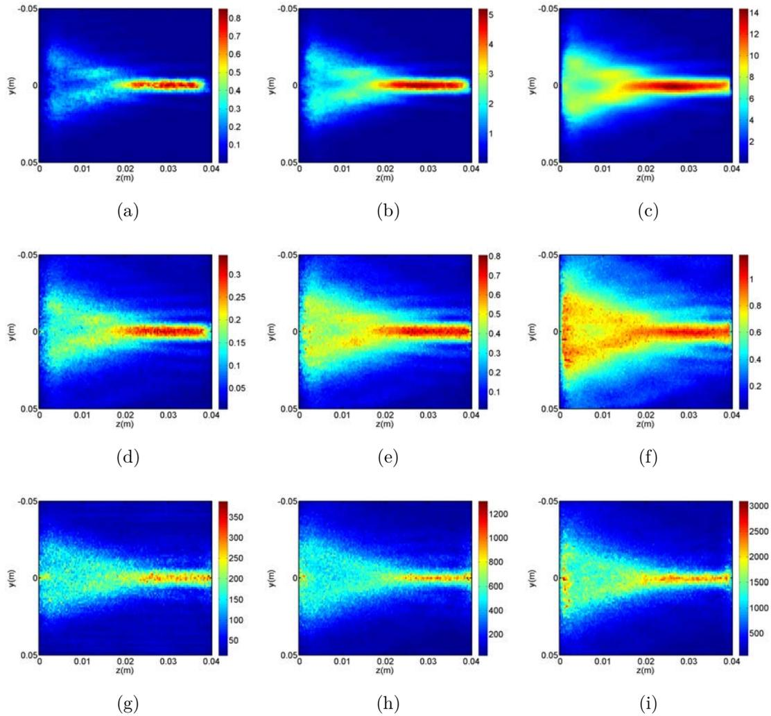
**Figure 5.2.** – Densité volumique d'énergie cinétique en Joule par mètre cube (haut), vitesse maximale en mètre par seconde (milieu) et accélération en mètre par seconde au carré (bas) des ondes en chaque point du domaine de propagation pour les amplitudes d'émission  $200mV$  (gauche),  $500mV$  (milieu) et  $1000mV$  (droite)
