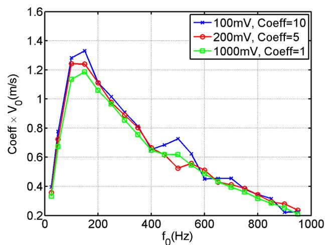
**Figure 4.4.** – Réponse en vitesse du montage formé par le pot vibrant, la plaque et le gel pour des tensions initiales de 100mV (croix bleue), 200mV (carré rouge) et 1000mV (cercle vert) pic à pic. Les réponses sont multipliées par *Coeff* pour être comparées entre elles.
