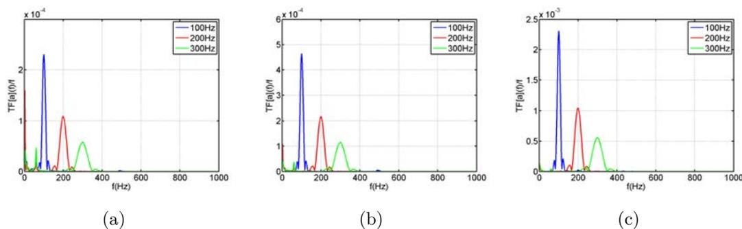
**Figure 4.5.** – Spectres des signaux mesurés à l’accéléromètre pour les fréquences centrales de  $100\text{Hz}$ ,  $200\text{Hz}$  et  $300\text{Hz}$ , et des tensions d’émission de  $100\text{mV}$  (gauche),  $200\text{mV}$  (milieu) et  $1000\text{mV}$  (droite) pic à pic.
