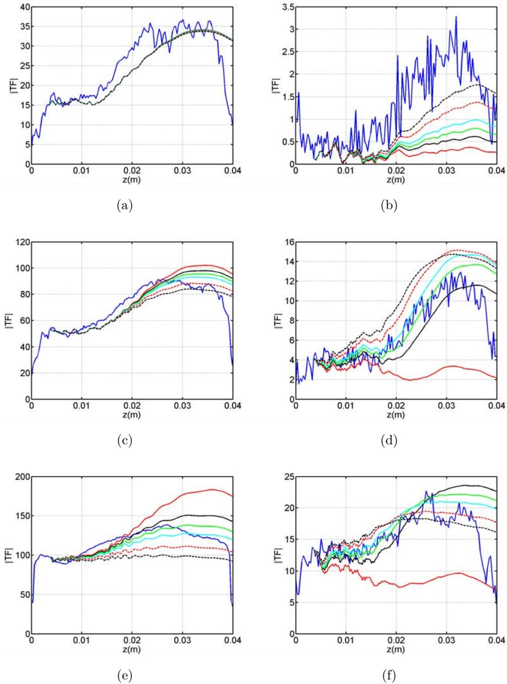
**Figure 5.13.** – Amplitudes du fondamental (gauche) et de l’harmonique 3 (droite) mesurées sur l’axe  $y = 0\text{cm}$  pour les amplitudes d’émission  $200\text{mV}$  (haut),  $500\text{mV}$  (milieu) et  $1000\text{mV}$  (bas). Bleu : mesures expérimentales. Simulations pour différentes valeurs du paramètre non linéaire. Rouge :  $\beta = 0$ . Noir :  $\beta = 0.5$ . Vert :  $\beta = 0.75$ . Cyan :  $\beta = 1$ . Tirets rouge :  $\beta = 1.5$ . Tirets rouge :  $\beta = 2$ .
