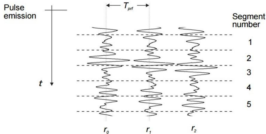
**Figure 4.7.** – Mesure des vitesses de déplacement par corrélation de signaux rétro-diffusés [70]
