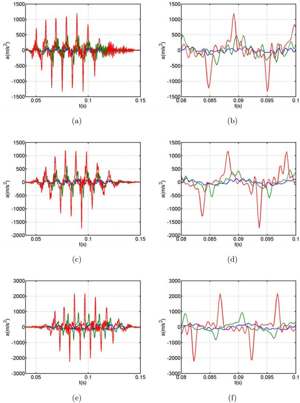
**Figure 5.6.** – Accélération mesurée dans le domaine de propagation aux points  $(0.27\text{cm}, 0\text{cm})$  (haut),  $(1.46\text{cm}, 0\text{cm})$  (milieu) et au point focal en énergie (bas) pour trois amplitudes d'émission  $200\text{mV}$  (bleu),  $500\text{mV}$  (vert) et  $1000\text{mV}$  (rouge) avec le signal complet (gauche) et un zoom sur deux périodes (droite)
