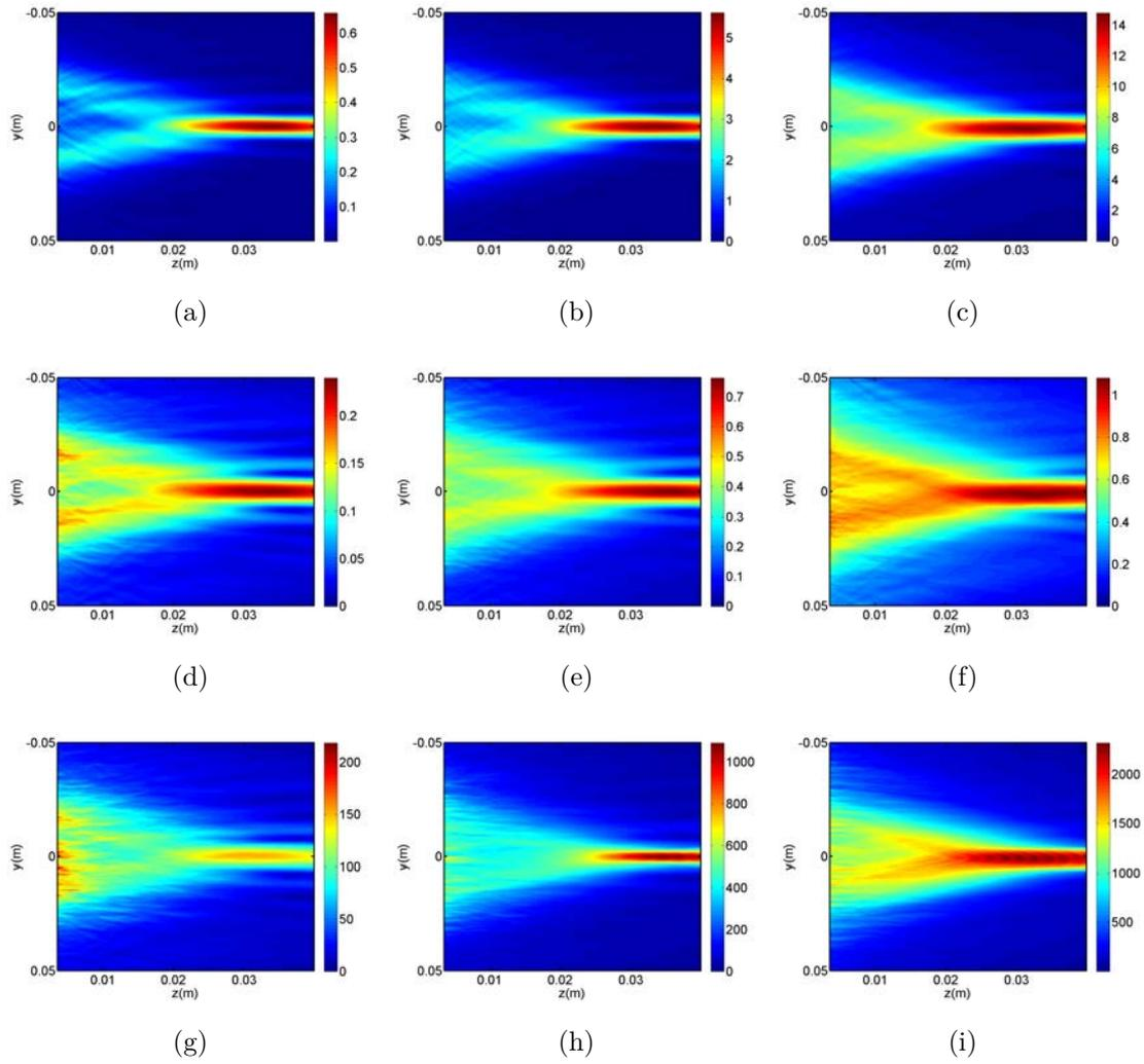
**Figure 5.15.** – Densité volumique d'énergie cinétique en Joule par mètre cube (haut), vitesse maximale en mètre par seconde (milieu) et accélération en mètre par seconde au carré (bas) des ondes en chaque point du domaine de propagation pour les amplitudes d'émission  $200mV$  (gauche),  $500mV$  (milieu) et  $1000mV$  (droite). Simulations avec  $\beta = 0.75$ .
