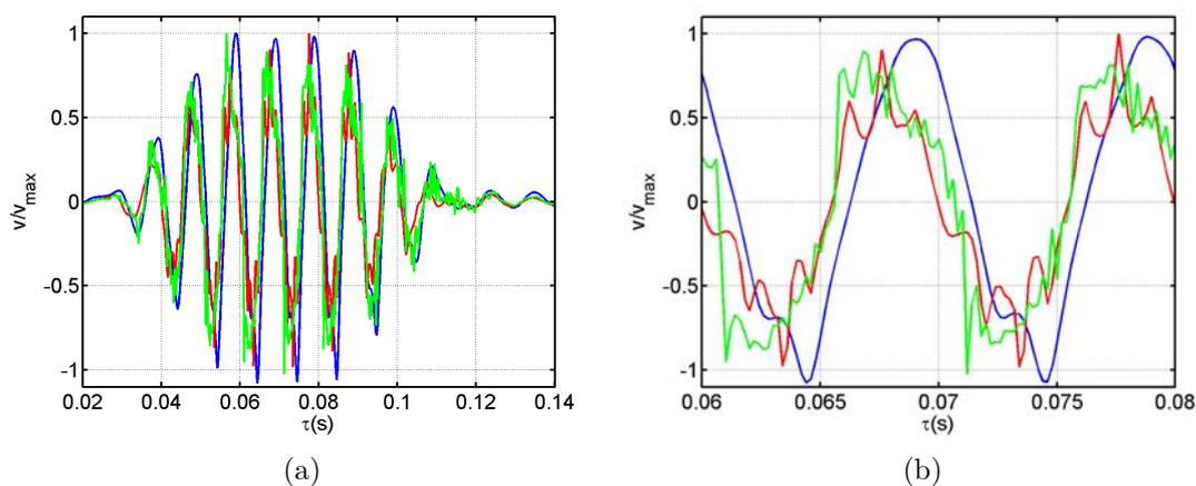
**Figure 4.18.** – Ondes planes mesurées dans la gel à la position  $z = -1cm$  pour une fréquence centrale à  $100Hz$  et des amplitudes de  $100mV$  (bleu),  $200mV$  (rouge) et  $1000mV$  (vert) pic à pic. A gauche : signal complet. A droite : zoom sur 2 périodes.
