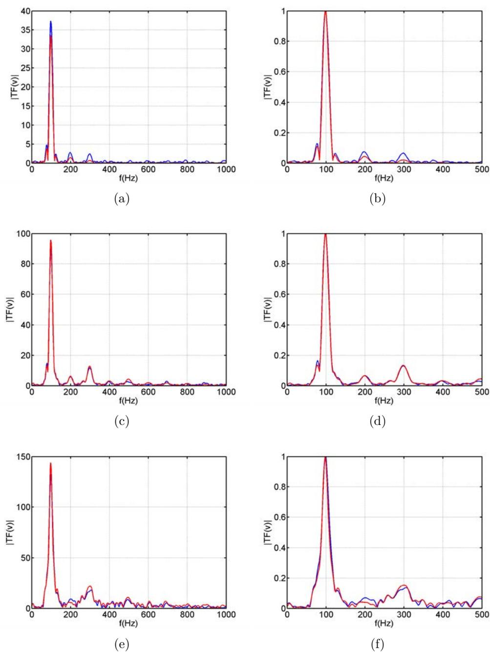
**Figure 5.17.** – Comparaison des spectres de vitesse (à gauche) et des spectres normalisés par l’amplitude du fondamental (à droite), pour les amplitudes d’émission  $200mV$  (haut),  $500mV$  (milieu) et  $1000mV$  (bas), des ondes mesurées (en bleu) dans le gel avec celles issues des simulations à la position  $z = 3cm$  et  $y = 0cm$  pour le coefficient non linéaire  $\beta = 0.75$  (en rouge).
