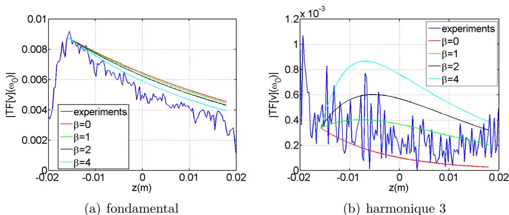
**Figure 4.19.** – Comparaison entre l’amplitude du fondamental pour les expériences à  $150\text{Hz}$  (ligne bleue) et les simulations avec  $\beta = 1$  (ligne rouge),  $\beta = 2$  (ligne verte),  $\beta = 3$  (ligne noire) et  $\beta = 4$  (ligne cyan).
