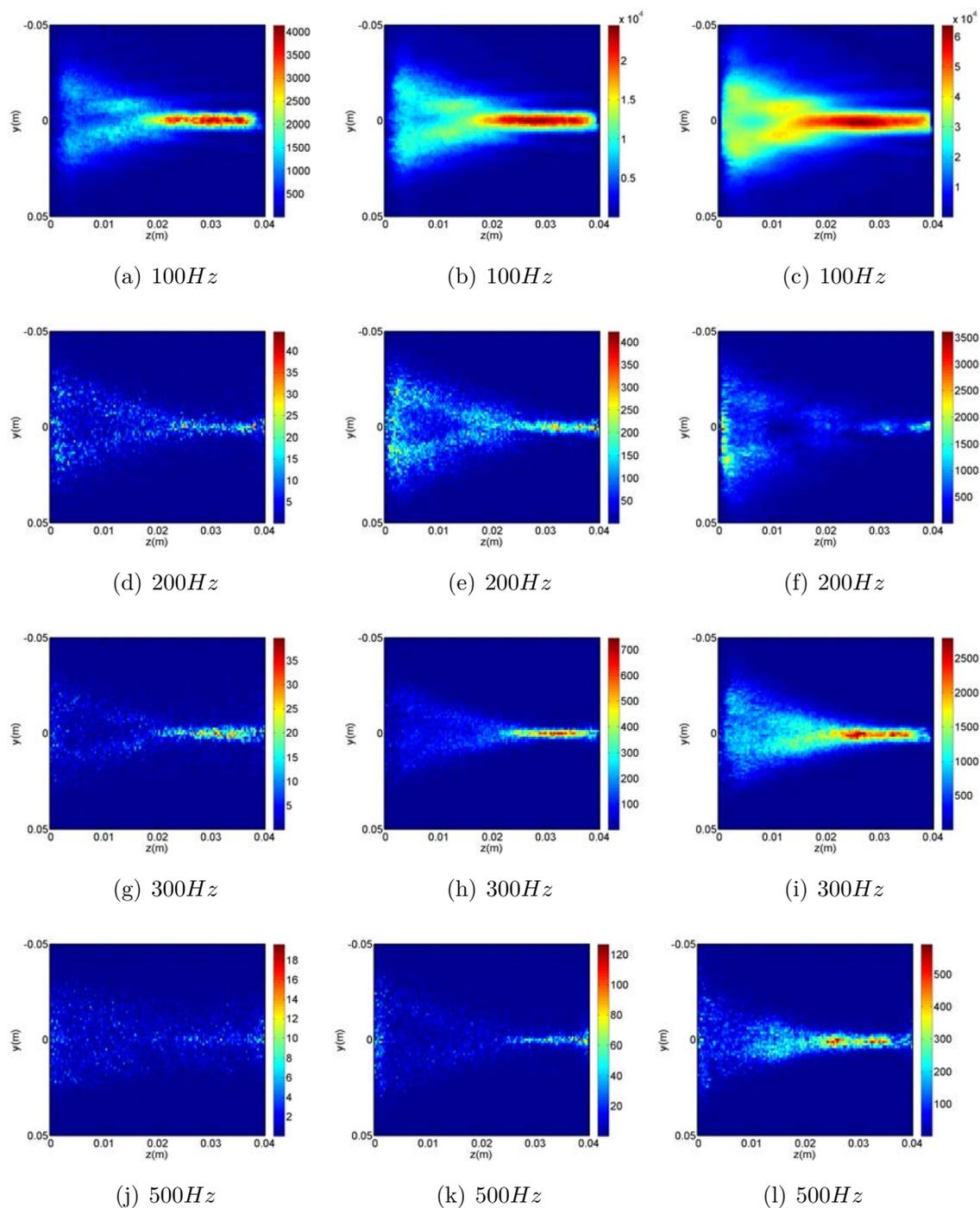
**Figure 5.7.** – Energie des harmoniques  $100Hz$ ,  $200Hz$ ,  $300Hz$  et  $500Hz$  (de haut en bas) pour les trois amplitudes  $200mV$  (gauche),  $500mV$  (milieu) et  $1000mV$  (droite) d'émission.
