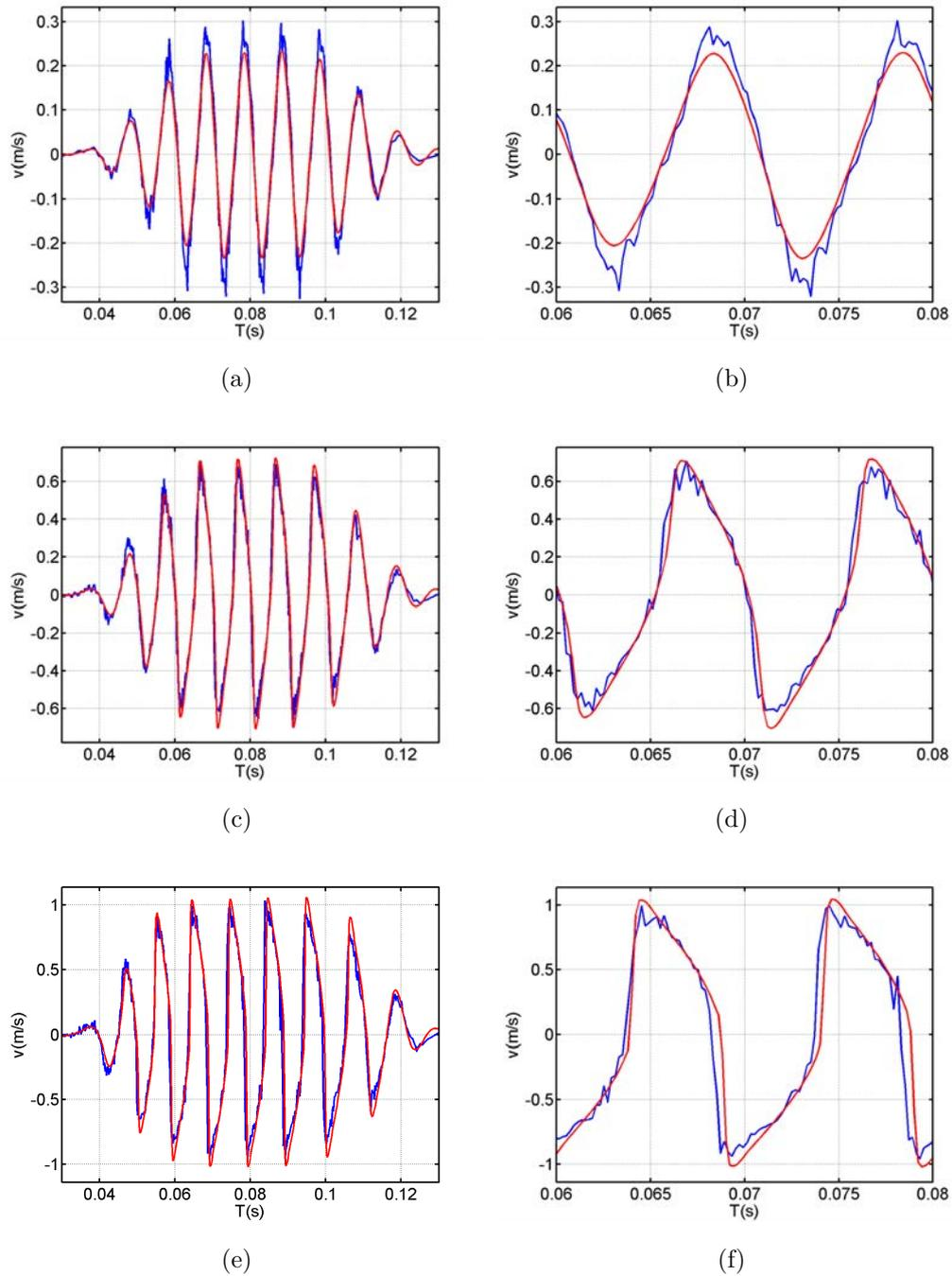
**Figure 5.16.** – Comparaison des vitesses mesurées dans le gel (bleu), pour les amplitudes d’émission  $200\text{mV}$  (haut),  $500\text{mV}$  (milieu) et  $1000\text{mV}$  (bas), avec celles issues des simulations à la position  $z = 3\text{cm}$  et  $y = 0\text{cm}$  pour le coefficient non linéaire  $\beta = 0.75$  (rouge).
