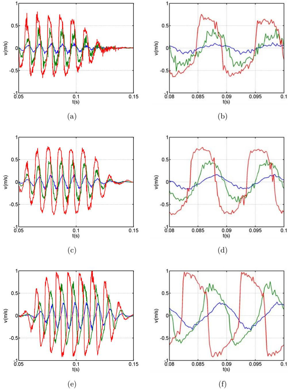
**Figure 5.4.** – Vitesse mesurée dans le domaine de propagation aux points  $(0.27\text{cm}, 0\text{cm})$  (haut),  $(1.46\text{cm}, 0\text{cm})$  (milieu) et au point focal en énergie (bas) pour trois amplitudes d'émission  $200\text{mV}$  (bleu),  $500\text{mV}$  (vert) et  $1000\text{mV}$  (rouge) avec le signal complet (gauche) et un zoom sur deux périodes (droite)
