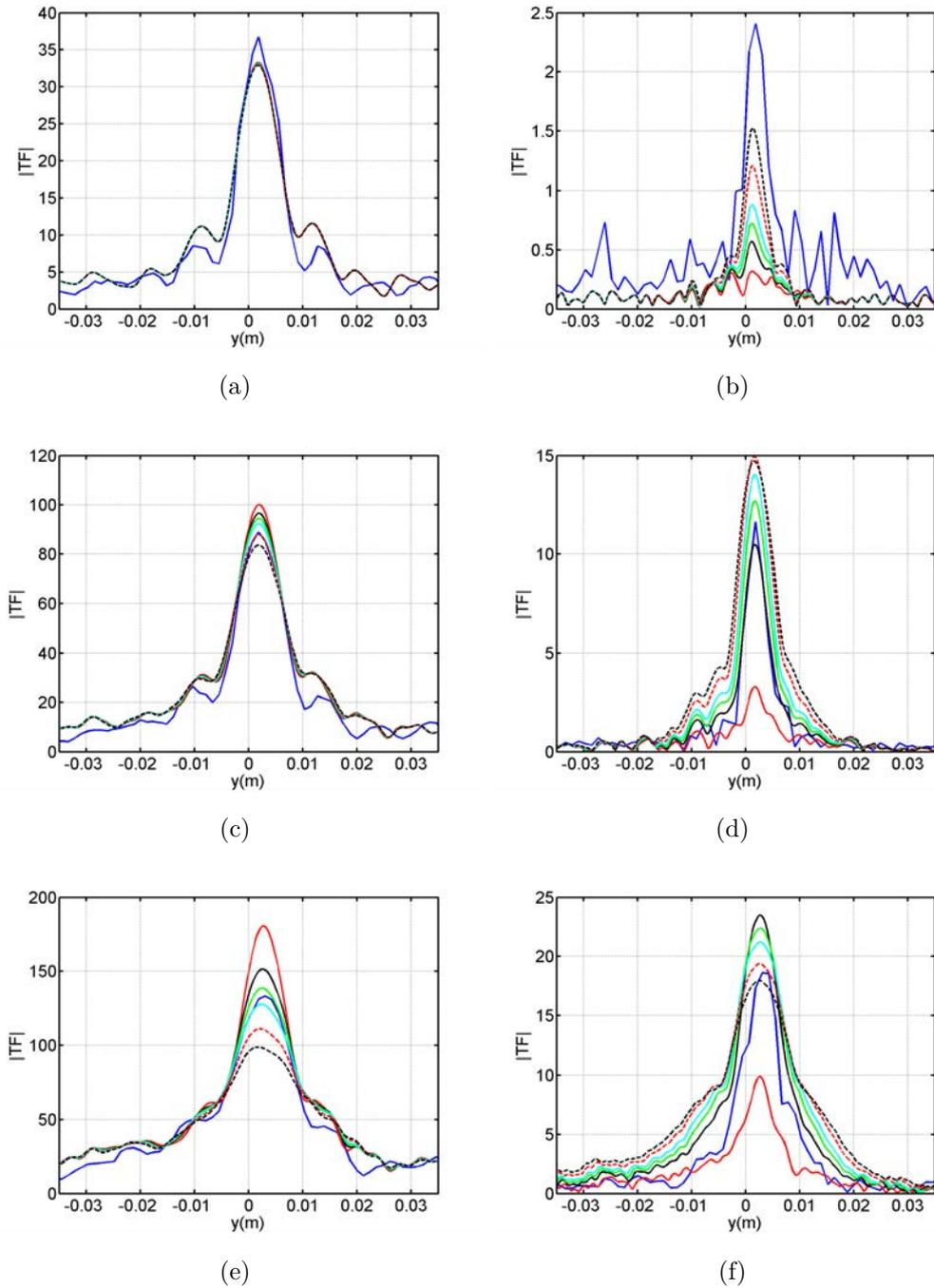
**Figure 5.14.** – Amplitudes du fondamental (gauche) et de l’harmonique 3 (droite) sur l’axe  $z = 3cm$  pour les amplitudes d’émission  $200mV$  (haut),  $500mV$  (milieu) et  $1000mV$  (bas). Bleu : mesures expérimentales. Simulations pour différentes valeurs du paramètre non linéaire. Rouge :  $\beta = 0$ . Noir :  $\beta = 0.5$ . Vert :  $\beta = 0.75$ . Cyan :  $\beta = 1$ . Tirets rouge :  $\beta = 1.5$ . Tirets rouge :  $\beta = 2$ .
