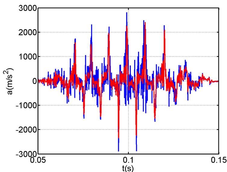
**Figure 5.3.** – Accélérations calculées avec (ligne rouge) et sans (ligne bleue) filtre à  $1000Hz$  à la position  $z = 1cm$  et  $y = 0cm$  pour une excitation de  $1000mV$  pic à pic.
