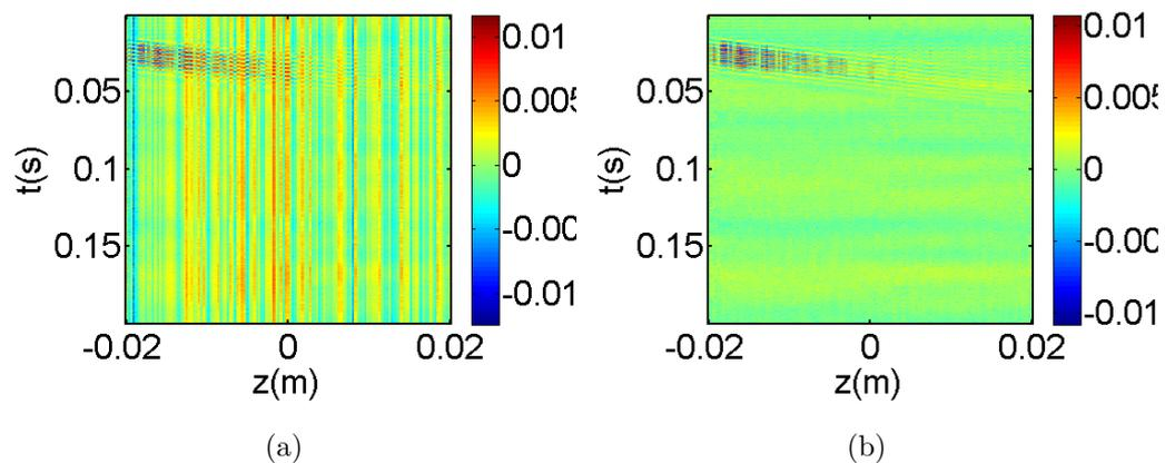
Figure 4.12. – Vitesse particulaire (code couleur en  $m/s$ ) d'une onde plane à la fréquence  $f = 400 Hz$  mesurée dans le gel (à gauche). La moyenne temporelle du signal à chaque position  $z$  a été soustraite (à droite).
