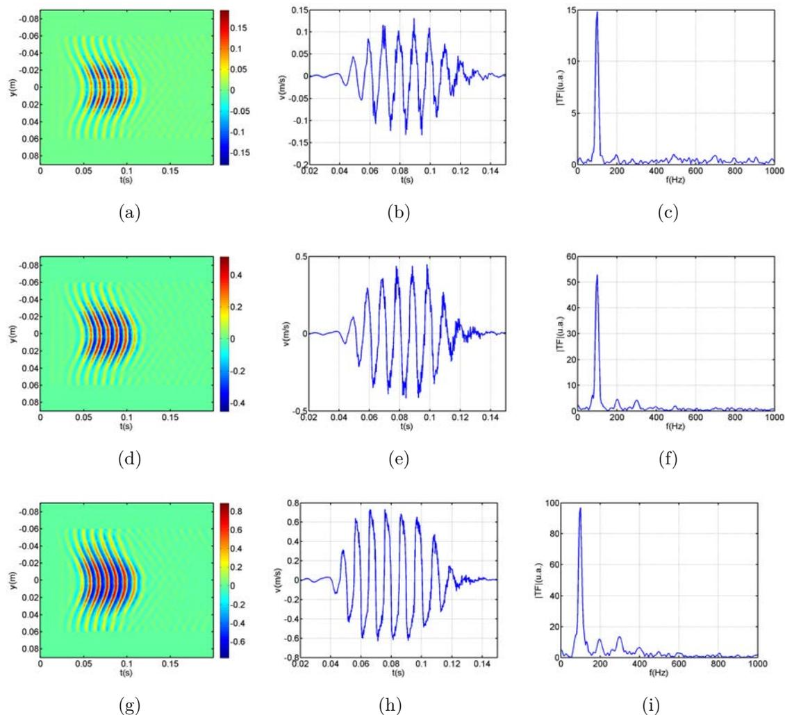
**Figure 5.8.** – Champs de vitesse mesurés et interpolés dans le plan initial de la simulation numérique. De haut en bas, excitation à 200, 500 et 1000mV. A gauche : champ de vitesse (B-scan) en niveaux de couleur (m/s) en fonction du temps et de la position  $y$ . Au centre : signaux temporels sur l'axe  $y = 0$ . A droite : spectres des signaux sur l'axe.
