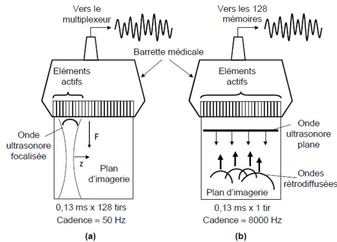
**Figure 4.6.** – Schéma des méthodes [68] d'imagerie classique (a) et d'imagerie ultra-rapide (b)
