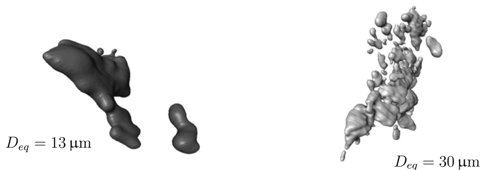
(e) Visualisation 3D de deux particules Al-Cu-Fe-Mn à partir d'images de tomographie haute-résolution (alliage 2050-T8)
