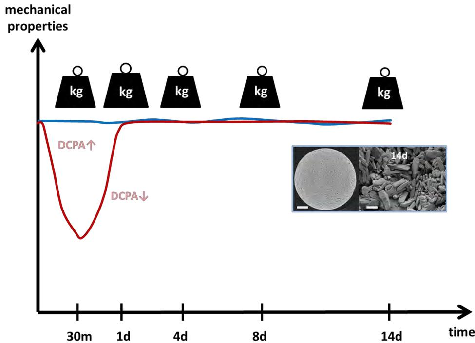
Figure 3: Représentation schématique des principaux changements observés après immersion des échantillons de DCPD dans le TRISs. Les petits poids représentent la masse des échantillons
