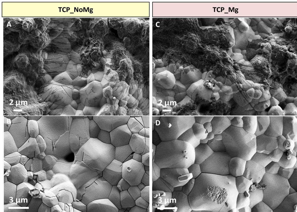
Figure 8: Micrographies électroniques (MEB) des échantillons de  $\beta$ -TCP pur (A-B) et dopé (C-D) avant (A-C) et après (B-D) avoir enlevé les es cellules ostéoclastiques (cultivées sur les échantillons pendant 4 jours)
