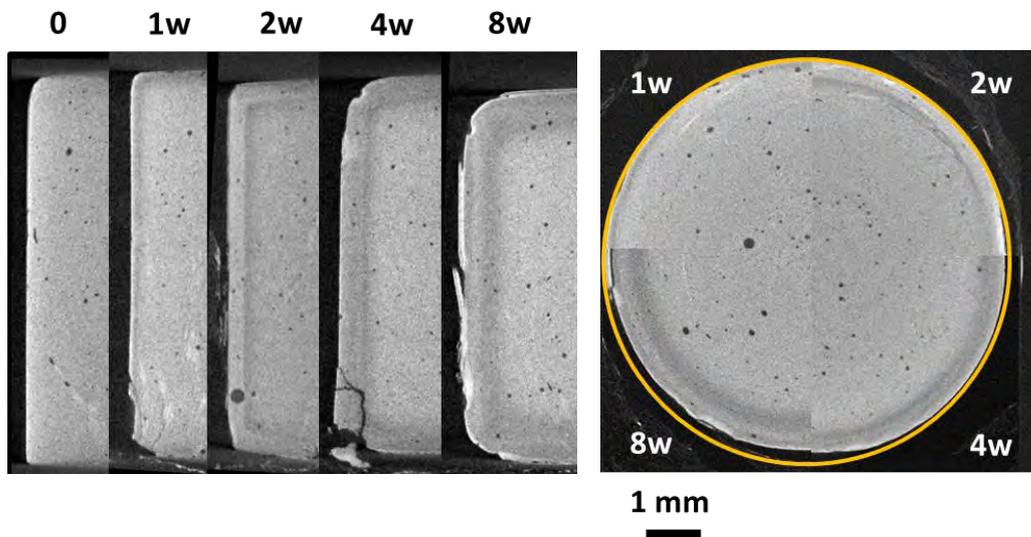
Figure 5: Images  $\mu$ -CT frontales (à gauche) et transverse (à droite) des échantillons de  $\beta$ -TCP après différents temps d'immersion dans le TRISd. Le cercle jaune (section transverse) représente la circonférence d'un échantillon à temps zéro
