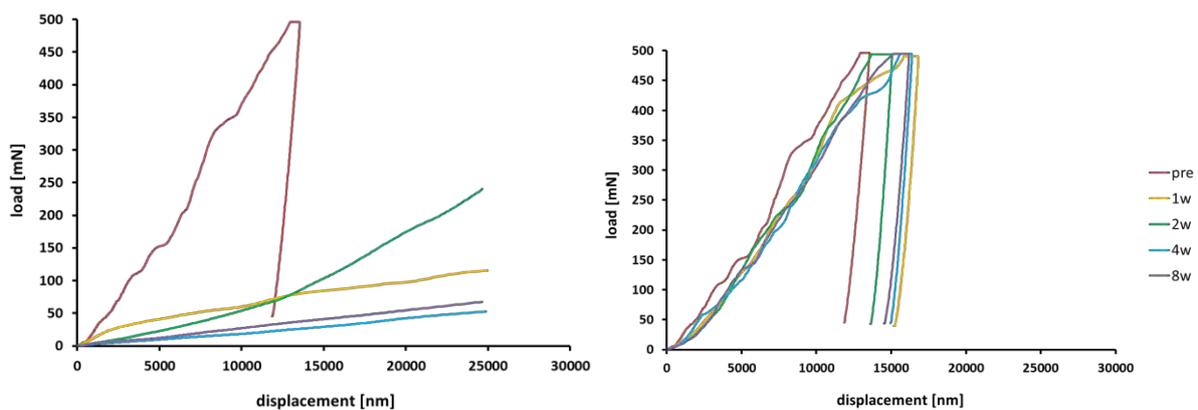
Figure 7: Exemple de courbes charge-déplacement représentatives obtenues pendant les tests d'indentation à la surface (à gauche) et à cœur (à droite) des échantillons de  $\beta$ -TCP immergés dans le TRISd.
