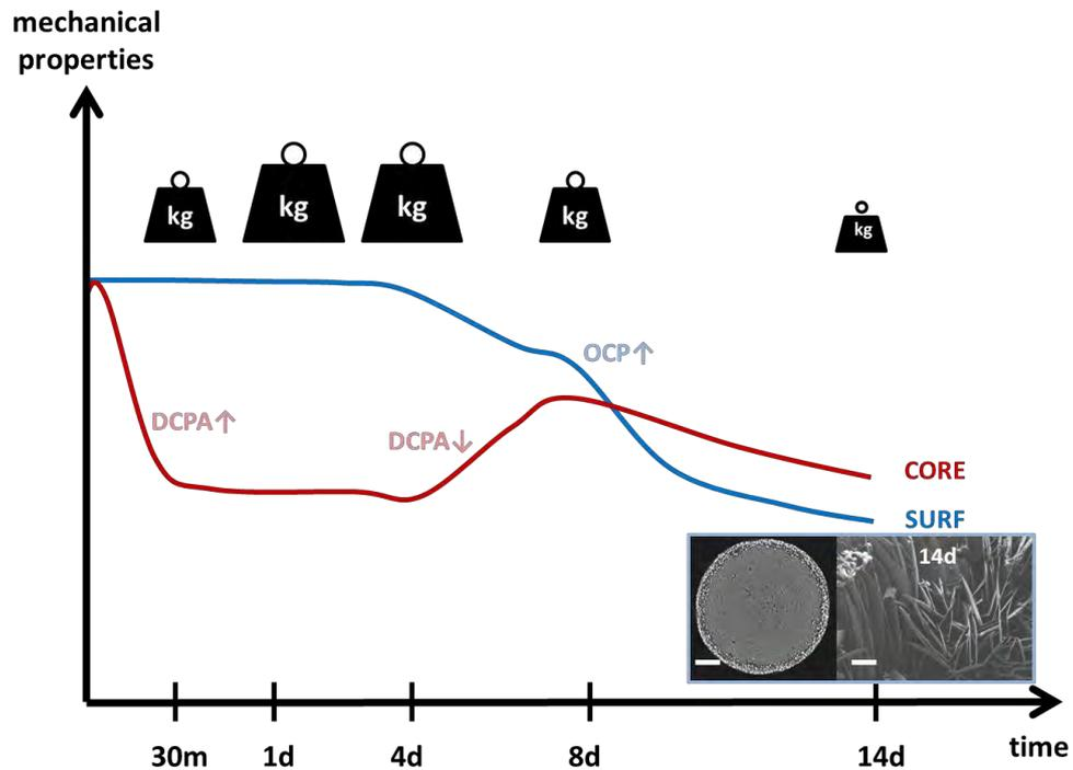
Figure 1: Représentation schématique des principaux changements observés après immersion des échantillons de DCPD dans du PBSd. Les petits poids représentent la masse des échantillons. Barre d'échelle de 1 mm et 5 μm pour les images μ-CT et MEB respectivement
