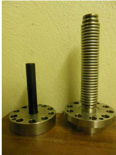
FIGURE 3.9 – Photographie des soufflets élastomère (à gauche) et métallique (à droite).
