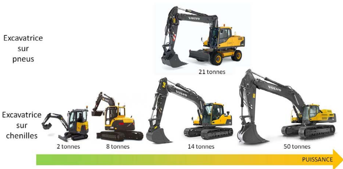
Figure 3.12 – Différentes catégories d'excavatrices gamme Volvo Construction Equipment entre 2 tonnes et 50 tonnes
