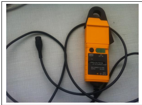
Figure II.1 : Pince ampèremétrique utilisée en laboratoire
