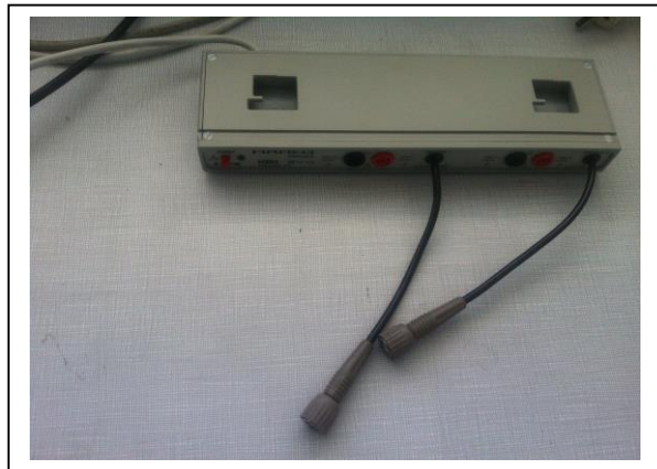
Figure II.2 : Sonde différentielle utilisée en laboratoire
