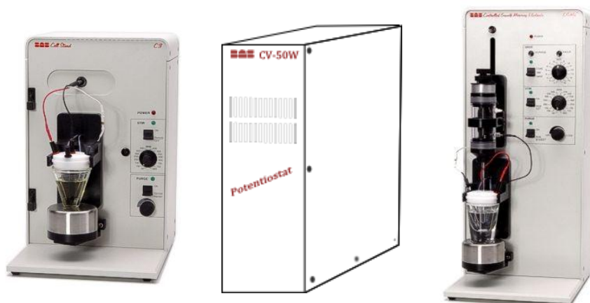
Figura 3.1. Aparato experimental utilizado para medidas voltamétricas. Esquerda: célula C3 para análises com eletrodo de trabalho sólido de carbono vítreo GCE. Direita: célula CGME para análises de voltametria com eletrodo de trabalho de mercúrio gota pendente HDME. Centro: representação do potenciostato utilizado para controlar as células voltamétricas e a eletrólise por coulometria a potencial controlado.
