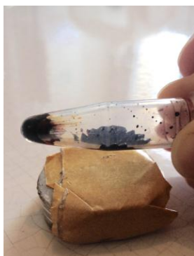
Figura 3.7. Ferrofluido em DMSO após ultracentrifugação e sua redispersão com o auxílio de banho ultrassom. A formação de picos é também uma forma de identificar que o coloide está altamente concentrado.
