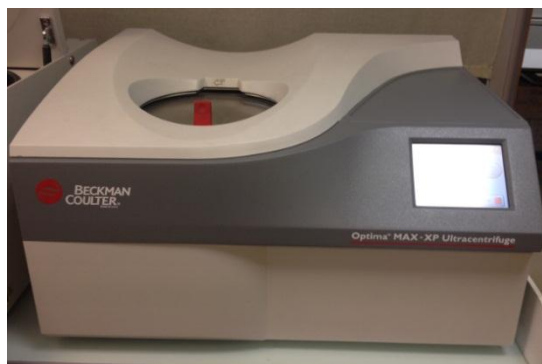
Figura 3.6. Ultracentrífuga utilizada para a separação de NPs em amostras de ferrofluido aquoso e em DMSO.
