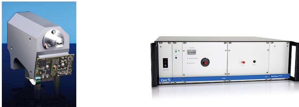
FIGURE 3.14 – Spectrophotomètre à barrette linéaire de photodiodes fabriqué par la Société TEC5. À gauche : le système opto-électronique incorporant un spectromètre ZEISS. À droite : le rack de mesure complet.
