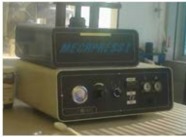
Machine d'enrobage à chaud
