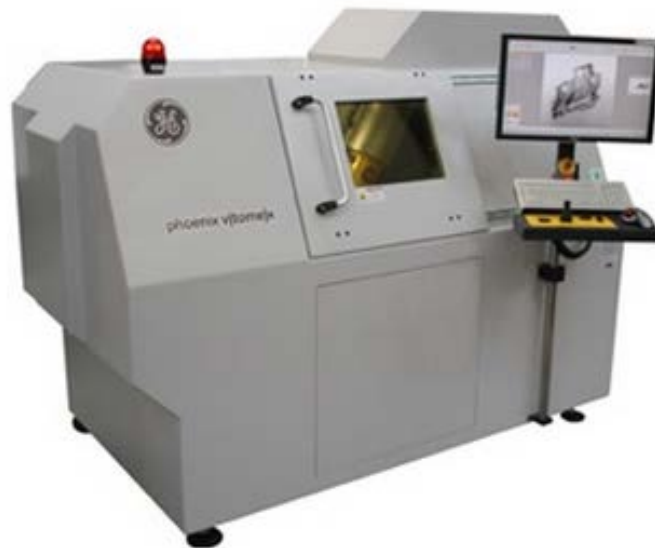
FIGURE B.11 – Phoenix v—tome—x s (modèle GE) utilisé pour la tomographie.
