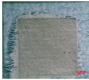
Figure IV. 6 : Vue de dessus au microscope optique d'une impression monolithique de mauvaise qualité du PEDOT :PSS sur la couche de BMITFSI. 80 % vernis UV déposée sur Ag/SP3
