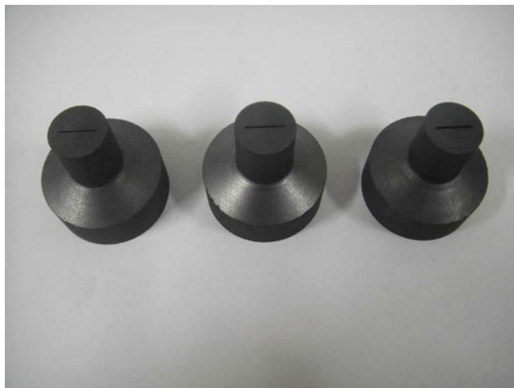
FIGURE 7.15 – Buses en fente en carbone vitreux de 1cm de long et 100, 300 et 500 \mu\text{m} de large de gauche à droite sur la photo.
