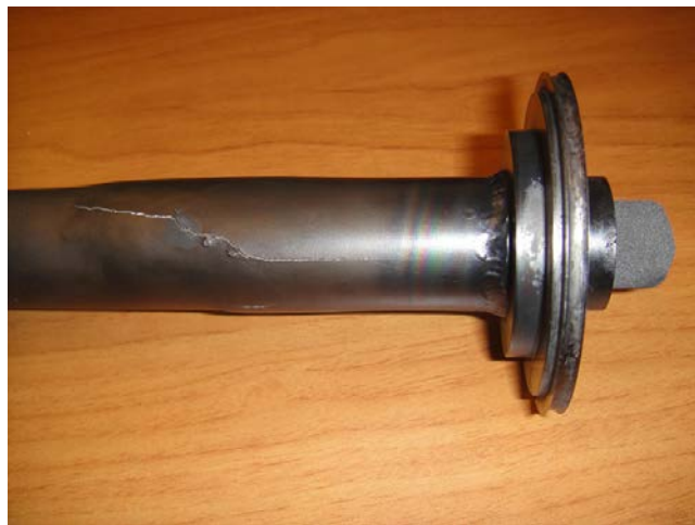
FIGURE 4.3 – Chemise de protection en tantale gonflée et fissurée sous l'action de la température et de la pression.
