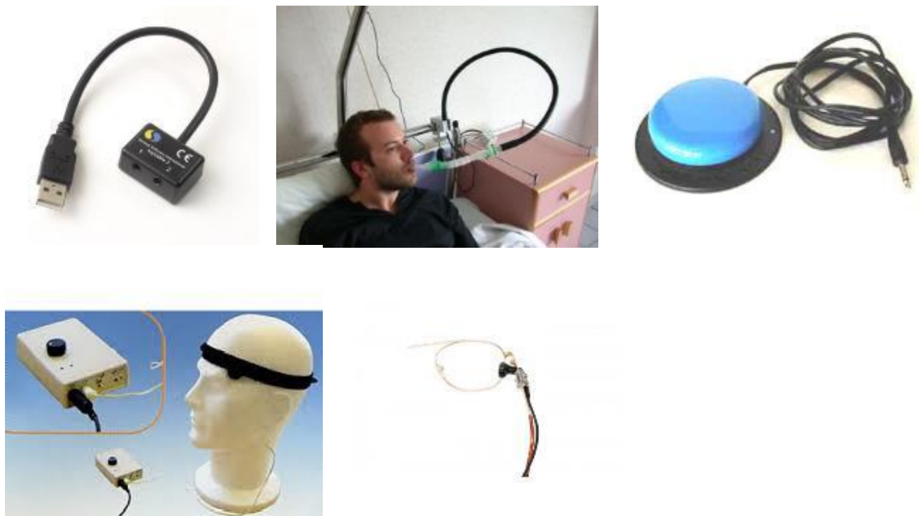
FIGURE 6 : CONTACTEURS [DE GAUCHE A DROITE. HAUT : EMULATEUR DE SOURIS, CONTACTEUR AU SOUFFLE, CONTACTEUR MECANIQUE. BAS : CONTACTEUR MUSCULAIRE, CONTACTEUR INFRAROUGE]
