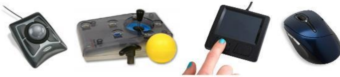
FIGURE 4 : DISPOSITIFS DE POINTAGE [DE GAUCHE A DROITE : TRACKBALL, JOYSTICK, TOUCHPAD, SOURIS STANDARD]
