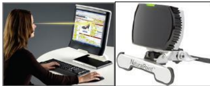
FIGURE 2 : DISPOSITIFS DE POINTAGE [A GAUCHE, POINTAGE A L'ŒIL ; A DROITE, POINTAGE A LA TETE]
