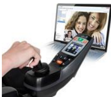
FIGURE 10 : SYSTEME IPORTAL (DYNAMICS CONTROL) PERMETTANT LE CONTROLE DE L'IPHONE, IPAD A PARTIR DU JOYSTICK DU FAUTEUIL ROULANT ELECTRIQUE
