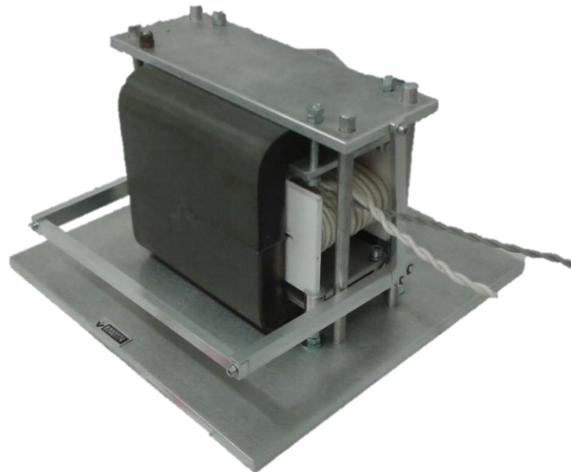
Figure 16: Cadre « Single Sheet Tester ».
