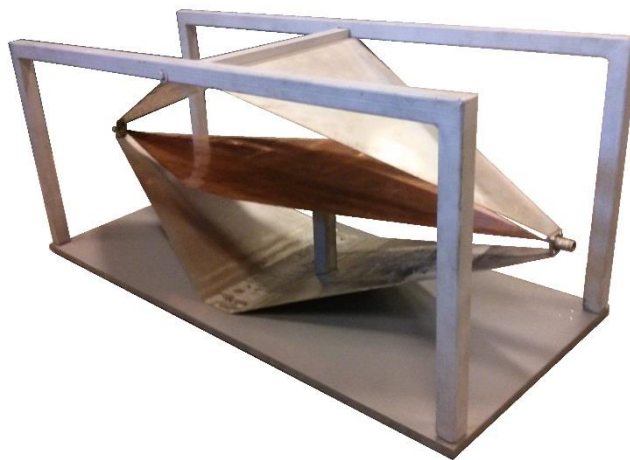
Figure 45: Photo de la cellule TEM ouverte.
