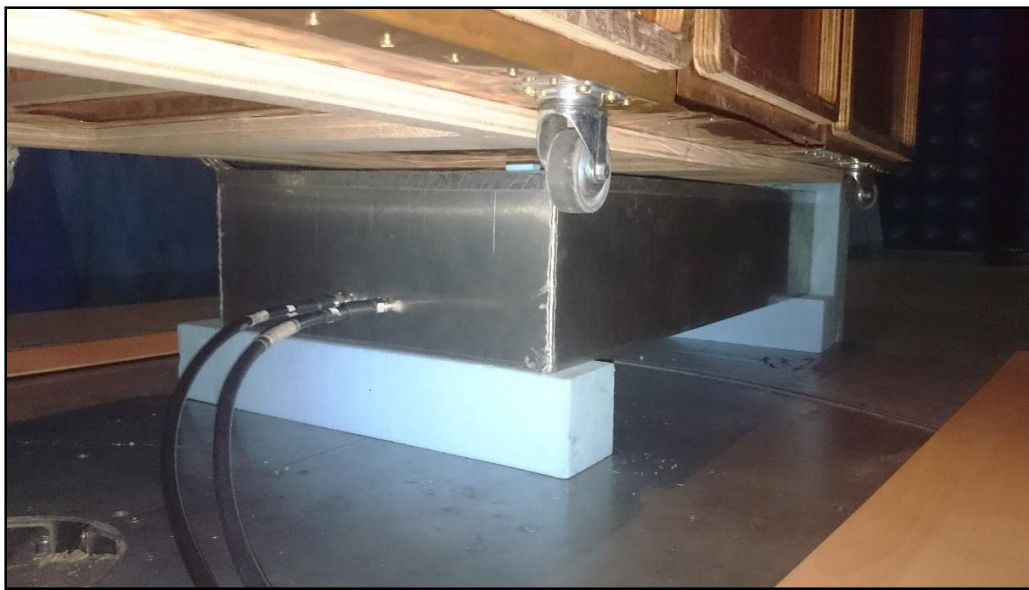
Figure 111: Photo de la maquette de pack-batterie connectée à l'ARV par un port différentiel logique.
