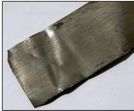
Figure 136: Exemple de ruban de Permalloy [87].
