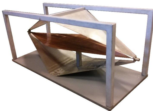
Figure 45: Photo de la cellule TEM ouverte.
