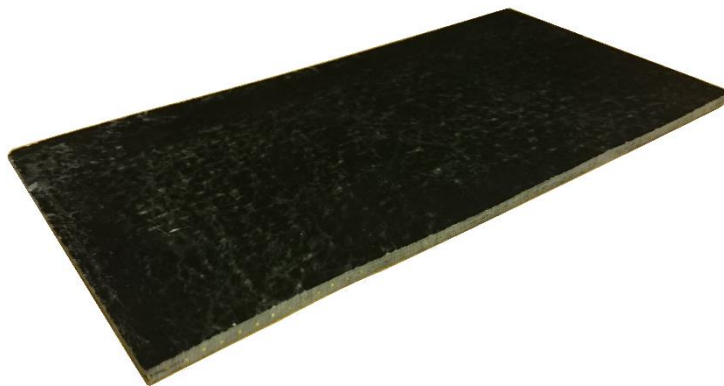
Figure 137: Exemple de composite à grillage métallique.
