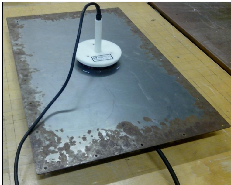
Figure 34: Photo de la mesure de SE en champ H proche sur une plaque d'acier (2mm).
