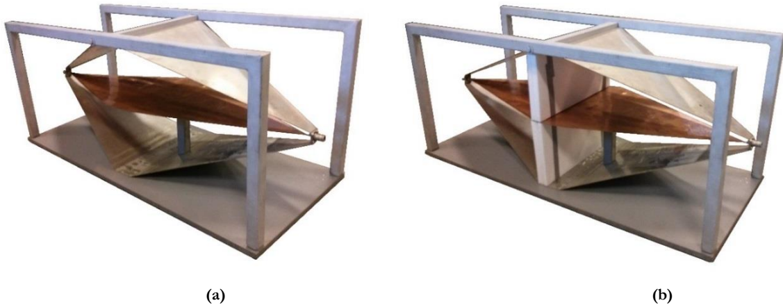
Figure 57: Cellule TEM. (a) Sans échantillon. (b) Avec échantillon.
