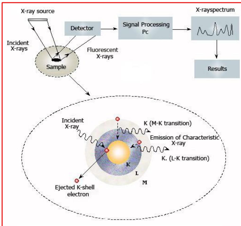
**Figure 2.1:** Principe et principaux composants de la spectroscopie par fluorescence X ([http://omega.physics.uoi.gr/Xrf/english/the\\_Xrf\\_technique](http://omega.physics.uoi.gr/Xrf/english/the_Xrf_technique), 2010).
