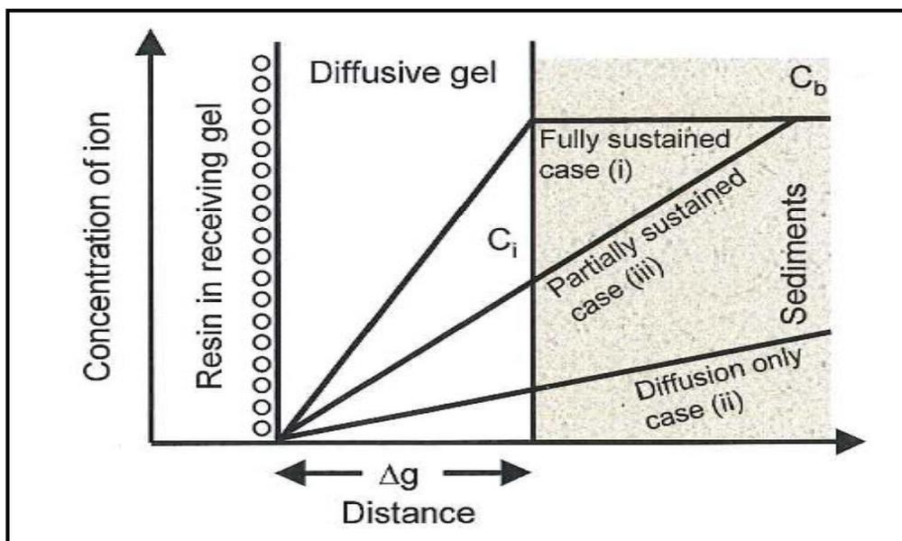
**Figure 1.5:** Représentation schématique du gradient de concentration dans un DGT en contact avec l'eau interstitielle dans le cas où le relargage de la phase solide est rapide (i), lente (iii) et inexistante (ii) (d'après Zhang et al. (1995)).
