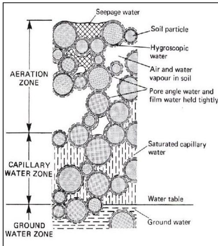
**Figure 1.3:** Représentation schématisée des états de l'eau interstitielle du sol et leurs définitions (Shaw, 1993).
