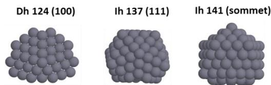
Figure 4.12: Structures des nanoparticules d'argent tronquées : sur la facette (100) (décaèdre 124), sur la facette (111) (icosaèdre 137) et sur le sommet (icosaèdre 141)
