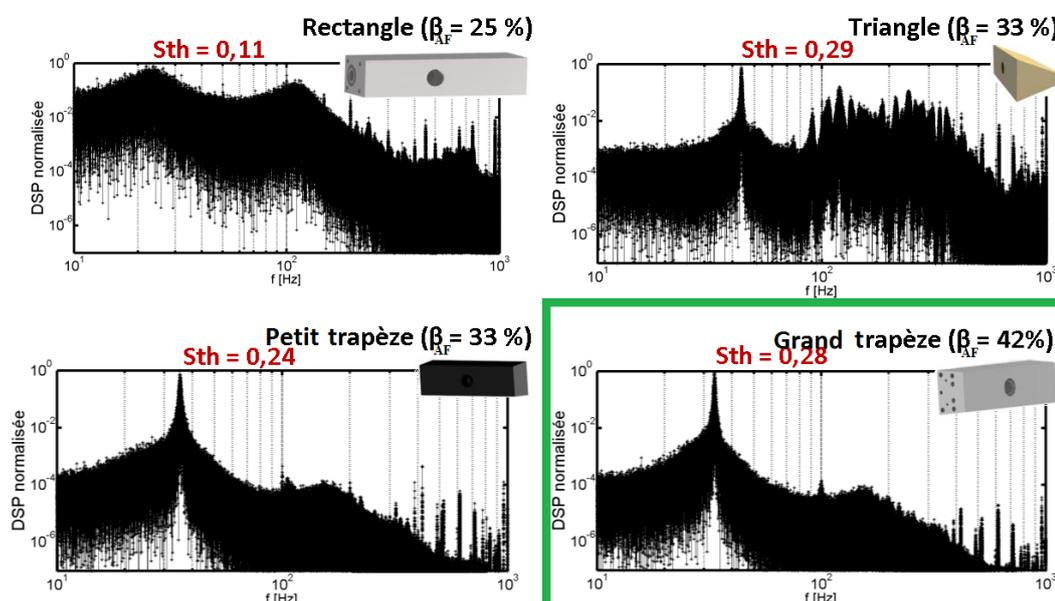
**Figure 5.7** – Densités spectrales de puissance normalisées par l’amplitude maximale, obtenues à partir du signal de pression différentielle  $\Delta P$  pour différentes géométries d’accroche-flammes - **Cadre vert** : accroche-flamme trapezoïdal retenu pour la suite de ce travail (cf. annexe  $\Delta P = f(t)$  correspondant, [figure B.1](#)) - *Point de référence*
