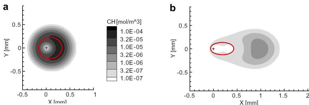
**Figure 4.5** – Simulations de la combustion de gouttes de *n*-heptane (40 µm). La concentration du radical CH est représentative de l'intensité de la zone de réaction. Vitesse d'écoulement d'air : (a)  $U_g^\infty = 2$  m/s, (b)  $U_g^\infty = 12$  m/s. — : proportions stœchiométriques,  $\phi_{loc} = 1$  (extrait de [19])
