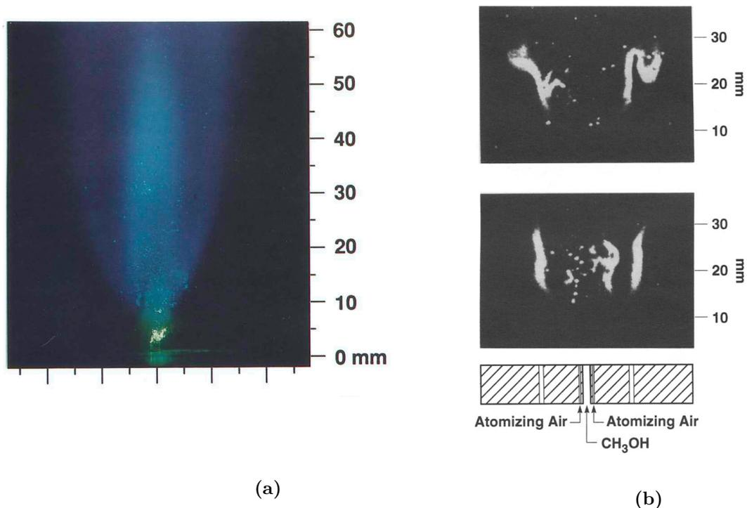
**Figure 4.11** – Étude d’une flamme de diffusion turbulente se développant autour d’un jet liquide de méthanol. **(a)** Visualisation de diffusion de Mie des gouttes - la couleur verte correspond à la phase liquide éclairée par le laser, la couleur bleue correspond à l’émission de lumière visible de la flamme **(b)** Deux images instantanées de PLIF-OH, révélant la structure complexe de la flamme diphasique, extrait de [74]
