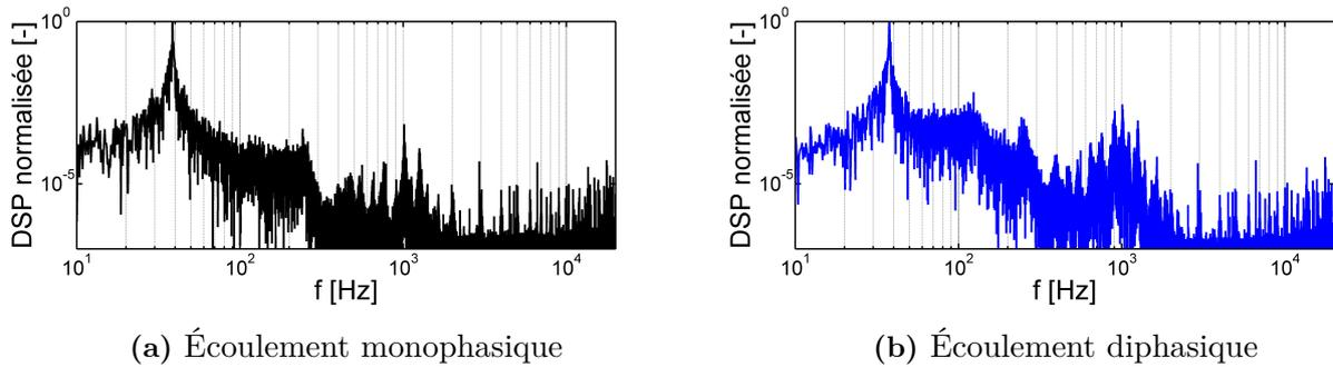
**Figure 8.1** – Densités spectrales de puissance obtenues à partir des signaux temporels de pression  $\Delta P$  (cf. annexe, [figures B.2](#) et [B.3](#))- Repère log-log - *Point de fonctionnement nominal, non-réactif*
