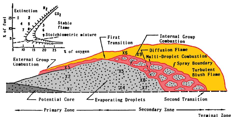
Figure 4.7 – Vue en coupe hypothétique d'un spray non-prémélangé en conditions réactives. La vue illustre les différents régimes de combustion possibles. [Annamalai et al. \(1992\)](#) [7]
