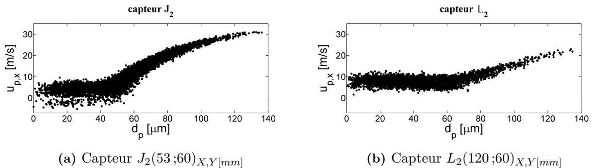
**Figure 13.3** – Nuage de points caractérisant les corrélations diamètre/vitesse longitudinale des gouttes aux capteur  $J_2$  et  $L_2$  - Données obtenues par simulation CHARME-SPARTE - *Point de fonctionnement nominal*
