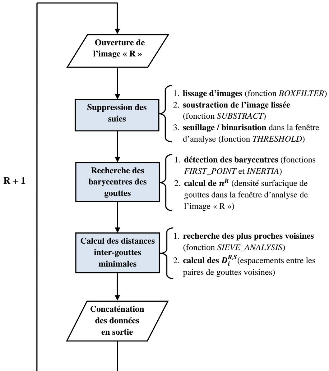
**Figure 10.2** – Algorithme de traitement d'images des visualisations tomographiques afin de mesurer les distances inter-gouttes. L'analyse est réalisée à l'aide du logiciel Visilog
