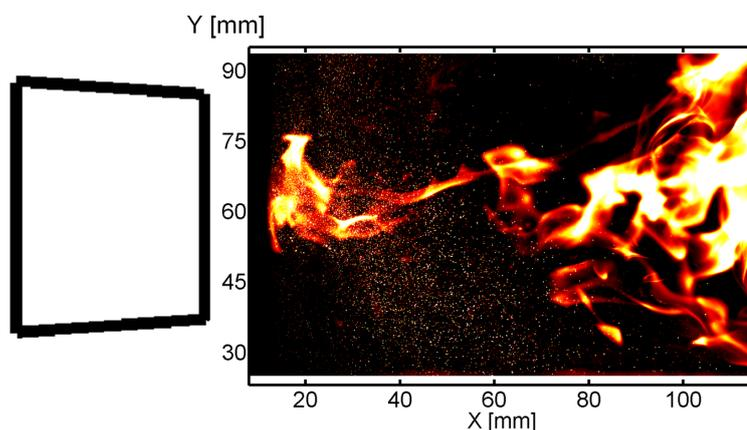
**Figure 9.2** – Visualisation tomographique instantanée du brouillard de gouttes mettant en évidence l'incandescence des suies dans le domaine visible - Utilisation de fausses couleurs - *Point de fonctionnement nominal, réactif*
