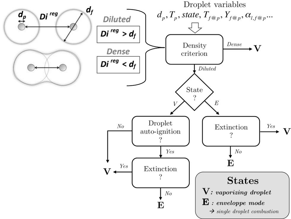
**Figure 14.3** – Algorithme du modèle multi-état de combustion de gouttes (MuStARD) - mode **V** : goutte en évaporation « pure », mode **E** : goutte isolée qui brûle avec une flamme enveloppe,  $d_p$  : diamètre des gouttes,  $d_f$  : diamètre de flamme enveloppe d'une goutte isolée,  $D_i^{reg}$  : espacement entre gouttes voisines avec l'hypothèse de distribution régulière ( $\bar{n}_l^{-1/3}$ ) - Adapté de [132]
