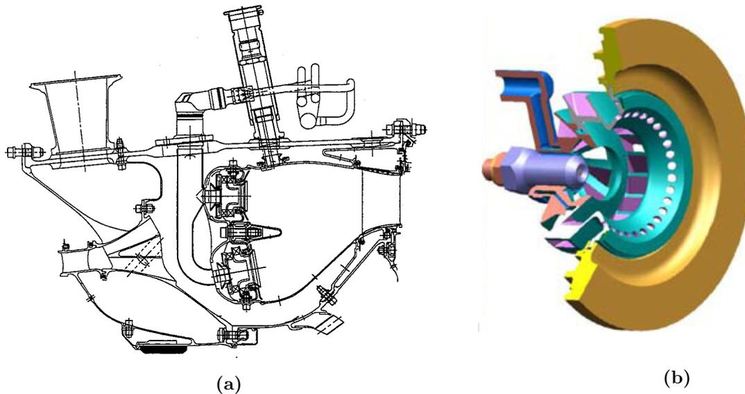
**Figure 2.9** – (a) Plan d’une chambre de combustion annulaire à deux étages (moteur CFM56) [119]
