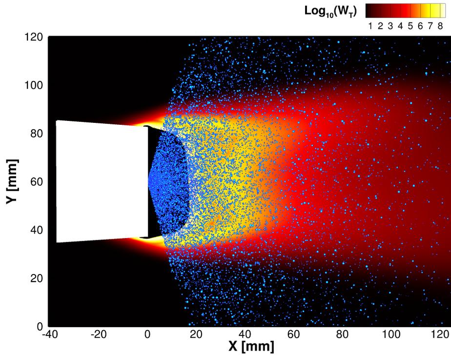
**Figure 13.5** – Champ instantané du taux de dégagement [ $\text{W}/\text{m}^3$ ] (échelle logarithmique de base 10) superposé avec la position des gouttes. Gouttes dilatées pour être bien visibles (facteur 7) - calcul CHARME-SPARTE - *Point de fonctionnement nominal, réactif*
