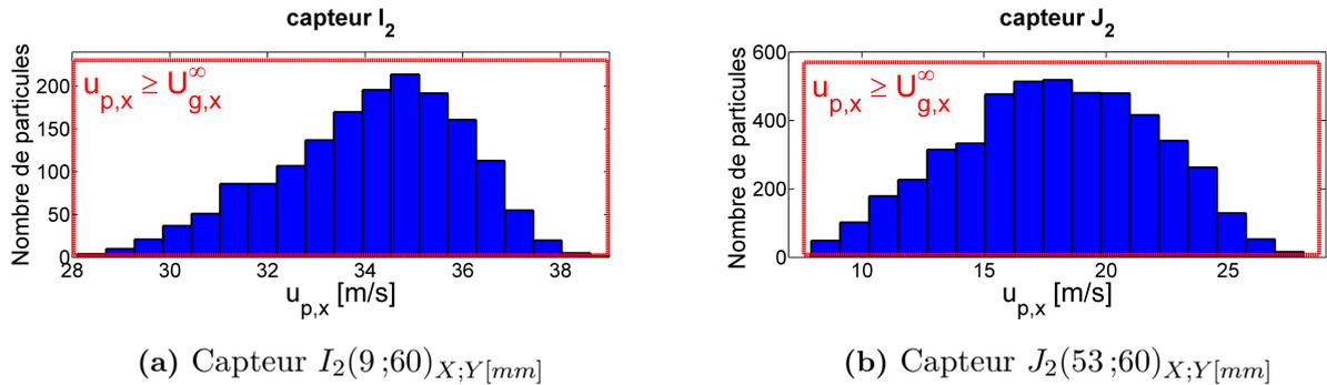
Figure 9.8 – Distributions des vitesses longitudinales instantanées de gouttes obtenues par mesures PDI aux capteurs  $I_2$  et  $J_2$  - **Domaine rouge** : gouttes dont la vitesse longitudinale est supérieure ou égale à la vitesse débitante - *Point de fonctionnement nominal, réactif*
