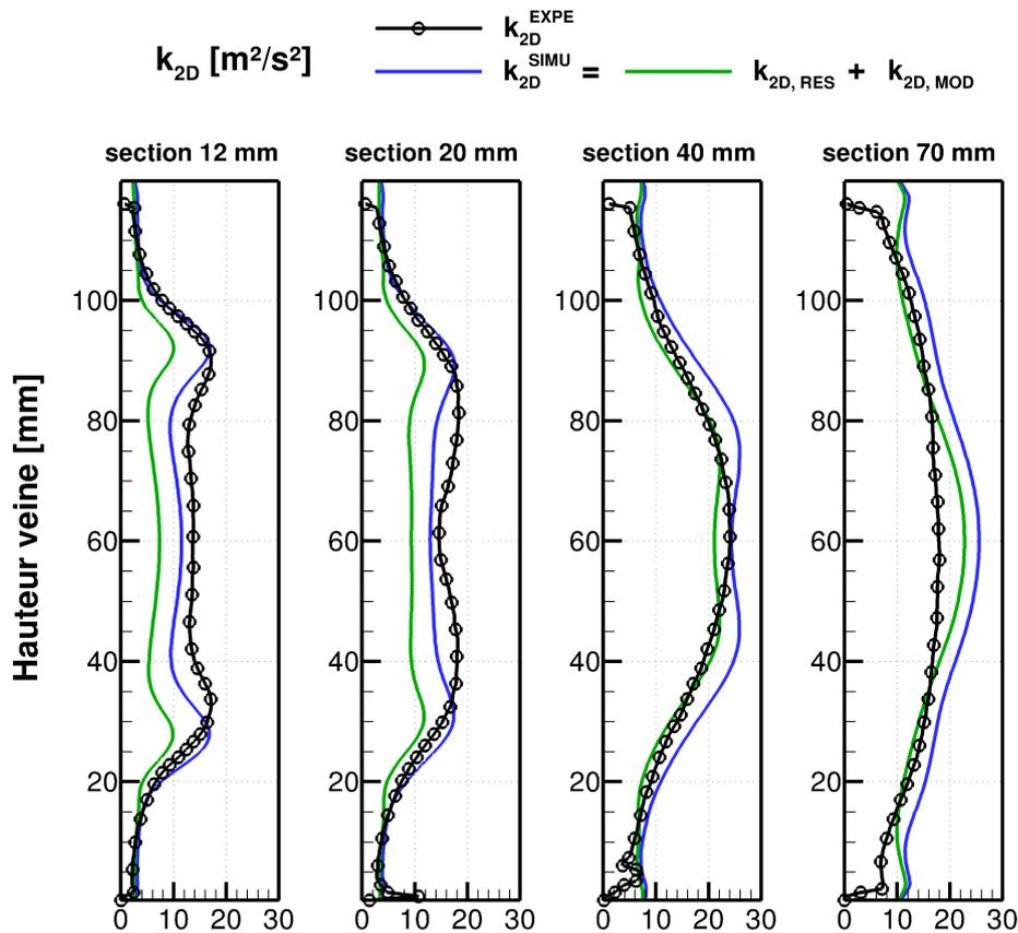
**Figure 12.3** – Profils d'énergie cinétique turbulente ( $\circ$  : mesures PIV [ $k_{2D}^{EXPE}$ ], — : calcul CHARME [ $k_{2D}^{SIMU}$ ], — : partie résolue du calcul CHARME [ $k_{2D,RES}$ ]. Avec  $k_{2D}^{SIMU} = k_{2D,RES} + k_{2D,MOD}$  - Conditions de référence
