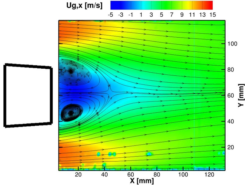
**Figure 7.2** – Champ moyen de vitesse longitudinale dans la chambre de combustion, obtenu par mesures PIV en aval de l'accroche-flamme - *Conditions de référence*
