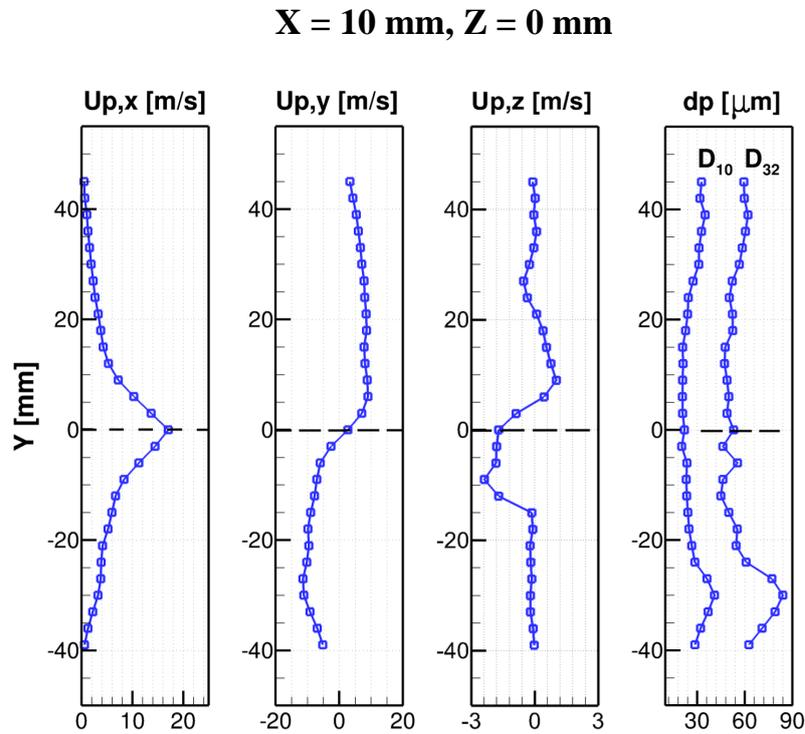
**Figure 5.10** – Profils moyens de vitesses et de tailles de gouttes obtenus par mesures PDI dans le plan médian du brouillard - Traversée verticale à  $X = 10$  mm - Carburant de similitude : éthanol ( $C_2H_6O$ , pureté = 95 %), débit liquide = 1 g/s - *Caractérisation à l'air libre* (sans écoulement d'air, conditions ambiantes)
