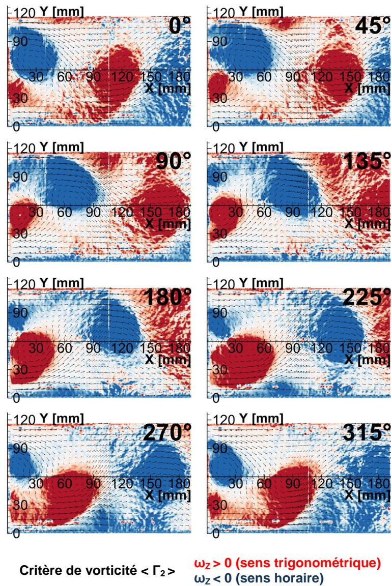
**Figure 7.6** – Séquences des champs de critère  $\langle \Gamma_2 \rangle$  moyennés en phase au cours du cycle de détachement tourbillonnaire - Conditionnement des mesures PIV par le signal de pression différentielle du capteur Validyne -  $\Delta\varphi = \pm 4^\circ$ , 240 images par phase - *Conditions de référence*
