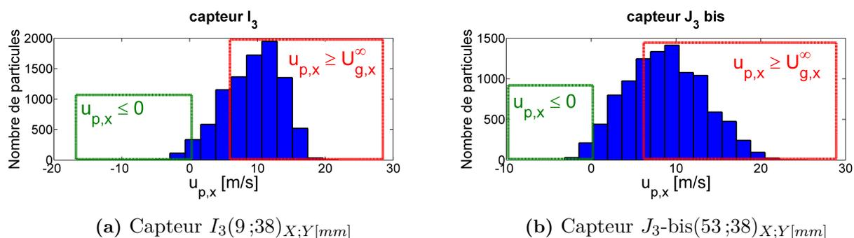
Figure C.3 – Distributions des vitesses longitudinales instantanées de gouttes obtenues par mesures PDI aux capteurs  $I_3$  et  $J_3\text{-bis}$  - *Point de fonctionnement nominal, non-réactif*
