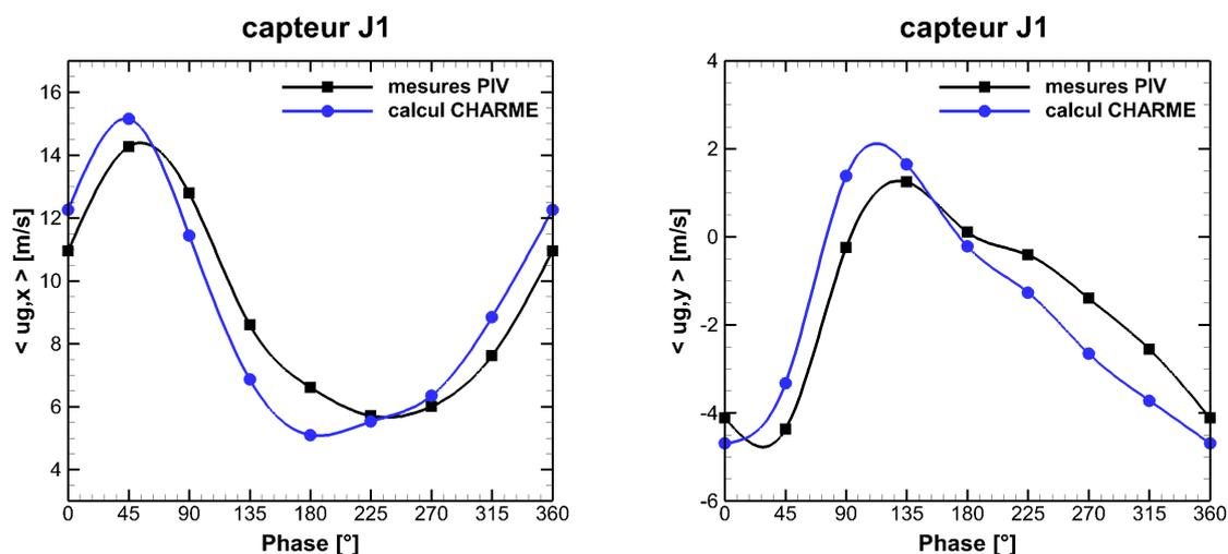
Figure 12.5 – Évolution des vitesses longitudinale et transversale de la phase gazeuse au cours du cycle de détachement tourbillonnaire, au niveau du capteur  $J_1(53;100)_{X,Y[mm]}$  - ( $\langle . \rangle$  : opérateur de moyenne de phase) - ■ : mesures PIV, ● : calcul CHARME - Conditions de référence
