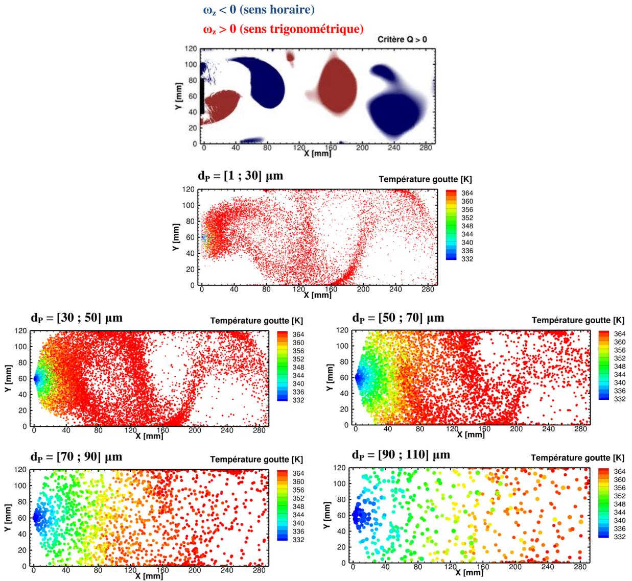
Figure 13.4 – Champ instantané représentant le critère  $Q$  de la phase gazeuse, ainsi que la répartition spatiale des gouttes suivant leur appartenance à une classe de diamètres. La taille des cercles est proportionnelle à la taille des gouttes. Les couleurs sont représentatives de leur températures
