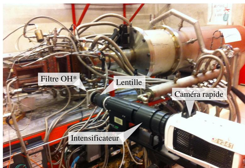
**Figure 6.10** – Photographie du dispositif d'imagerie rapide du front de flamme par chimiluminescence sur le montage PROMÉTHÉE
