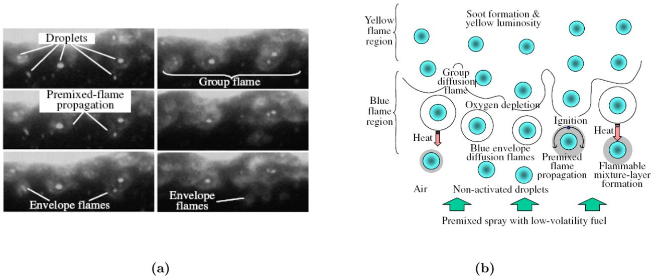
**Figure 4.10** – Étude d’une flamme diphasique à contre-courant [117]. (a) Clichés issus de visualisations rapides intensifiées montrant la flamme qui se propage de gouttes en gouttes ( $n$ -décane,  $\phi_{glob} = 0,85$ ) (b) Schéma de propagation de flamme dans un spray prémélangé
