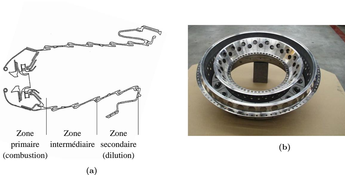
**Figure 2.5** – (a) Vue en coupe d'une chambre de combustion annulaire simple du moteur CFM56 (tirée de [Mongia \(1998\) \[119\]](#)) (b) Photographie d'une chambre de combustion (extraite de [Poinsot \(2010\) \[134\]](#))
