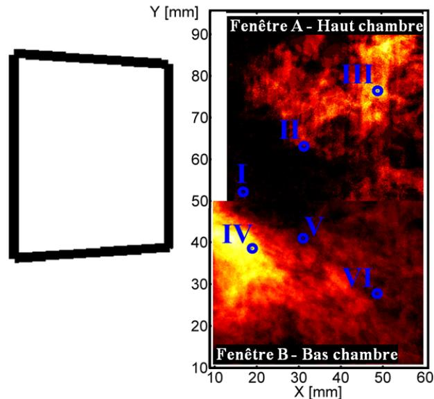
**Figure 10.6** – Champ moyen de PLIF-OH, illustrant une vue en coupe de la flamme dans le plan médian de la chambre de combustion, en aval de l'accroche-flamme - *Point de fonctionnement nominal, réactif*
