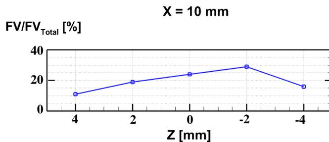
**Figure 5.11** – Profil du flux volumique normalisé suivant la composante normale Z, à  $X = 10$  mm - Carburant de similitude : éthanol ( $C_2H_6O$ , pureté = 95 %), débit liquide = 1 g/s - *Caractérisation à l'air libre* (sans écoulement d'air, conditions ambiantes)
