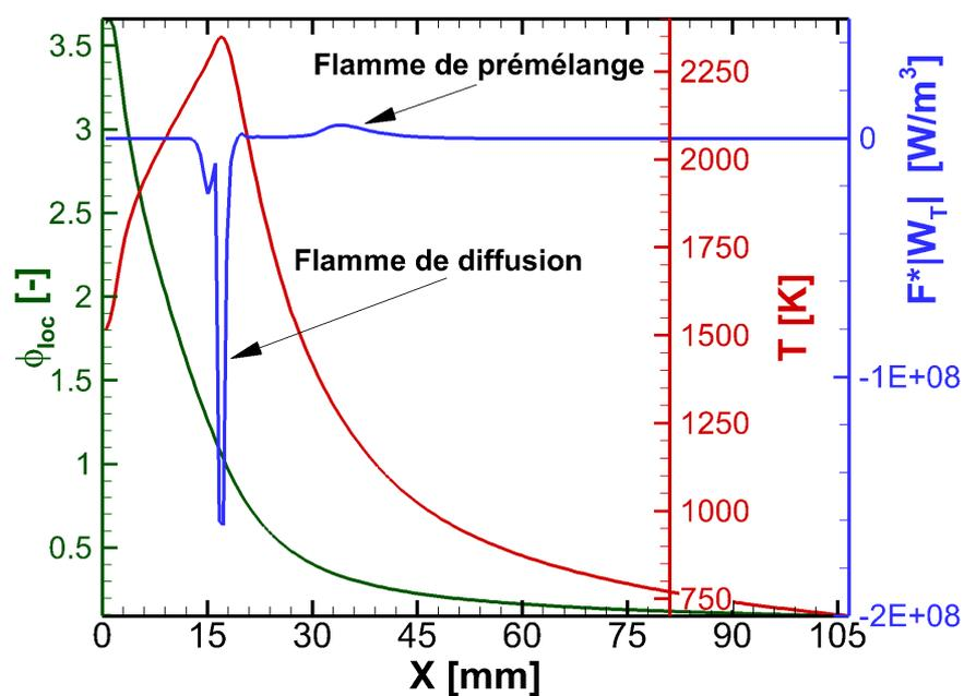
**Figure 13.6** – Profils de richesse locale, de température et de l'indice de Takeno réactif extraits le long de la ligne  $Y = 60$  mm - calcul CHARME-SPARTE - *Point de fonctionnement nominal, réactif*
