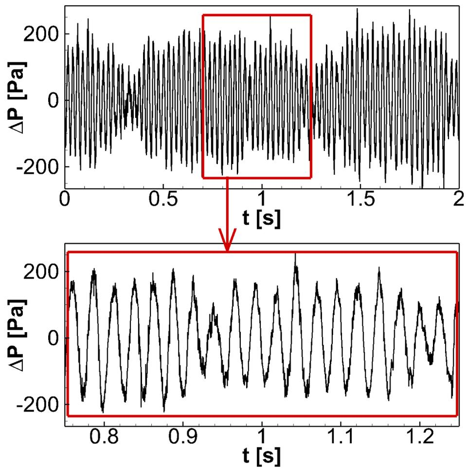
Figure B.2 – Signal temporel de pression différentielle  $\Delta P$  - Fréquence d'échantillonnage : 40 kHz
