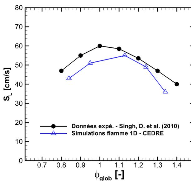
**Figure I.1** – Vitesse de flamme laminaire en fonction de la richesse globale du prémélange gazeux ( $n$ -décane/air), à  $T_u = 400$  K et 1 bar. ■ : mesures de Singh et al.(2011) [161],  $\Delta$  : calcul CHARME avec le mécanisme 2S\_KERO\_BFER de Franzelli et al.(2010) [68]
