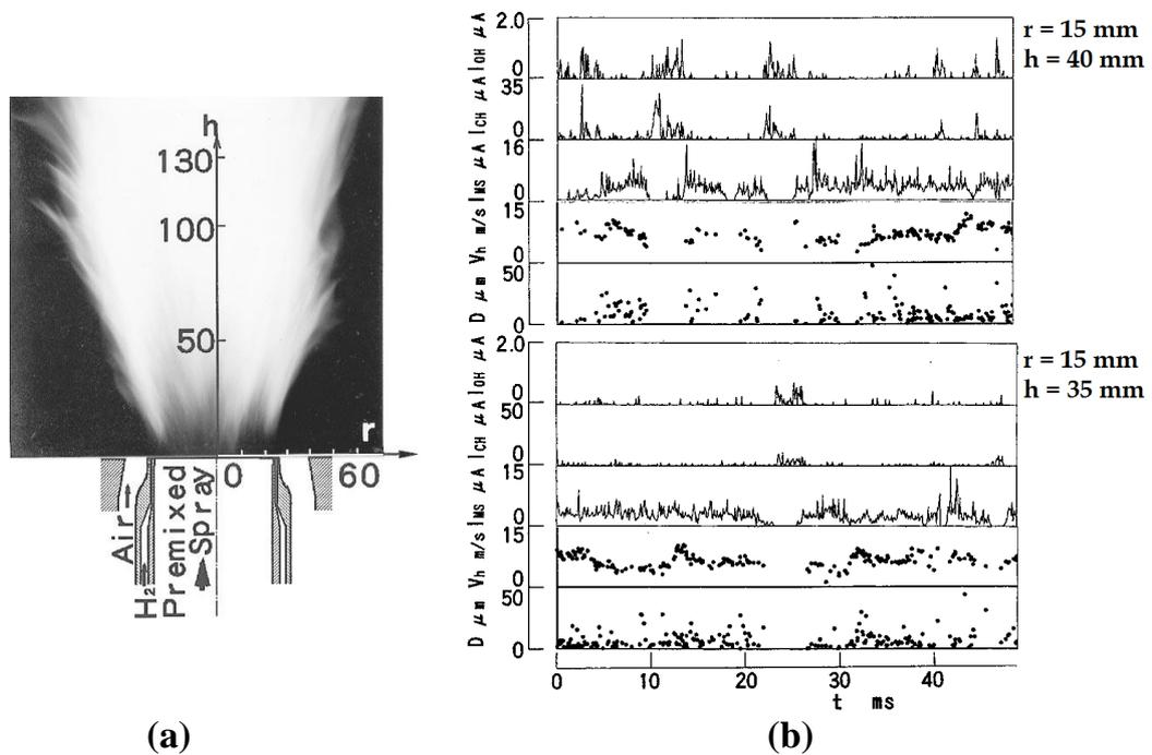
**Figure 4.12** – Étude d'une flamme de prémélange diphasique turbulente (air/kérosène). (a) Photographie de la flamme avec une longue durée d'exposition (1/15 s) (b) Chronogrammes des acquisitions en deux points du spray (D : diamètre goutte,  $V_h$  : vitesse goutte,  $I_{MS}$ ,  $I_{CH}$  et  $I_{OH}$  respectivement les intensités des signaux de Mie, CH et OH)
