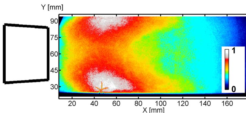
**Figure 9.6** – Écart-type de l'intensité de luminescence  $\text{OH}^*$  obtenu sur l'ensemble des visualisations (4 000 images, 1 kHz) - *Point de fonctionnement nominal, réactif*
