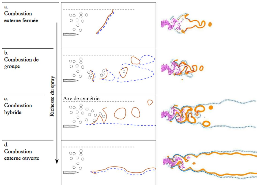
**Figure 4.9** – Classification des régimes de combustion diphasique pour un écoulement faiblement turbulent en fonction de la richesse à l’injection, ● : gouttes, — : flamme de prémélange, — : flamme de diffusion, tirets : iso-stœchiométrie de la fraction de mélange. Adapté des résultats de simulations DNS de Reveillon et al. (2005) [141]
