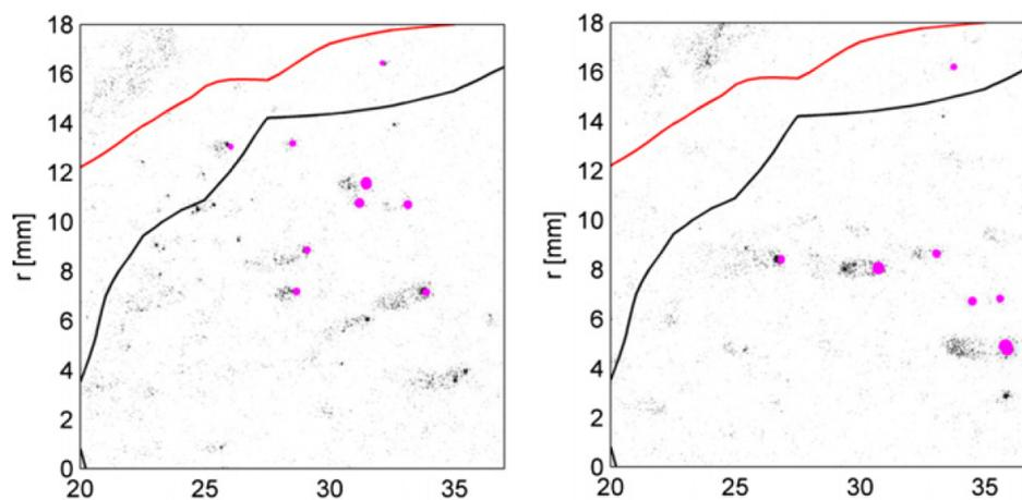
**Figure 4.13** – Étude d'une flamme turbulente partiellement prémélangée (air/*n*-heptane) [20, 19]. Les deux clichés superposent les signaux de PLIF-CH (la position des zones de réaction : niveaux de gris) et la diffusion Mie (la position des gouttes : ●)
