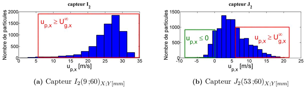
**Figure 8.6** – Distributions des vitesses longitudinales instantanées de gouttes obtenues par mesures PDI aux capteurs  $I_2(9;60)$  et  $J_2(53;60)$  - **Domaine rouge** : gouttes dont la vitesse longitudinale instantanée est supérieure ou égale à la vitesse moyenne débitante. **Domaine vert** : gouttes dont la vitesse est négative - *Point de fonctionnement nominal, non-réactif*
