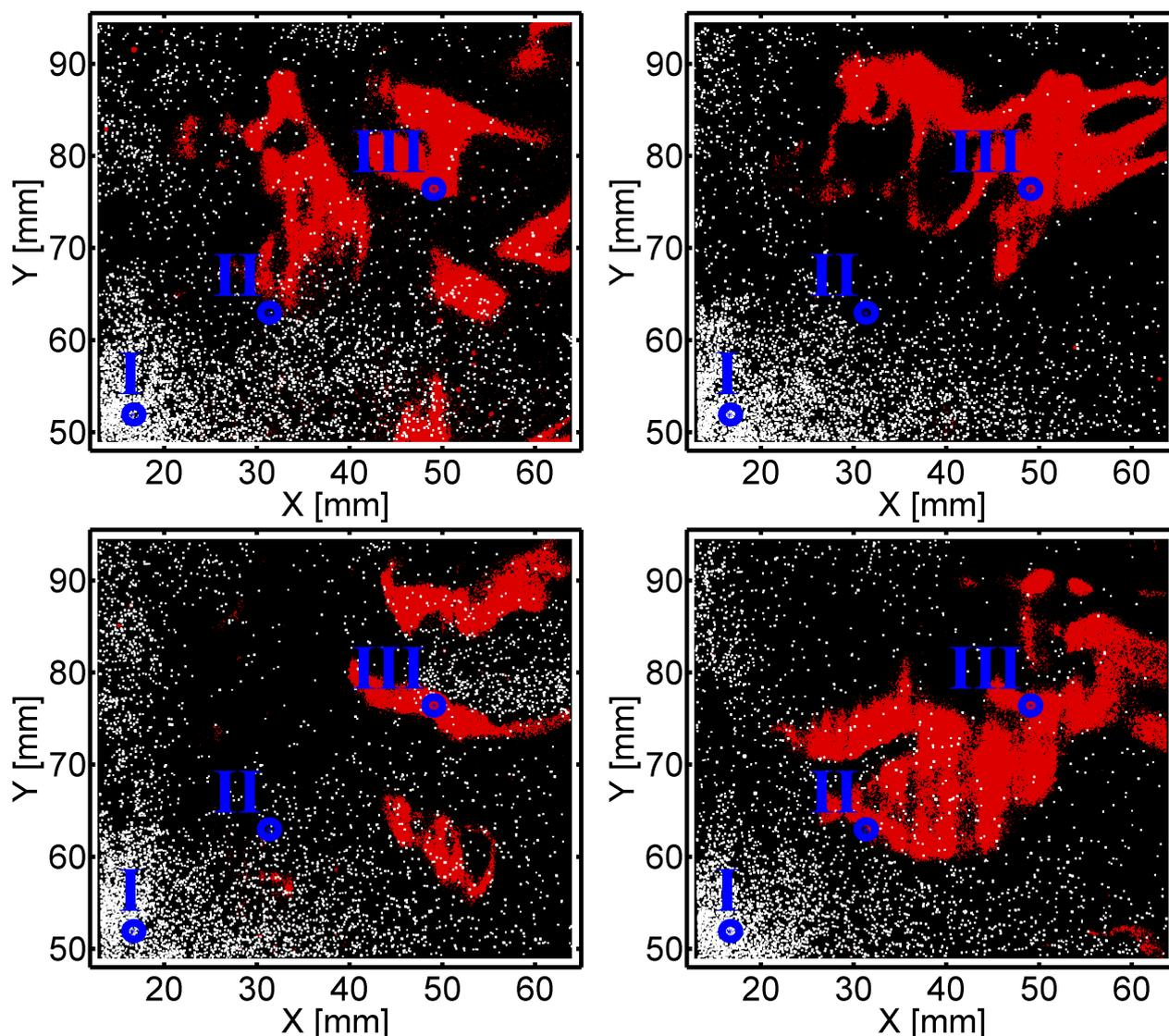
**Figure 10.7** – Images superposant la position des gouttes (diffusion de Mie) et la position des zones de réaction (PLIF-OH) dans la partie haute de la chambre (fenêtre A) - Points blancs : gouttes dilatées sur 3 px, En rouge : les zones de réaction/gaz brûlés - *Point de fonctionnement nominal, réactif*
