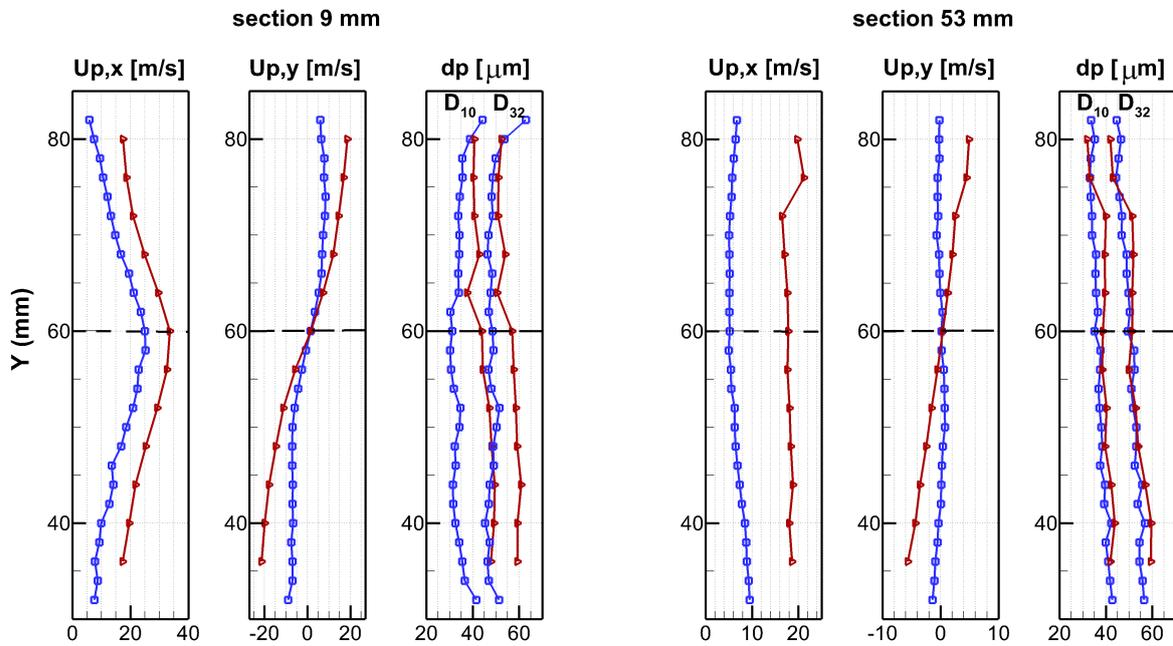
**Figure 9.10** – Profils moyens de vitesses et de diamètres de gouttes, obtenus par mesures PDI dans le plan médian du brouillard, en conditions inertes (■), et en conditions réactives (►) - Deux traversées verticales à  $X = \{9;53\}$  mm - *Point de fonctionnement nominal, réactif*
