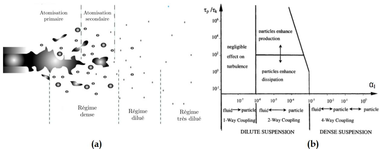
**Figure 3.5** – (a) Régimes de dilution d'un brouillard issu de l'atomisation d'une nappe liquide (extrait de [84]), (b) Diagramme des régimes de dilution d'un écoulement diphasique turbulent (tiré de [59])
