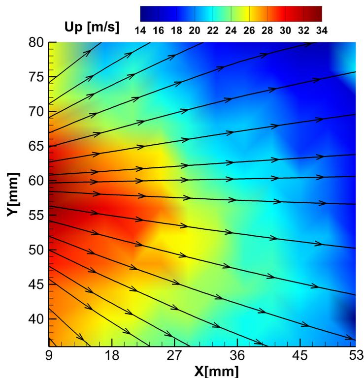
**Figure 9.7** – Champ moyen du module de la vitesse des gouttes obtenu par cartographie PDI du foyer - Les lignes de courant représentent les trajectoires moyennes des gouttes - *Point de fonctionnement nominal, réactif*
