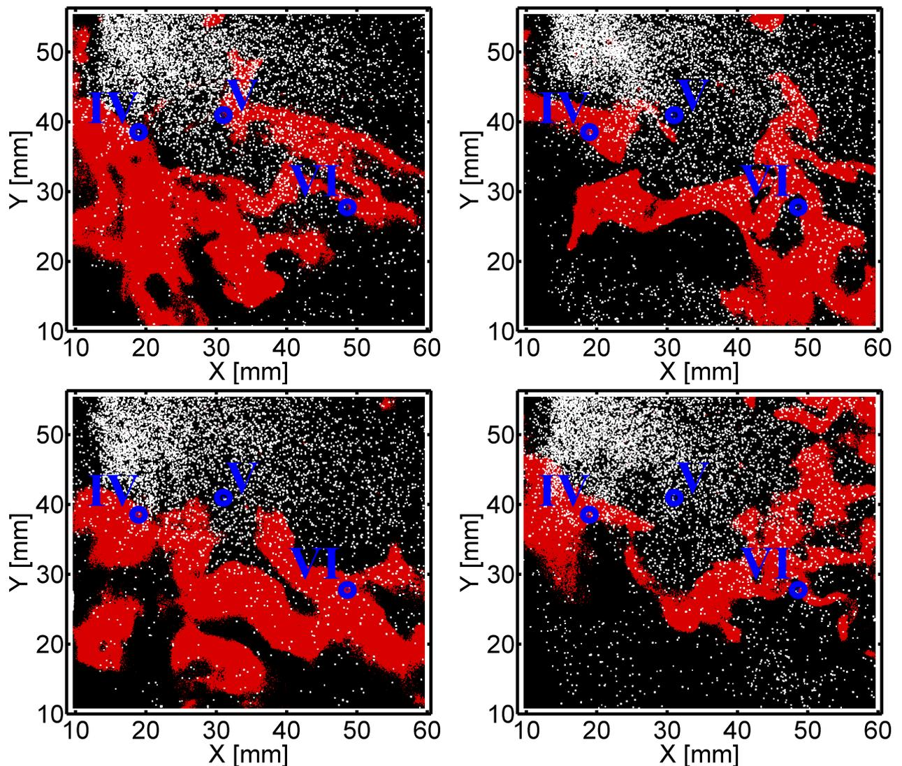
**Figure 10.8** – Images superposant la position des gouttes (diffusion de Mie) et la position des zones de réaction (PLIF-OH) dans la partie basse de la chambre (fenêtre B) - Points blancs : gouttes dilatées sur 3 px, En rouge : les zones de réaction/gaz brûlés - *Point de fonctionnement nominal, réactif*
