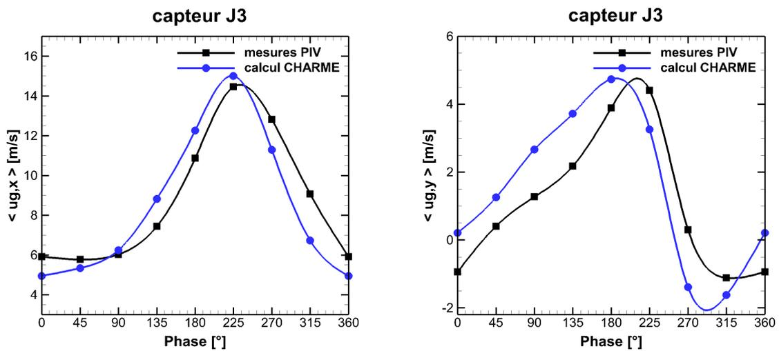
Figure 12.7 – Évolution des vitesses longitudinale et transversale de la phase gazeuse au cours du cycle de détachement tourbillonnaire, au niveau du capteur  $J_3(53;20)_{X,Y[mm]}$  - ( $\langle . \rangle$  : opérateur de moyenne de phase) - ■ : mesures PIV, ● : calcul CHARME - Conditions de référence
