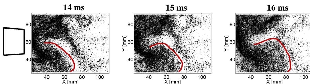
**Figure 8.3** – Visualisations tomographiques instantanées du brouillard mettant en évidence la progression d'un tourbillon en partie inférieure de la chambre - **En rouge** : front de gouttes - *Point de fonctionnement nominal, non-réactif*
