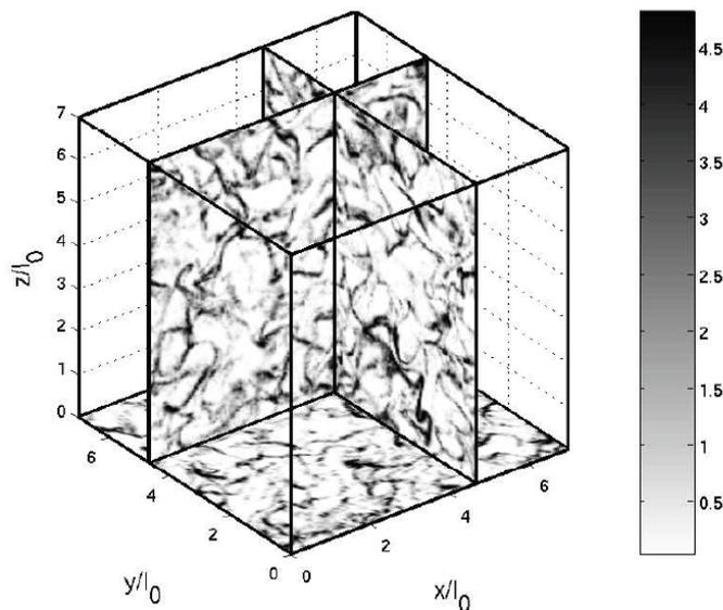
**Figure 4.1** – Résultats d'un calcul DNS portant sur la répartition de particules dans un champ gazeux de turbulence homogène isotrope - Échelle de couleur représentative de la concentration en particules (blanc : faible concentration, noir : forte concentration) - Effet de ségrégation préférentielle obtenu pour  $St = 1,05$  [140]
