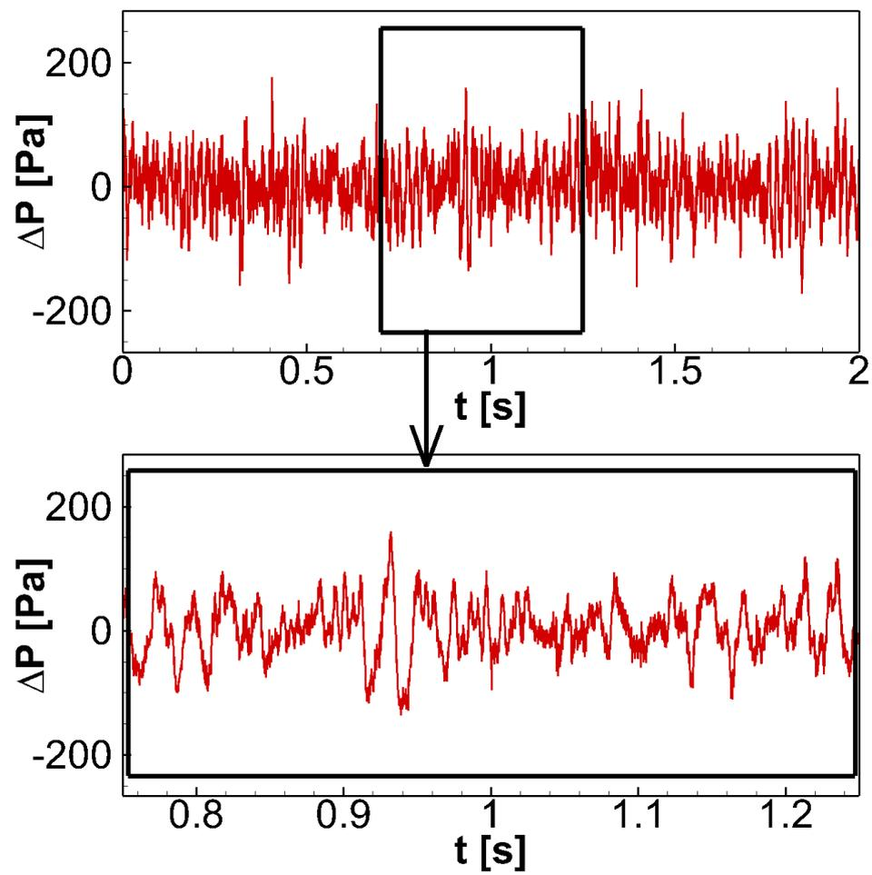
Figure B.4 – Signal temporel de pression différentielle  $\Delta P$  - Fréquence d'échantillonnage : 40 kHz
