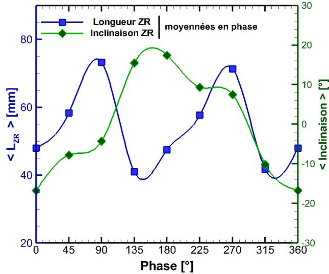
**Figure 7.7** – Évolution de la longueur (■) et de l'inclinaison (◆) de la zone de recirculation au cours du cycle de détachement tourbillonnaire, obtenues par méthode de suivi, c.-à-d. recherche du point *extremum* de la zone de recirculation - ( $\langle . \rangle$  : opérateur de moyenne de phase) - *Conditions de référence*
