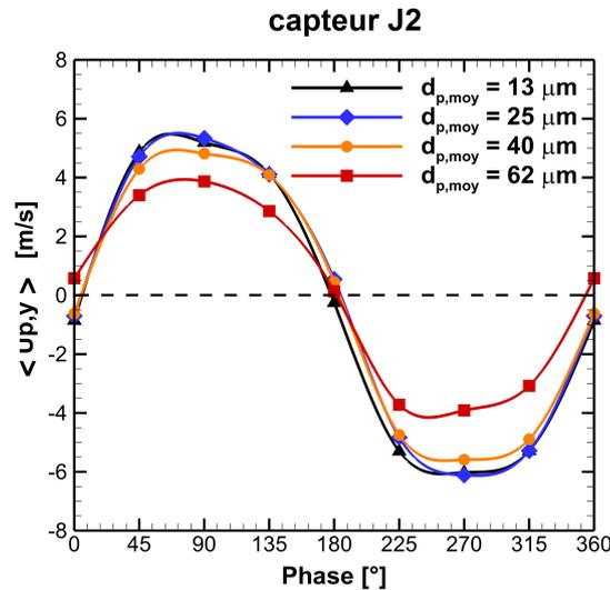
**Figure 8.10** – Évolution de la vitesse transversale des différentes classes de gouttes, au cours du cycle, au niveau du capteur  $J_2(53;60)$  - Point de fonctionnement nominal, non-réactif
