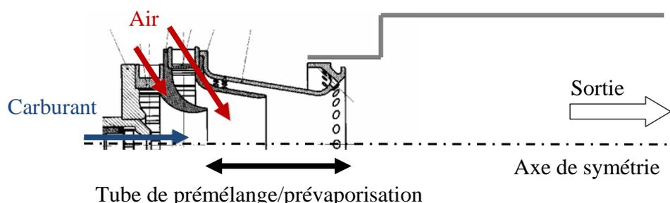
**Figure 2.8** – Schéma de principe d'un système LPP constitué d'un dispositif d'injection, un tube de prémélange et d'une chambre de combustion (adapté de [169])
