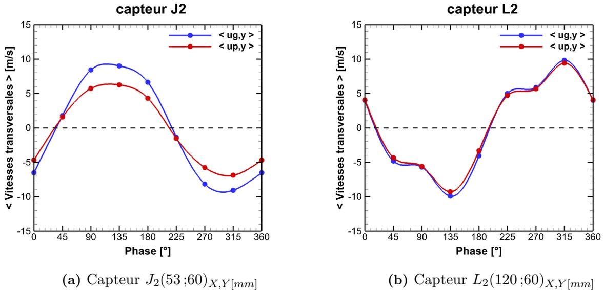
**Figure 13.2** – Évolution des vitesses transversales pour la phase gazeuse (●) et la phase dispersée (●), au cours du cycle de détachement tourbillonnaire - ( $\langle . \rangle$  : opérateur de moyenne de phase) - Données obtenues par simulation CHARME-SPARTE - *Point de fonctionnement nominal*
