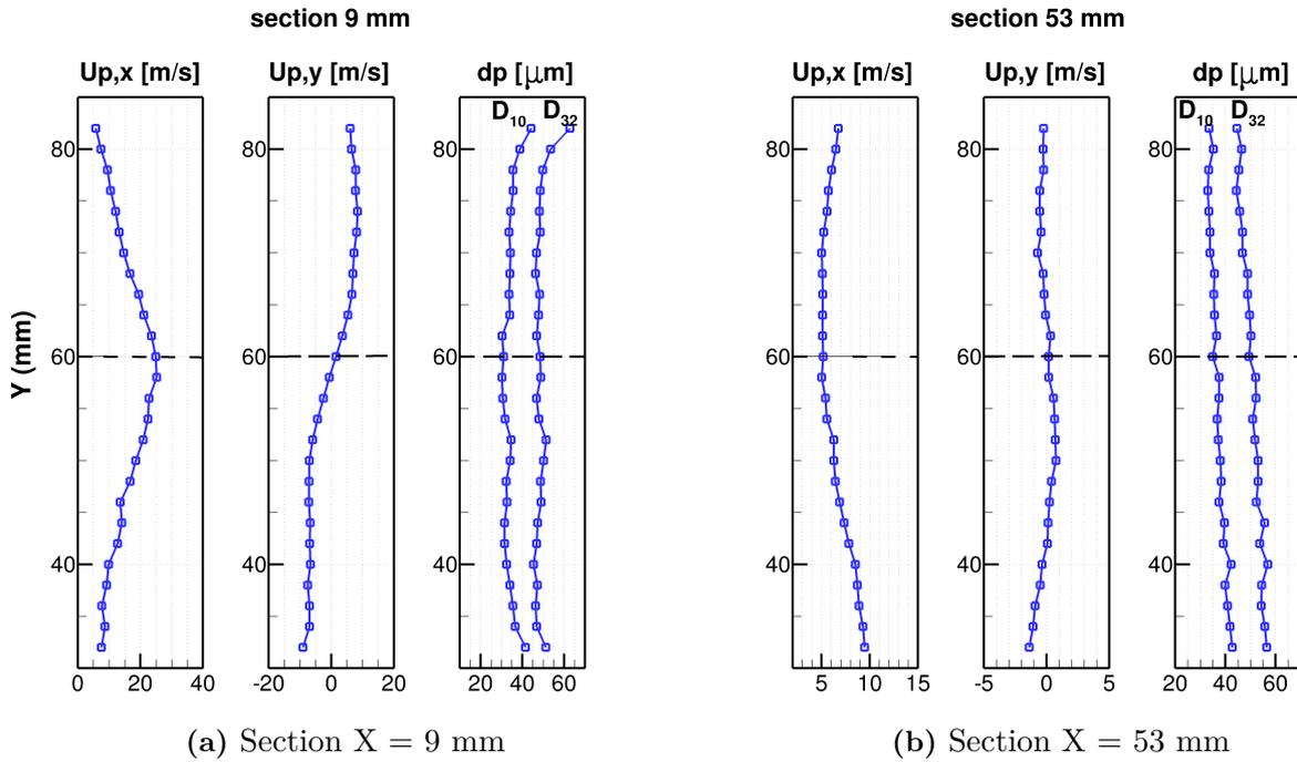
**Figure 8.5** – Profils moyens de vitesses et de diamètres obtenus par mesures PDI dans le plan médian du spray - Deux traversées verticales à  $X = \{9; 53\}$  mm - *Point de fonctionnement nominal, non-réactif*
