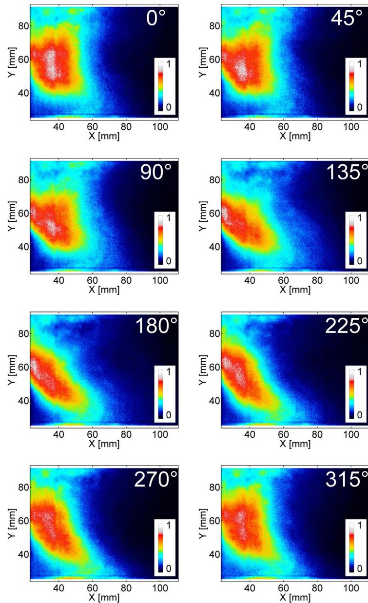
**Figure 8.4** – Visualisations tomographiques du spray moyennées en phase à partir du signal de pression  $\Delta P$ . Cette séquence d'images fait ressortir le battement du brouillard au cours du cycle de détachement tourbillonnaire - Niveaux de diffusion de Mie normalisés - *Point de fonctionnement nominal, non-réactif*
