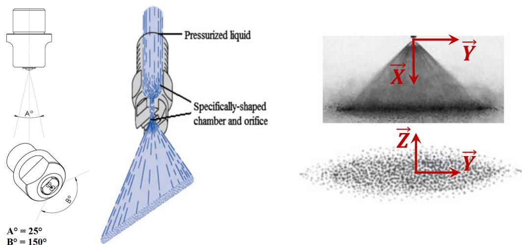
**Figure 5.8** – (a) : Injecteur « flat fan » de marque MMP (angles d'injection :  $A^\circ = 25^\circ$ ,  $B^\circ = 150^\circ$ , (b) : illustration d'un « flat spray » d'après [Ashgriz \(2011\) \[9\]](#), (c) : choix du repère cartésien attaché au brouillard
