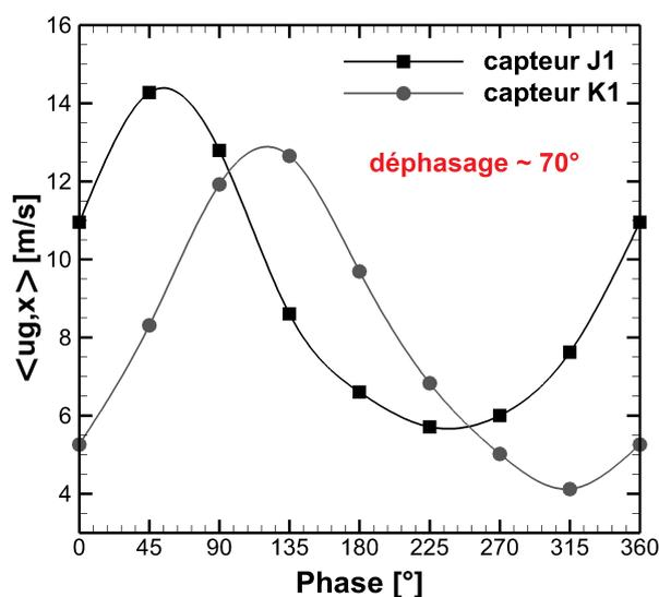
**Figure 7.8** – Évolution des vitesses longitudinales de la phase gazeuse (données PIV), au cours du cycle de détachement tourbillonnaire, au niveau des capteurs  $J_1(53;100)_{X;Y[mm]}$  et  $K_1(90;100)_{X;Y[mm]}$  - ( $\langle . \rangle$  : opérateur de moyenne de phase) - Conditions de référence
