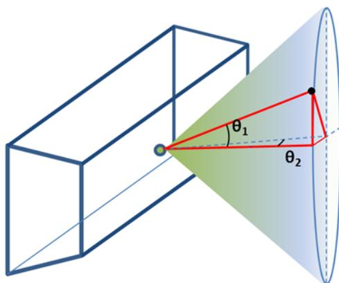
**Figure 11.2** – Schéma du brouillard « flat spray » produit au culot de l'accroche-flamme. Dans cette étude, les angles d'ouverture du brouillard sont  $\theta_1 \in [-75; 75]^\circ$  et  $\theta_2 \in [-12,5; 12,5]^\circ$
