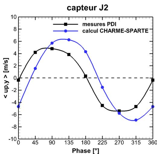
**Figure 12.10** – Évolution de la vitesse transversale de la phase dispersée au cours du cycle de détachement tourbillonnaire, au niveau du capteur  $J_2(53;60)_{X,Y[mm]}$  - ( $\langle . \rangle$  : opérateur de moyenne de phase) - ■ : mesures PDI, ● : calcul CHARME-SPARTE - *Point de fonctionnement nominal, non-réactif*
