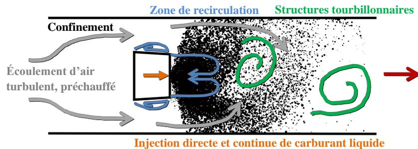
(b) Chambre de combustion PROMÉTHÉE - Canal de section carrée, utilisation d'un accroche-flamme faisant office de corps perturbateur (« bluff-body ») et de porte-injecteur, écoulement plutôt « 2D »
