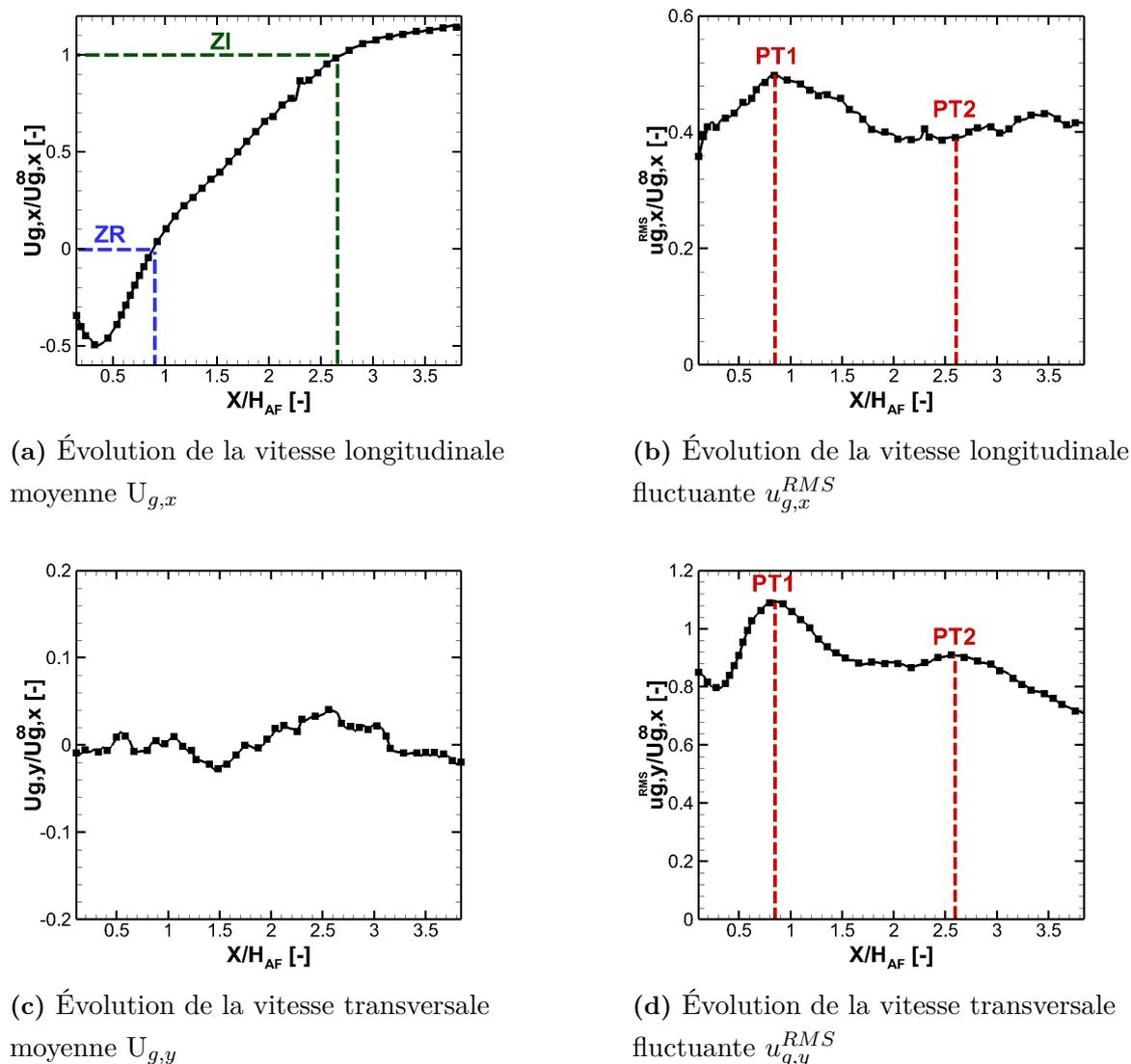
**Figure 7.4** – Profils moyens de vitesse le long de l'axe médian de la chambre de combustion ( $Y = 60$  mm), obtenus par mesures PIV - ZR : « zone de recirculation », ZI : « zone d'influence »,  $PT_1$  &  $PT_2$  : « points de transit des tourbillons » sur l'axe médian du foyer ( $Y = 60$  mm) - *Conditions de référence*
