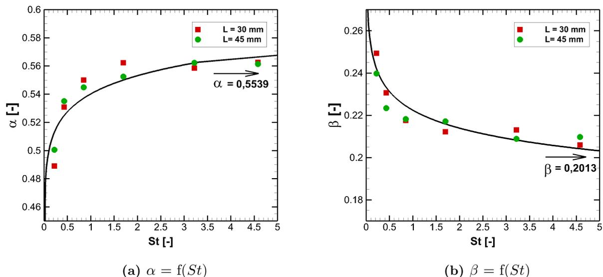
**Figure 14.2** – Évolution des coefficients de proportionnalité  $\alpha$  et  $\beta$  en fonction du nombre de Stokes (éq. 14.21). Traitement réalisé à partir des résultats de simulations DNS-DPS de Fede et al. (2015) [65]
