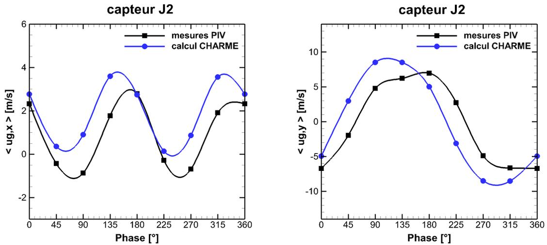
Figure 12.6 – Évolution des vitesses longitudinale et transversale de la phase gazeuse au cours du cycle de détachement tourbillonnaire, au niveau du capteur  $J_2(53;60)_{X,Y[mm]}$  - ( $\langle . \rangle$  : opérateur de moyenne de phase) - ■ : mesures PIV, ● : calcul CHARME - Conditions de référence
