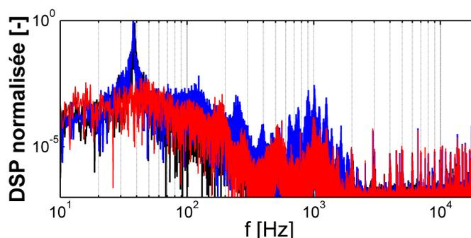
**Figure 9.1** – Densit es spectrales de puissance obtenues  a partir des signaux temporels de pression  $\Delta P$  (cf. annexe, figures B.2, B.3, B.4) - Comparaison des cas **monophasique inerte/diphasique inerte/ diphasique r eactif** - Rep ere log-log - *Point de fonctionnement nominal, inerte et r eactif*
