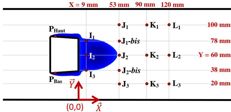
**Figure 6.2** – Schéma illustrant le repère cartésien défini dans le plan médian de la chambre PROMÉTHÉE ( $Z = 0$ ), et la position des capteurs vis-à-vis de la zone de recirculation dans le sillage de l'accroche-flamme, en écoulement non-réactif. Par convention, la pression différentielle au niveau du capteur est définie comme  $\Delta P = P_{\text{Haut}} - P_{\text{Bas}}$
