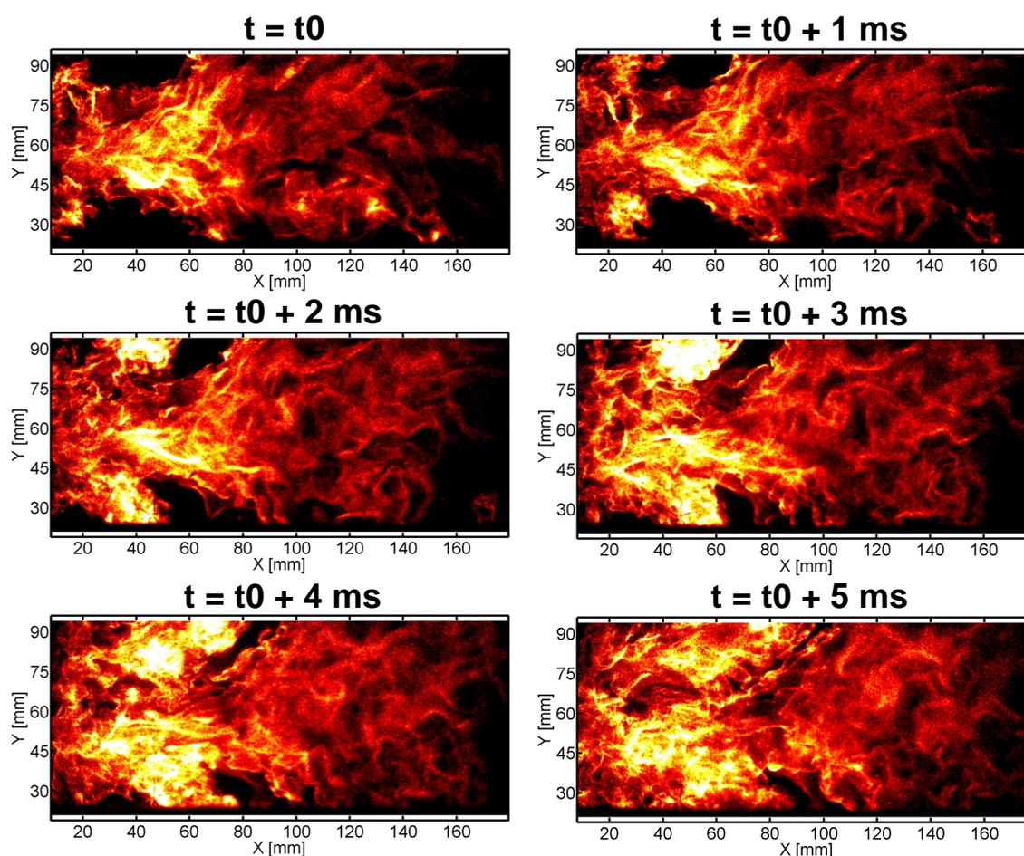
**Figure 9.4** – Séquence d'images instantanées de chimiluminescence  $\text{OH}^*$  acquises à une fréquence de 1 kHz - Utilisation de fausses couleurs - *Point de fonctionnement nominal, réactif*
