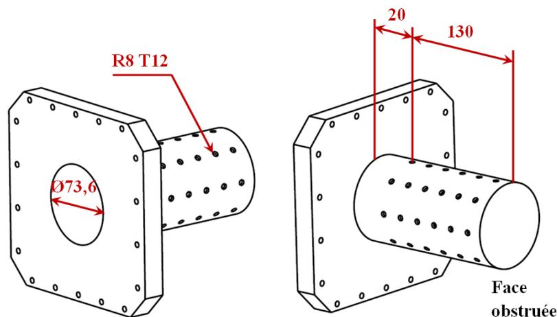
**Figure 5.3** – Vues isométriques du redresseur. R8 T12 signifie que les perforations sont rondes, de diamètre 8 mm avec un entraxe de 12 mm. La pièce comporte environ 70 perforations. Les autres caractéristiques sont données en mm
