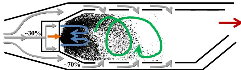
(a) Chambre de combustion réelle - Géométrie annulaire, écoulement swirlé « 3D »
