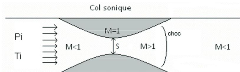
**Figure 5.2** – Principe de fonctionnement d'un col sonique [8]
