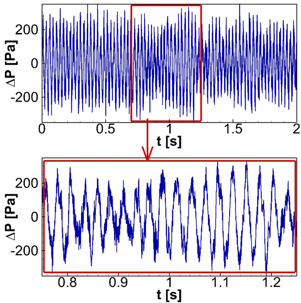
**Figure B.3** – Signal temporel de pression différentielle  $\Delta P$  - Fréquence d'échantillonnage : 40 kHz
