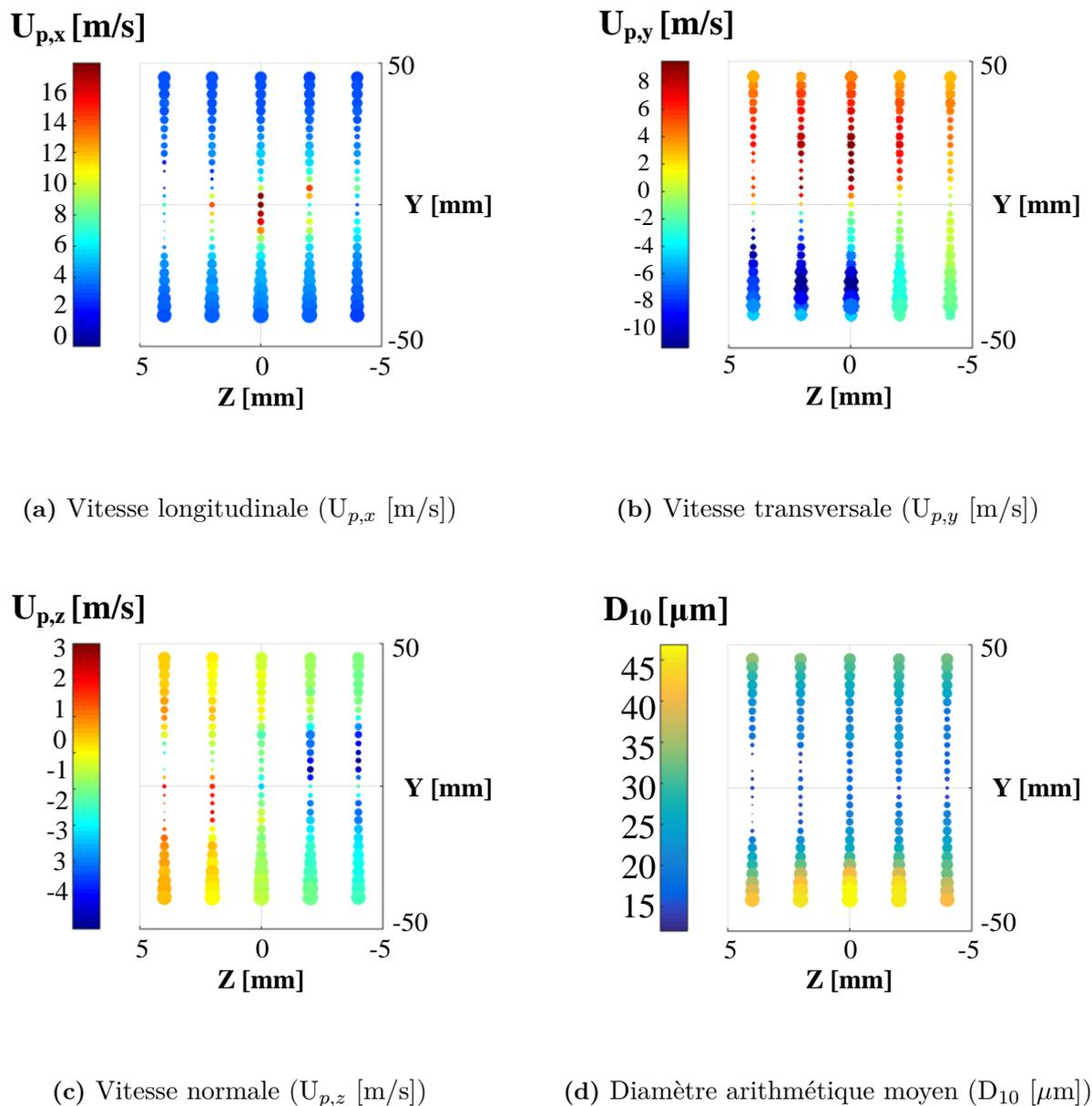
**Figure 5.9** – Représentation non-isométrique de la topologie 3D du brouillard en sortie de l’injecteur « flat fan » (MMP) à  $X = 10$  mm - Carburant de similitude : éthanol ( $C_2H_6O$ , pureté = 95 %), débit liquide = 1 g/s - *Caractérisation à l’air libre* (sans écoulement d’air, conditions ambiantes)
