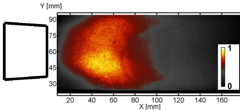
**Figure 9.5** – Moyenne temporelle de l'intensité de luminescence  $\text{OH}^*$  obtenue sur l'ensemble des visualisations (4 000 images, 1 kHz) - *Point de fonctionnement nominal, réactif*
