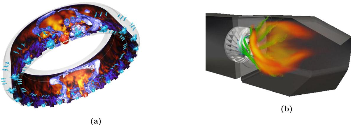
**Figure 3.1** – (a) Simulation LES avec le logiciel AVBP d'une séquence d'allumage au sein de la chambre de combustion annulaire VESTA (Turbomeca) [27] (b) Simulation LES avec le logiciel CEDRE de la production de suie dans une portion de la chambre annulaire TLC (Turbomeca) [52]
