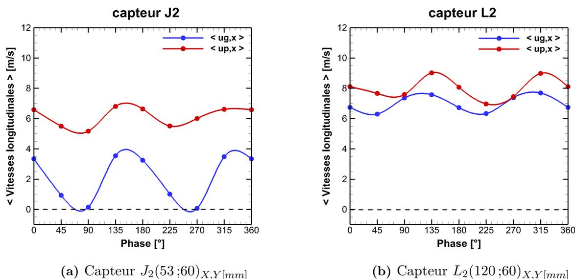
**Figure 13.1** – Évolution des vitesses longitudinales pour la phase gazeuse (●) et la phase dispersée (●), au cours du cycle de détachement tourbillonnaire - ( $\langle . \rangle$  : opérateur de moyenne de phase)- Données obtenues par simulation CHARME-SPARTE - *Point de fonctionnement nominal*
