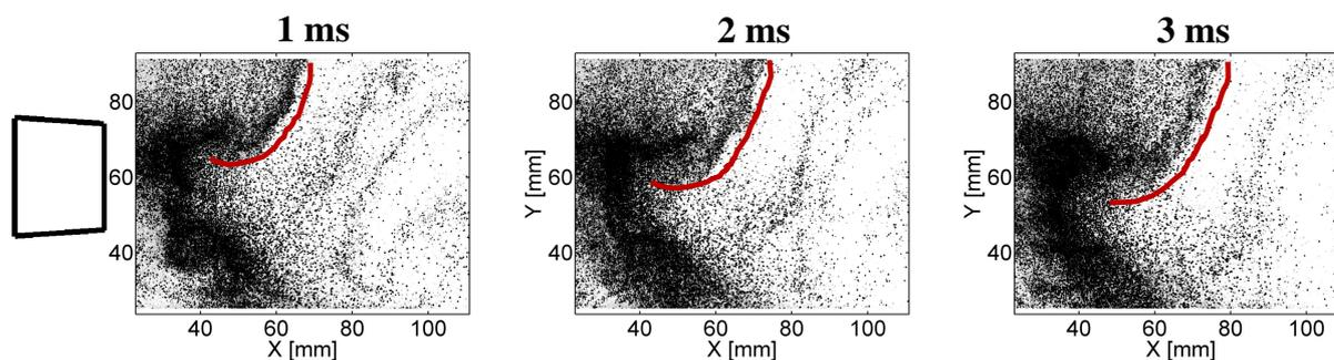
**Figure 8.2** – Visualisations tomographiques instantanées du brouillard mettant en évidence la progression d'un tourbillon en partie supérieure de la chambre - **En rouge** : front de gouttes - *Point de fonctionnement nominal, non-réactif*
