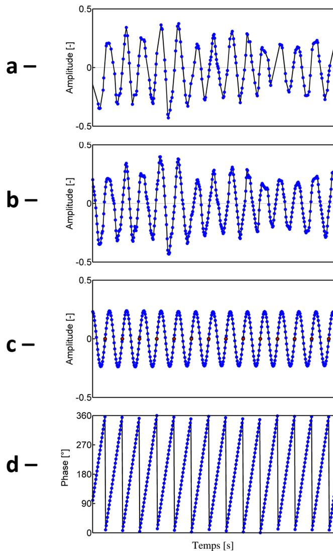
**Figure 6.11** – Procédure de traitement du signal de référence pour conditionner en phase une mesure ou synchroniser, *a posteriori*, différentes mesures **(a)** : signal de référence brut à pas de temps variable **(b)** : signal de référence ré-échantillonné avec un pas de temps constant **(c)** : signal de référence filtré autour de la fréquence du phénomène. **(d)** : attribution de phase aux différents points de mesures (entre 0 et 360°)
