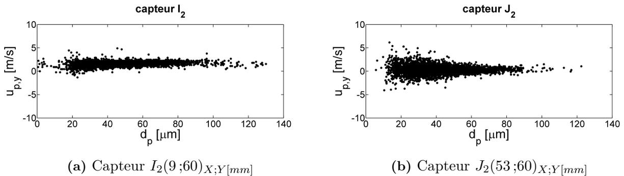
Figure 9.9 – Nuages de points, sur l'ensemble des données PDI brutes, caractérisant les corrélations diamètre/vitesse transversale des gouttes aux capteurs  $I_2$  et  $J_2$  - *Point de fonctionnement nominal, réactif*
