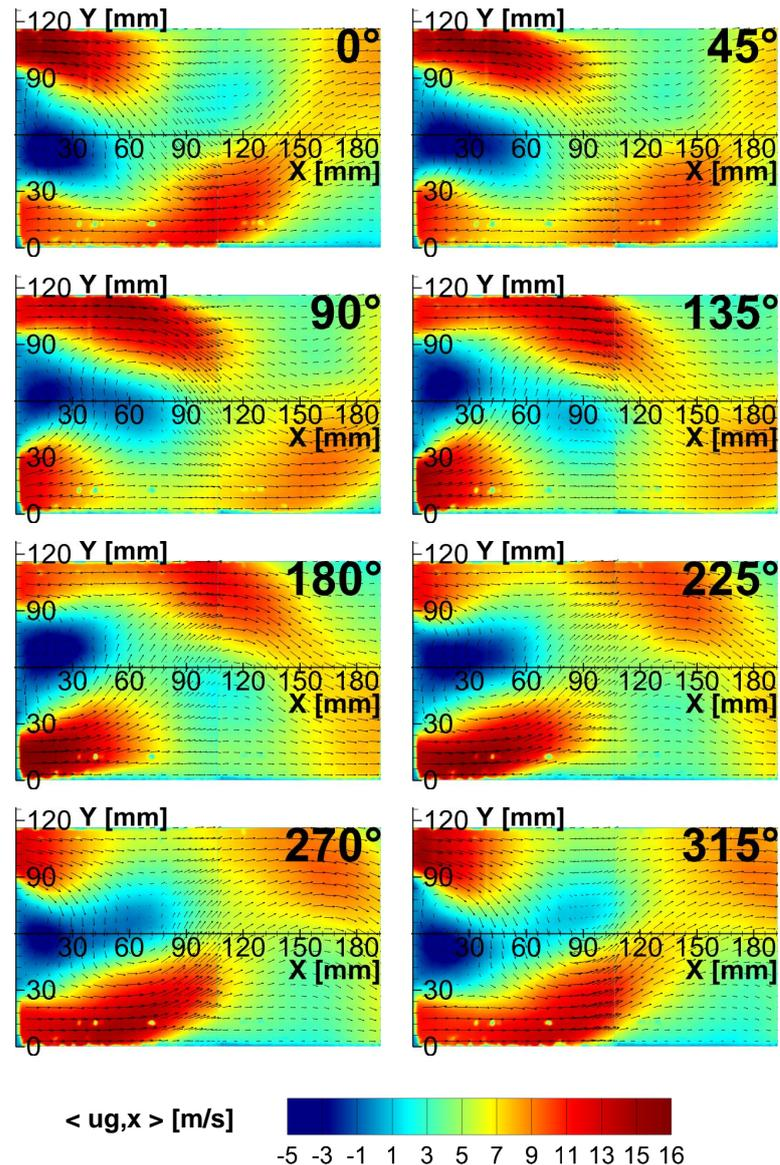
**Figure 7.5** – Séquences des champs de vitesses longitudinales du gaz au cours du cycle de détachement tourbillonnaire - ( $\langle . \rangle$  : opérateur de moyenne de phase) - Conditionnement des mesures PIV par le signal de pression différentielle du capteur Validyne -  $\Delta\varphi = \pm 4^\circ$ , 240 images par phase - *Conditions de référence*
