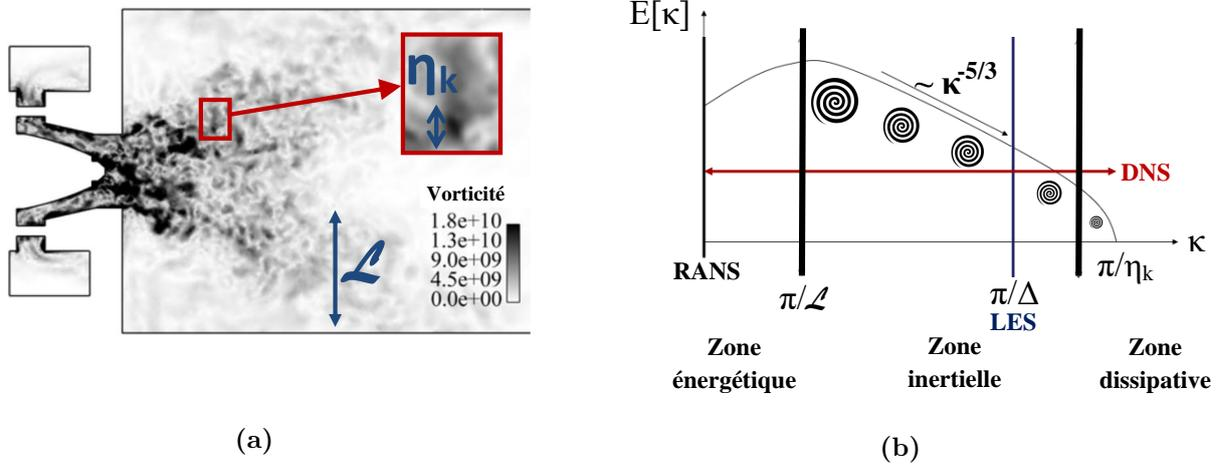
**Figure 3.2** – (a) Visualisation d'un champ de vorticité instantané dans la chambre de combustion du montage MERCATO (calcul AVBP, CERFACS [156]), illustrant le problème multi-échelle de la turbulence (b) Schéma de la densité spectrale d'énergie en fonction du nombre d'onde  $\kappa$ , pour les trois approches DNS, LES, RANS
