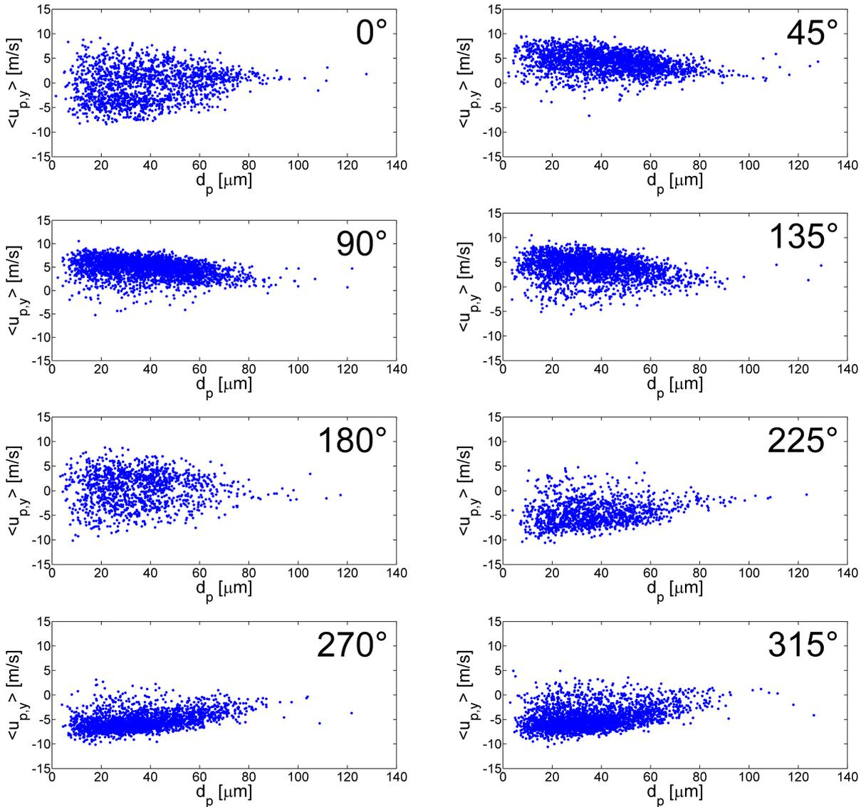
**Figure 8.9** – Données PDI conditionnées en phase par le signal de pression, caractérisant les corrélations diamètre/vitesse transversale des gouttes au cours du cycle de détachement tourbillonnaire, au capteur  $J_2(53;60)$  - *Point de fonctionnement nominal, non-réactif*
