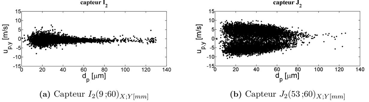
**Figure 8.7** – Nuage de points caractérisant les corrélations diamètre/vitesse transversale des gouttes aux capteurs  $I_2$  et  $J_2$  - *Point de fonctionnement nominal, non-réactif*
