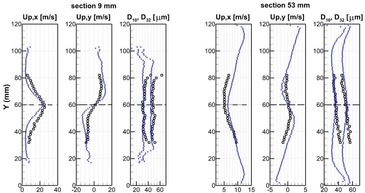
**Figure 12.8** – Profils moyens de vitesses et de diamètres de gouttes dans le plan médian du brouillard. Deux traversées verticales à  $X = \{9; 53\}$  mm.  $\square$  : mesures PDI,  $\bullet$  : calcul CHARME-SPARTE - Point de fonctionnement nominal, non-réactif
