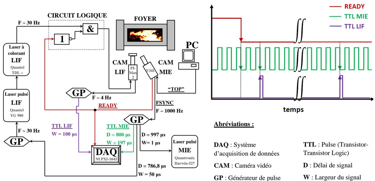
Figure 6.14 – Réglages et chronogramme du système de synchronisation des mesures PLIF-OH/Mie
