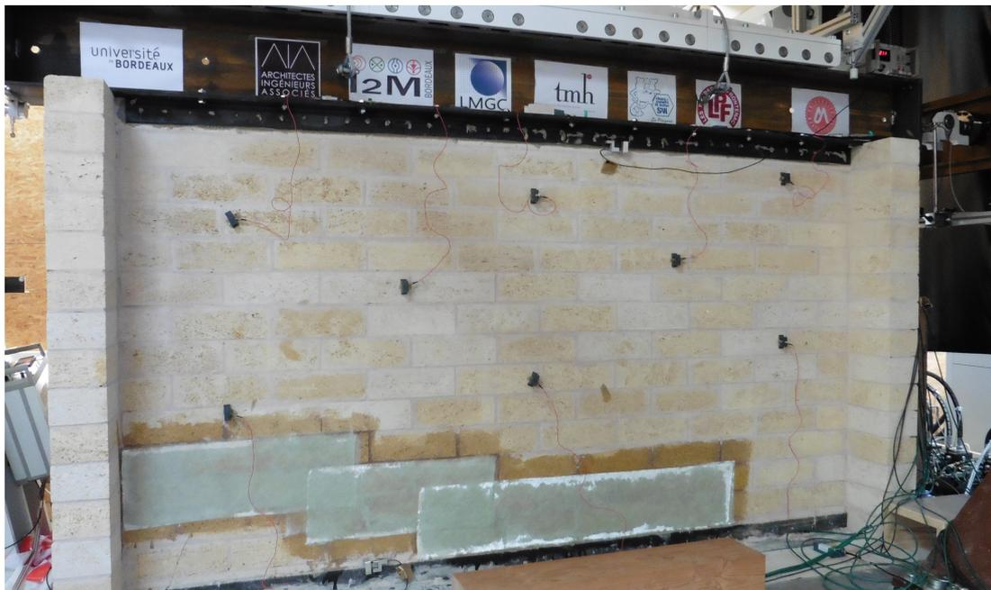
FIGURE 5.4 – Renforcement du mur
