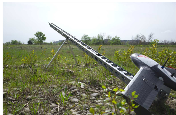
Illustration 43: Drone sur sa catapulte, paré au décollage
