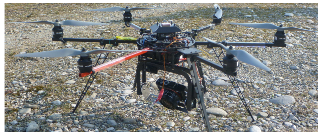
Figure 42: Mikrocopter HexaXL de l'IGN avec le Sony DSC-RX1 sur une nacelle gyroscopiquement stabilisée
