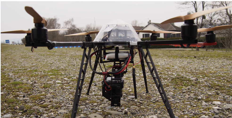
Illustration 35: Hexacoptère de l'IGN utilisé pour les acquisitions
