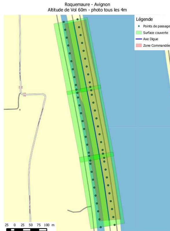
Illustration 38: Plan de vol, position des sommets de prise de vue
