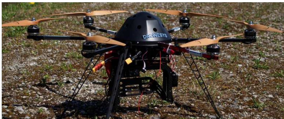
Illustration 116: Le drone DS6-1200 utilisé par le SAA pour les acquisitions
