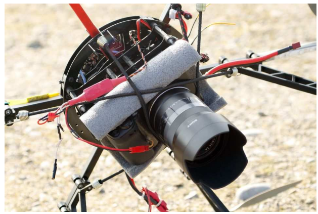
Illustration 11: Adaptation d'une pièce de mousse pour contrer les vibrations
