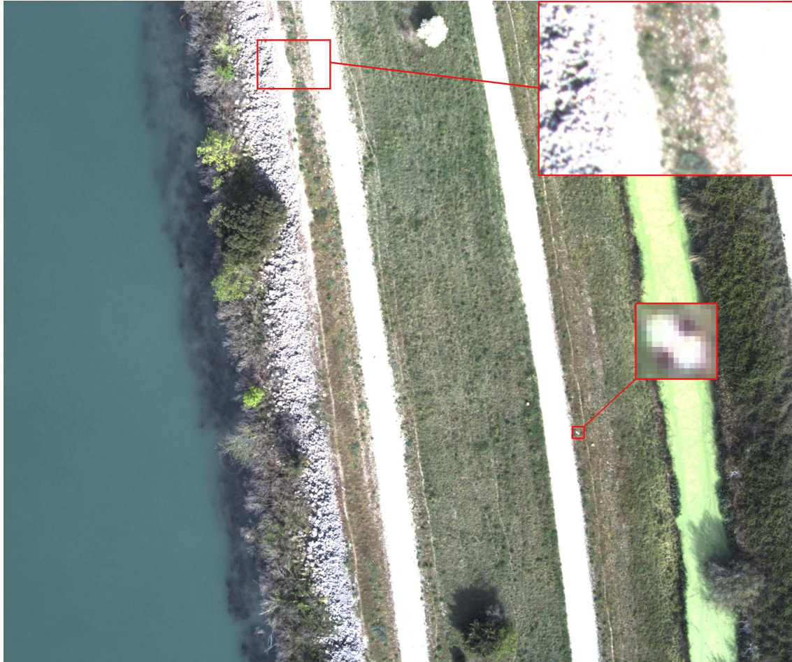
Figure 39: Image acquise avec le DT18. Le réglage de l'appareil photographique sans retour d'image peut amener à surexposer des zones. L'intersection en damier des points d'appui n'est pas nette
