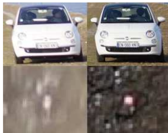
Figure 32: Extrait d'images prises par le NEX7 (à gauche) et le DSC-RX1 (à droite) : au sol (en haut) et en vol (en bas)
