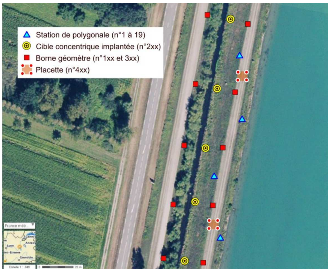
Illustration 112: Extrait du plan d'implantation et du canevas polygonal
