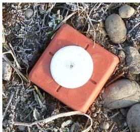
Notre choix s'est porté sur les bornes Feno utilisées par les géomètres, auxquelles nous avons supplanté un bouchon afin de mieux les identifier. Elles répondent aux caractéristiques requises pour leur visibilité (largeur de 9cm x 9cm, soit environ 81 pixels sur l'image), et présentent l'avantage d'être solidement ancrées dans le sol (en place pour de futures missions). La cible est donc composée d'une borne rouge et d'un centre blanc.
