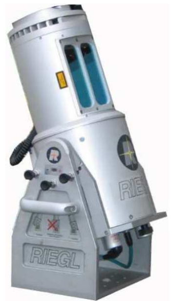
Figure 13: Riegl LMS-Z620 utilisé par la société 3D Scan Map pour le relevé terrestre de la digue de Rochemaure
