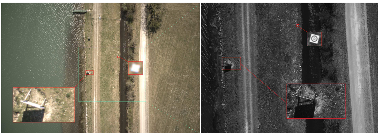
Illustration 122: Images capturées par le Sony DSC-RX1 35 mm (à gauche), et par la Camlight 85 mm (à droite). Même en volant à 150 mètres, la Camlight peut acquérir des images d'excellente qualité
