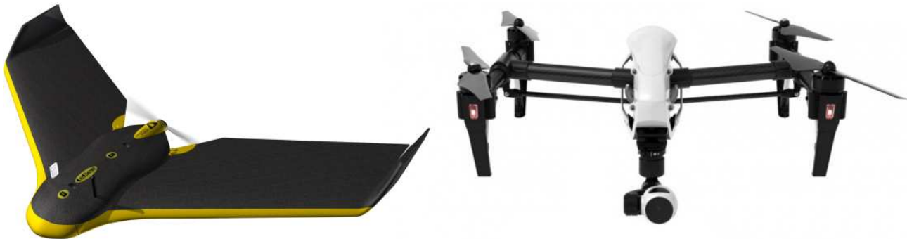
Figure 9: Montage illustrant un drone Parrot eBee à voilure fixe (à gauche), et un drone DJI Inspire à voilure tournante (à droite)
