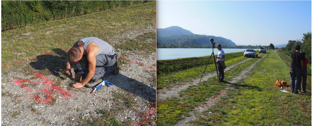
Illustration 75: Installation et relevé (photogrammétrie terrestre et scan laser) des zones de contrôle
