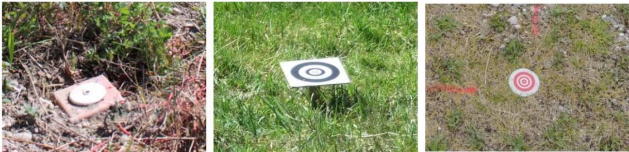
*Illustration 111: Points d'appui/contrôle ancien (à gauche), nouveaux (au centre), et cible délimitant une zone de contrôle (à droite)*
