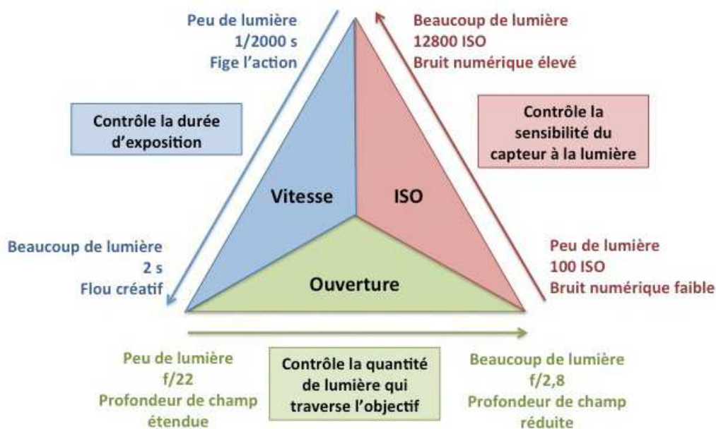
Figure 33: Le triangle de l'exposition expose le compromis nécessaire entre vitesse d'obturation, sensibilité et ouverture.
