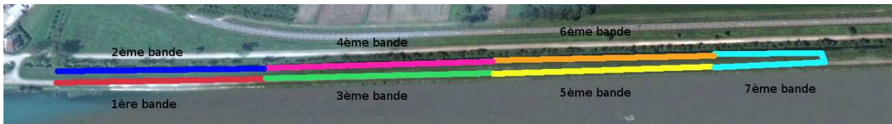
Illustration 9: L'acquisition est découpée en 7 bandes pour satisfaire aux conditions réglementaires et pallier la faible autonomie du drone
