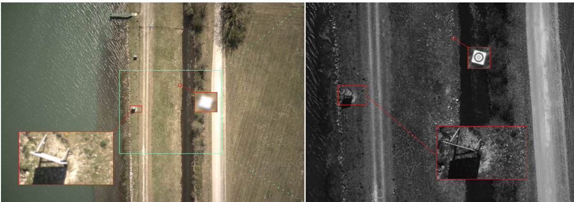
Figure 48: Images capturées par le Sony DSC-RX1 35 mm (à gauche), et par la Camlight 85 mm (à droite). Même en volant à 150 mètres, la Camlight peut acquérir des images d'excellente qualité
