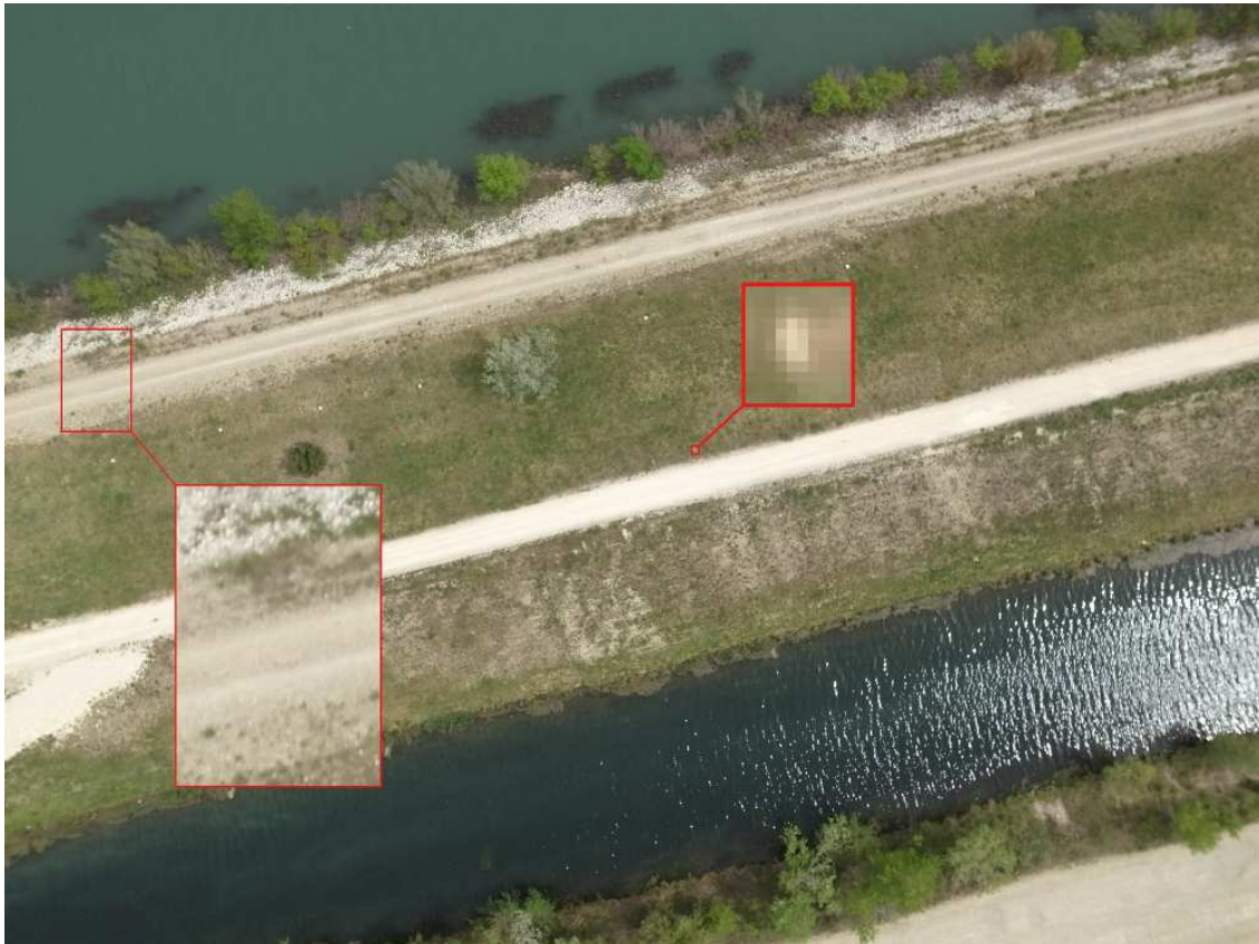
Figure 36: Image acquise avec le X100. Les points d'appui, prévus pour une acquisition à 60 mètres, restent visibles. Un léger flou est perceptible sur certaines images, spécifiquement dans les coins
