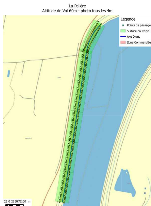
Illustration 37: Plan de vol, position des sommets de prise de vue
