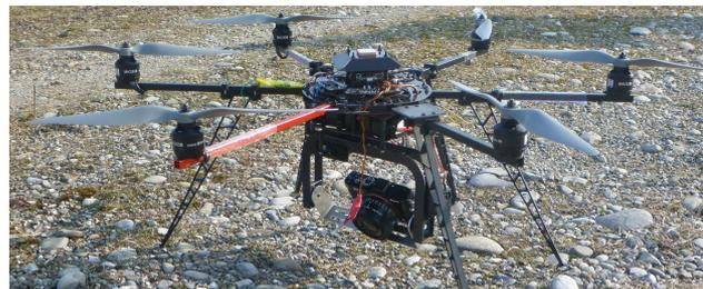
Figure 42: Mikrocopter HexaXL de l'IGN avec le Sony DSC-RX1 sur une nacelle gyrostabilisée
