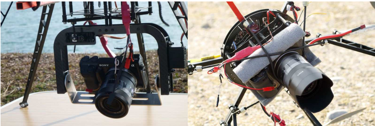
Figure 31: Une nacelle gyrostabilisée de bonne qualité est préférable pour embarquer l'appareil photographique. Néanmoins, un montage simplifié est possible pour acquérir des images nadir de bonne qualité
