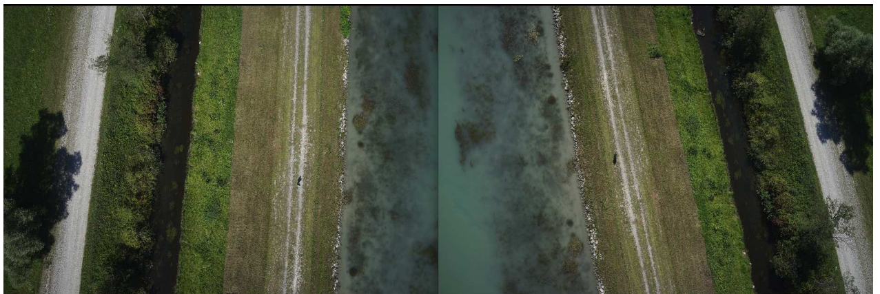
Illustration 77: Échantillon d'image nadir : bande aller (à gauche) et bande retour (à droite)
