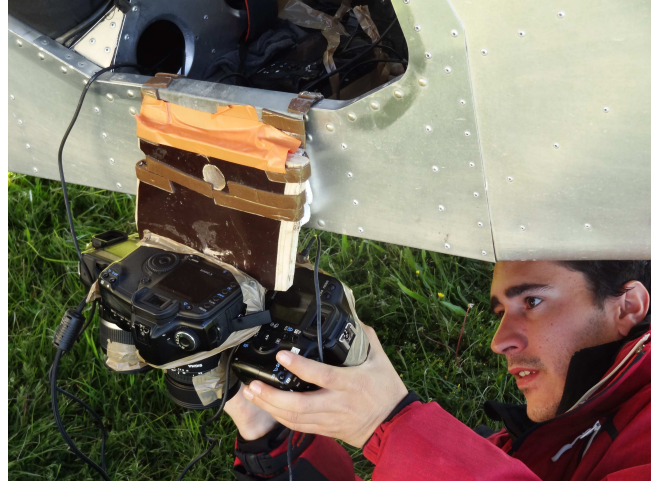
Figure 49: Fixation de trois appareils photographiques sur le bord de l'avion. Un quatrième peut-être installé dans la trappe du cockpit
