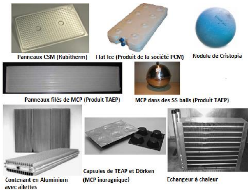
Figure 8 : Exemples de techniques de macro-encapsulation
