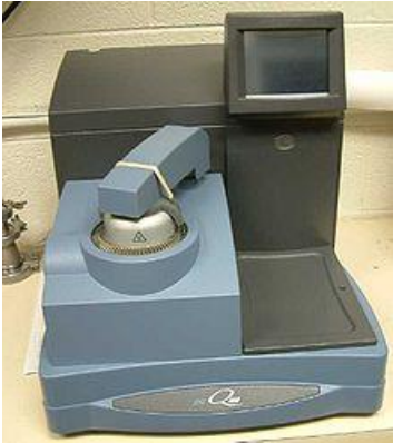
Figure 37 : Appareil utilisé pour les tests de DSC (Q100, TA Instrument)
