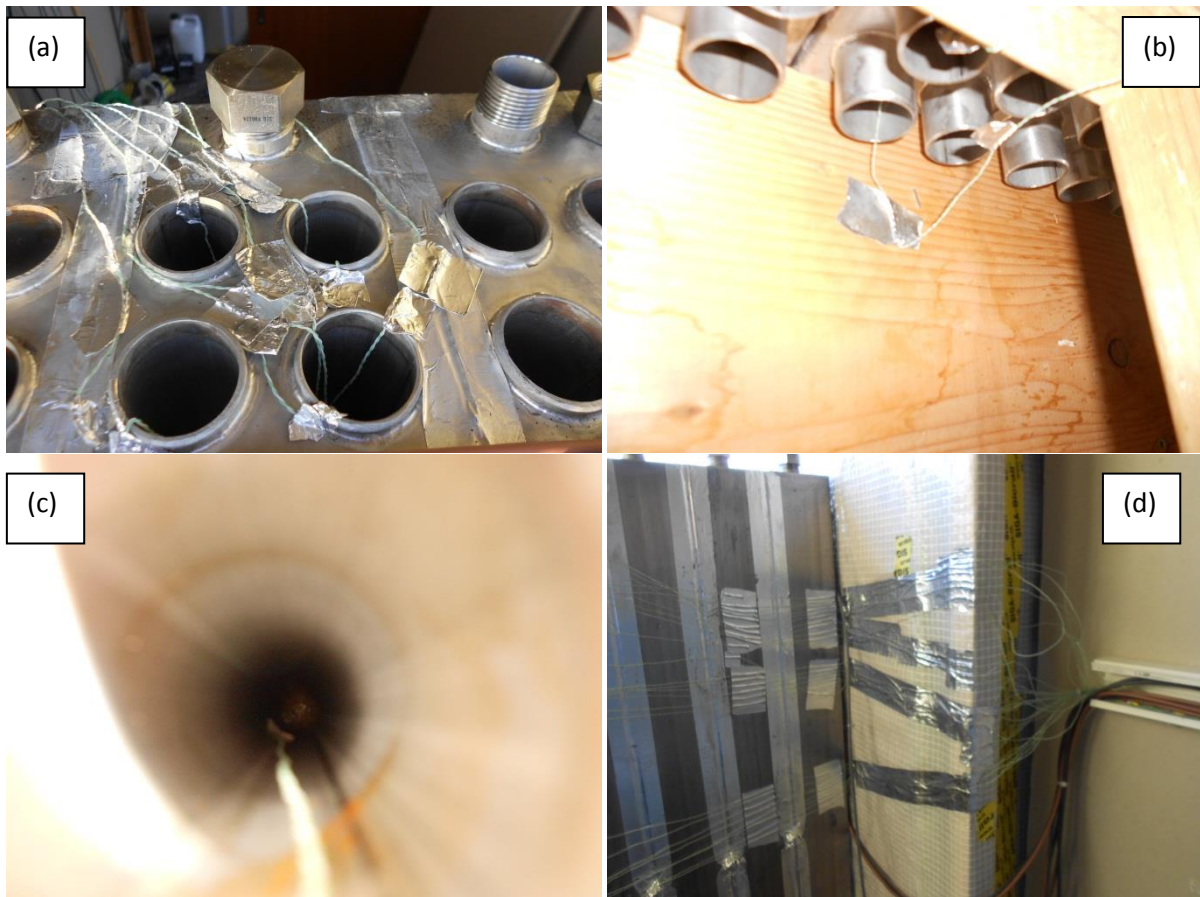
Figure 46 : (a) Passage des thermocouples dans les tubes par le haut ; (b) Passage des thermocouples dans les tubes par le bas ; (c) Thermocouple placé dans un tube ; (d) Passage des câbles à l'intérieur de la cellule
