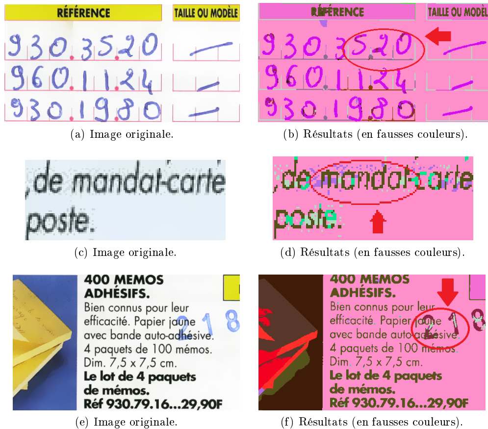
FIGURE 7.12 – Résultats de la segmentation basée sur l’analyse multi-résolution appliquée à un document réel. Les cercles en rouge mettent en évidence certaines erreurs de segmentation.
