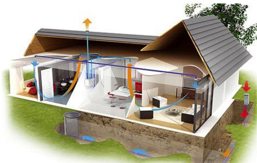
Figure 1-25 : Le principe de fonctionnement d'un puits climatique pour la ventilation d'une maison individuelle.
