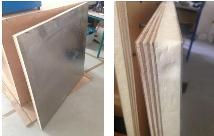
**Figure IV.10:** Composition de l'enveloppe des deux caissons
