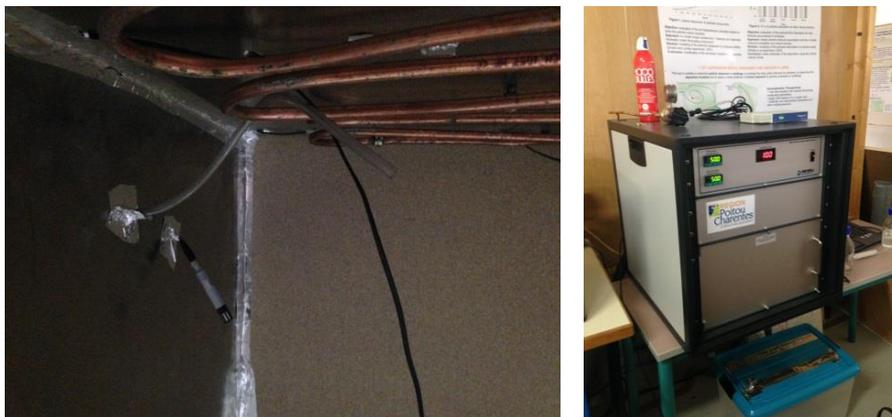
**Figure IV.12:** Contrôle hygrométrique : Michell Humidity Generator10
