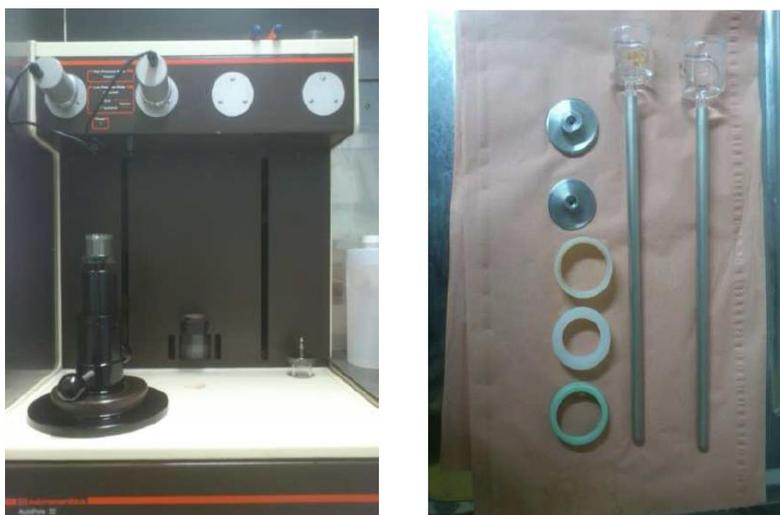
**Figure III.2:** Porosimètre à mercure Micrometrics-Autopore III 9420
