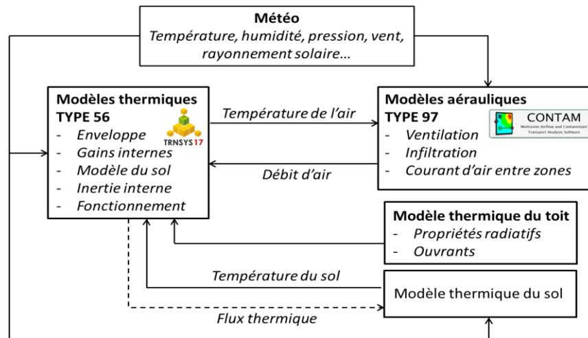
Figure II-3. Modèle du couplage thermoaéraulique du bâtiment.
