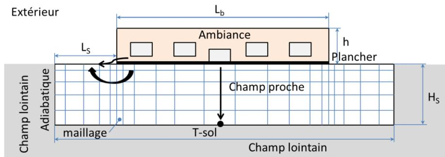
Figure II-7. Modèle 3D du sol.
