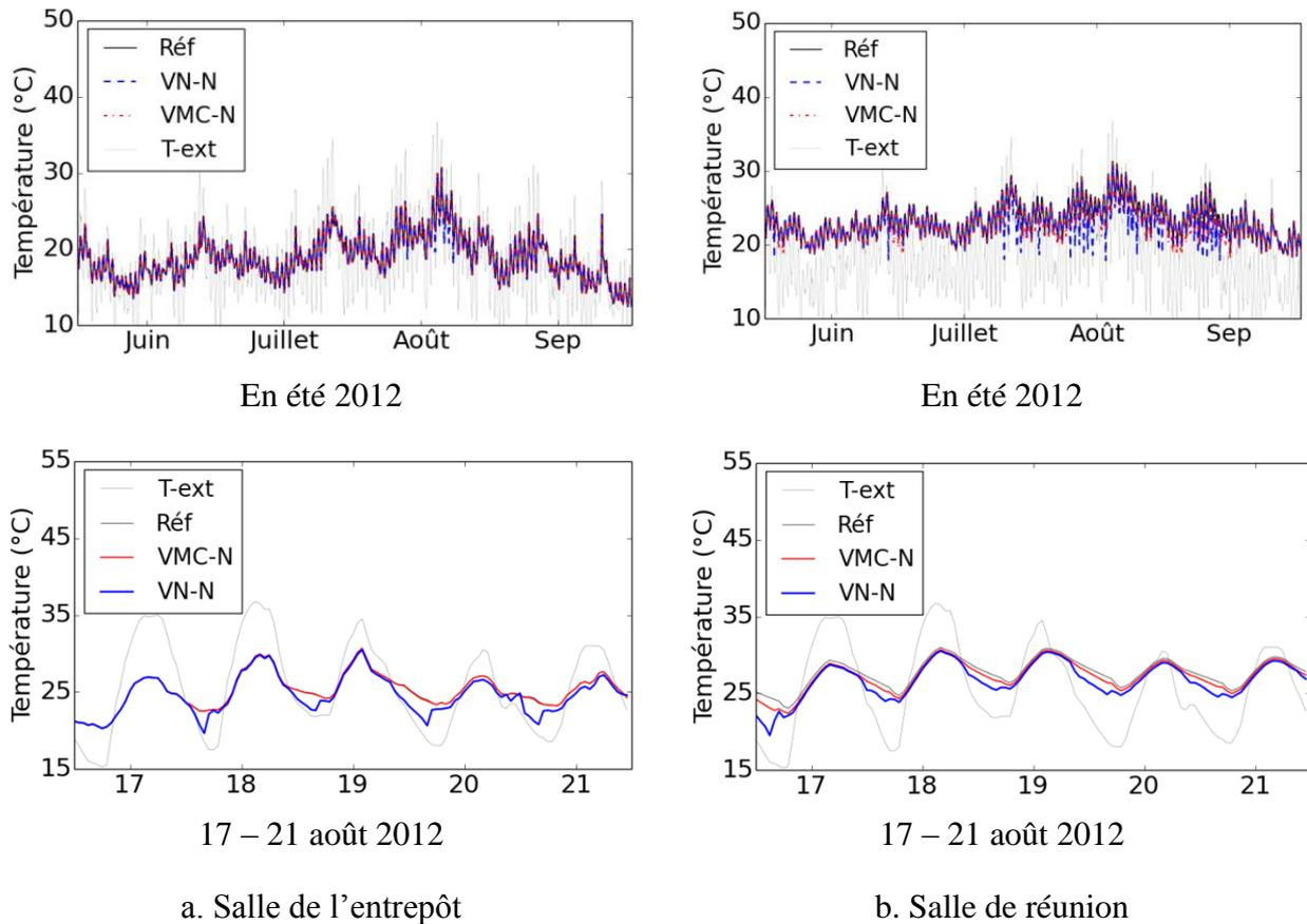
Figure III-19 : Évolution de la température d'air : a. Salle de l'entrepôt, b. Salle de réunion.
