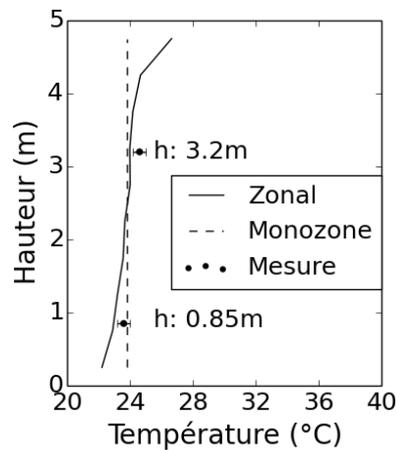
Figure III-16. Profil vertical de la température maximale d'air dans l'entrepôt pendant le mois d'août.
