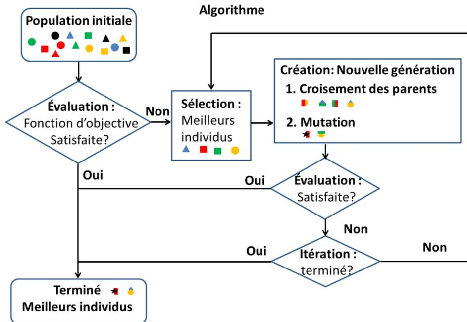
Figure V-4 Mécanismes opérationnels de l'algorithme génétique.
