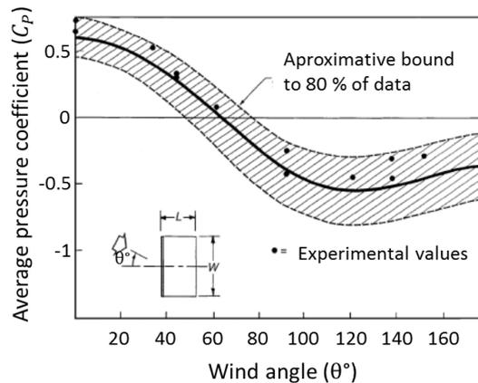
Figure I-20. Coefficient de pression en fonction de l'angle d'incidence du vent pour un bâtiment de faible hauteur (ASHRAE, 2009).
