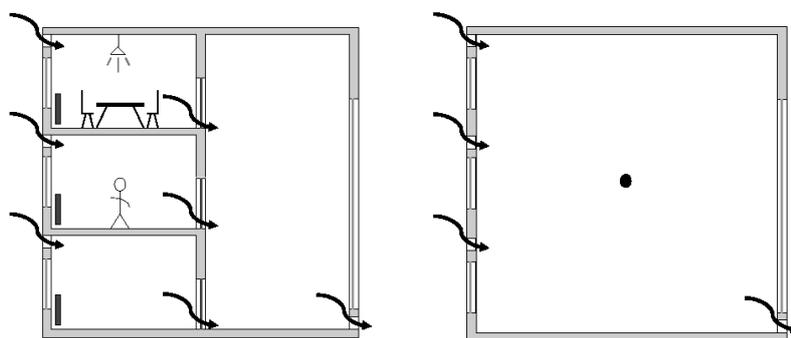
Figure I-6. Configuration d'un bâtiment de bureaux (à gauche) et modélisation selon l'approche monozone (à droite) (Mora, 2003).
