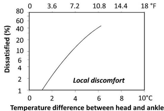
Figure I-25. Insatisfaction par rapport à la différence de température entre les pieds et la tête des occupants (ASHRAE, 2005).
