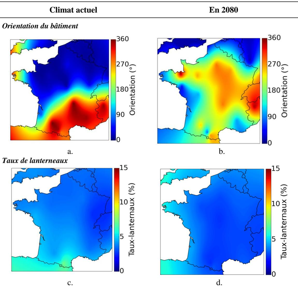
Figure V-27. Orientation et taux de lanterneaux du bâtiment.
