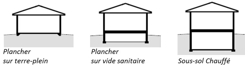
Figure I-10. Différents types du plancher (Labs K et al., 1988).
