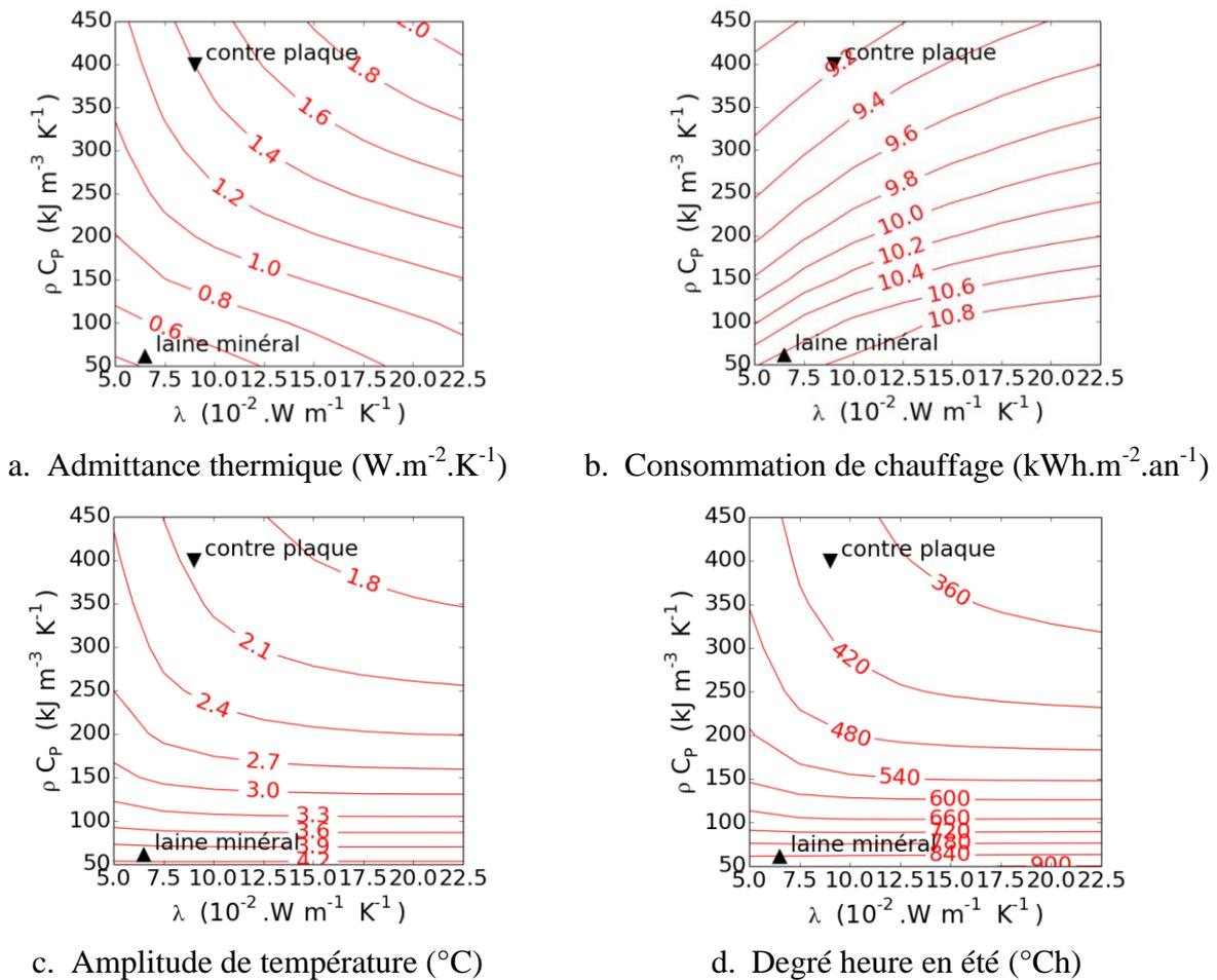
a. Admittance thermique ( $\text{W}\cdot\text{m}^{-2}\cdot\text{K}^{-1}$ )      b. Consommation de chauffage ( $\text{kWh}\cdot\text{m}^{-2}\cdot\text{an}^{-1}$ )
