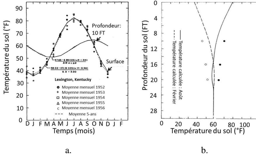
Figure I-12. a. Variation temporelle de la température du sol en surface et à 10 pieds de profondeur, b. Profil de température dans un sol.
