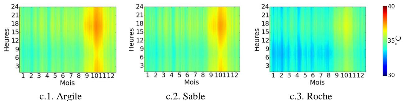
Figure II-15. Température de surface intérieure du plancher en fonction du type de sol et de la localisation géographique.
