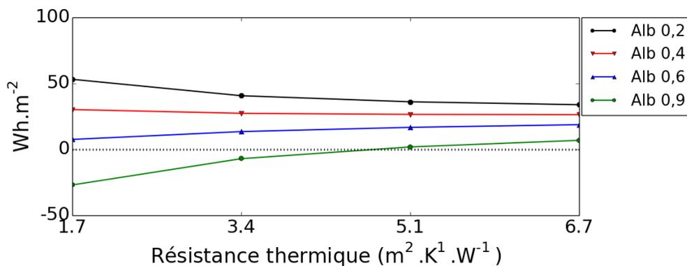
Figure IV-16. Énergie absorbée / émise par la toiture pour la période du 22 au 27 juillet, à Marseille.
