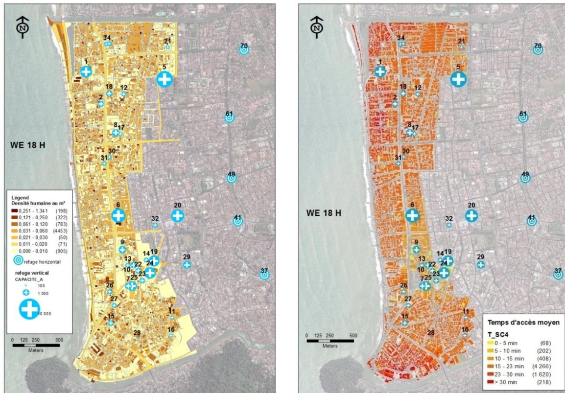
Figure 108. Scénario du week-end classique à 18H. A gauche : carte de densité de population et de position des refuges. A droite : carte des temps d'accès moyen aux refuges.
