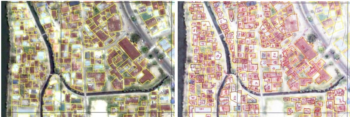
Figure 32. La vectorisation des polygones bâtis en couleur jaune sur l'image satellite avant le travail sur le terrain (gauche). Les polygones rouges avec leur code après la validation terrain (droite).
