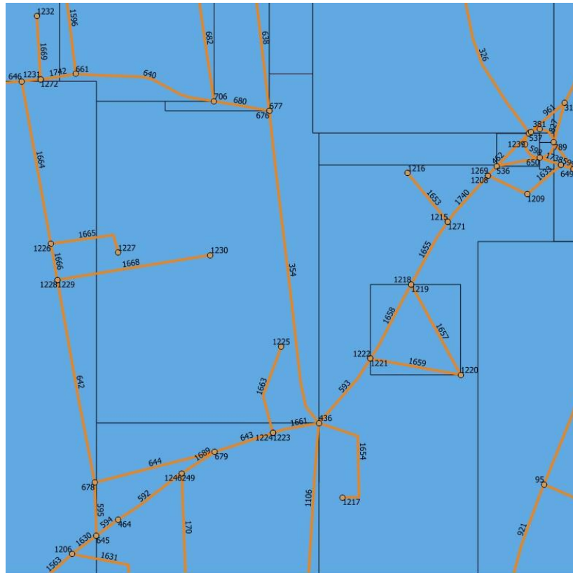
Figure 77. Vue du graphe avec les noeuds et les arcs étiquetés avec leurs identifiants. Les rectangles correspondent à la table voie.face.
