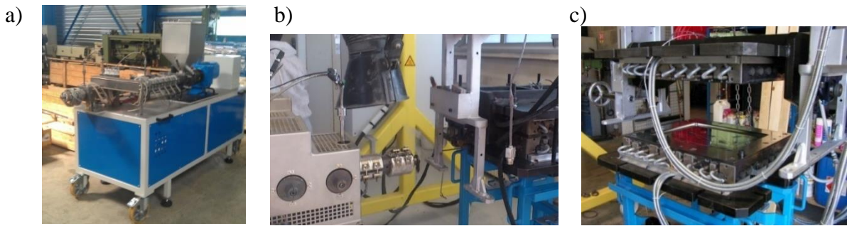
Figure VI-1 : Photographies de l'extrudeuse, du pot de transfert (a), de l'unité d'injection (b) et du moule (c)
