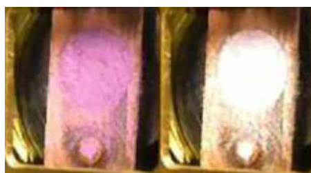
Figure 3.2 – Visualisation du thermochromisme des composés de la famille du [Fe(NH_2 - trz)_3]^{2+} . Le composé est rose dans l’état BS et blanc dans l’état HS.
