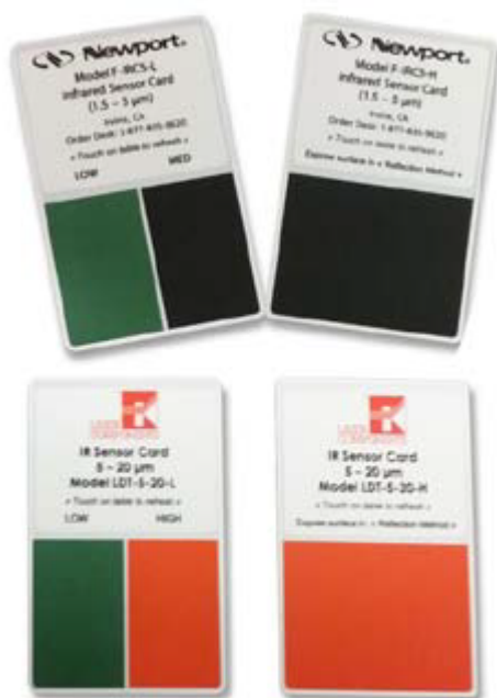
Figure 3.14 – Exemple de cartes de visualisation infrarouge, basées sur le principe décrit précédemment, développées au LOMA et disponibles dans le commerce.
