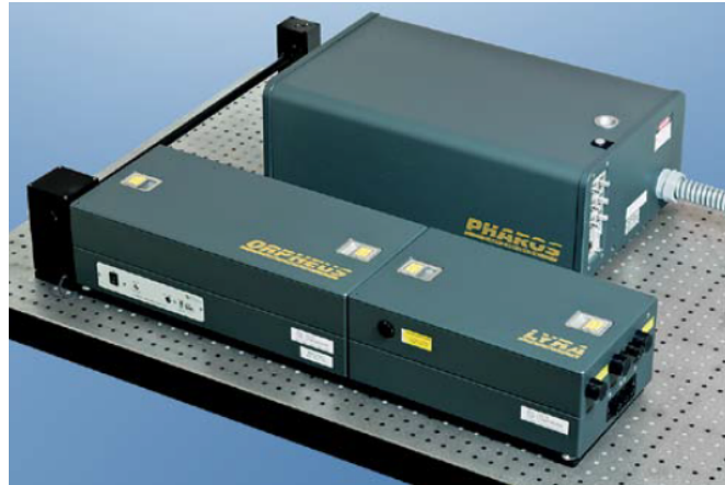
Figure 5.7 – Photographie du système laser utilisé avec le laser de pompe Pharos et l’OPA Orpheus
