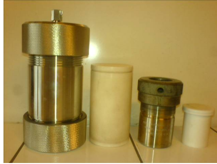
FIGURE 1.18 – Autoclave utilisé pour le traitement hydrothermal.
