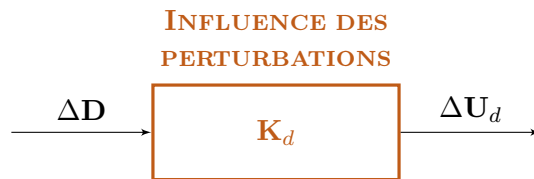
Figure 2.21 – Modèle proposé pour représenter l'influence des perturbations sur l'amplitude de la tension
