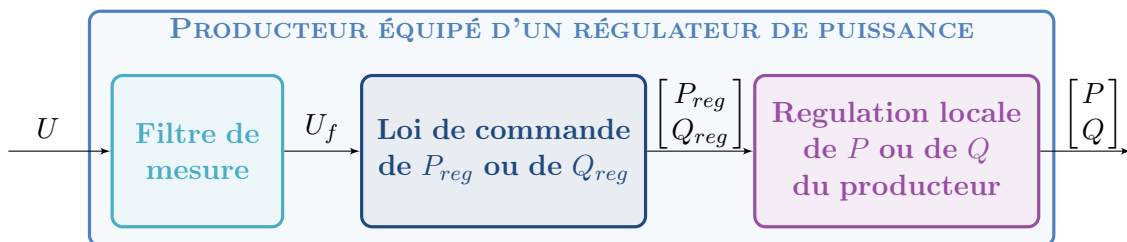
Figure 2.5 – Structure du modèle proposé pour un producteur équipé d'un régulateur
