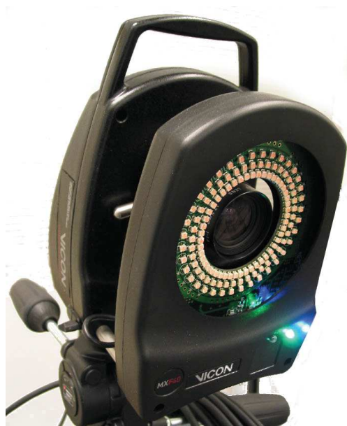
Figure 2.1: Système de capture de mouvement Vicon® constitué de plusieurs caméras entourant l'espace de mouvement, d'un ordinateur équipé du logiciel Vicon Nexus et d'une unité d'interface entre les caméras et l'ordinateur.
