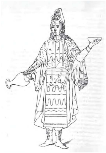
(a) Schéma de la serveuse automate [Philon de Byzance et de Vaux, 1902]
