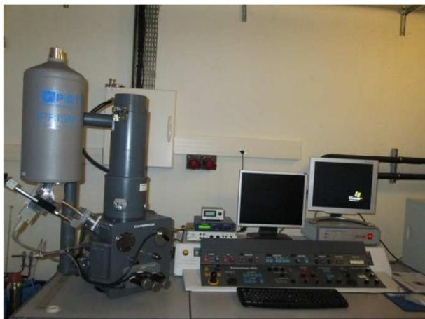
**Figure II.6: Microscope électrique à balayage (STEREOSCAN 260)**
