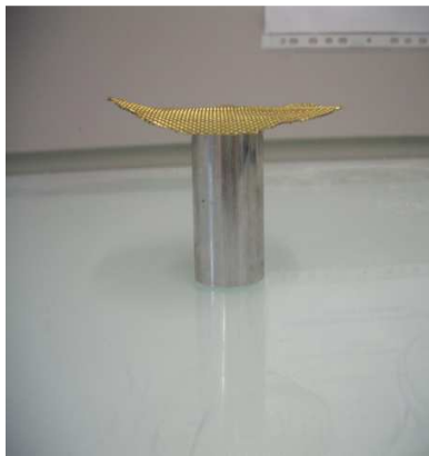
Figure III.3: Grille fixée à un support métallique
