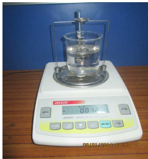
Figure III.11 : Dispositif de mesure de la masse volumique (LETTM).
