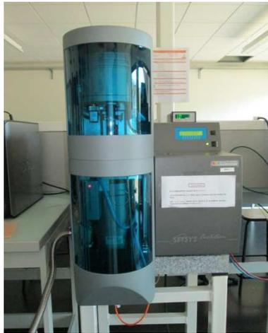
**Figure II.10 : Dispositif de mesure ATD/ATG**
