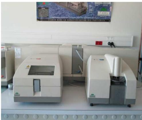
**Figure II.1: Granulomètre par diffraction laser Mastersizer 2000**
