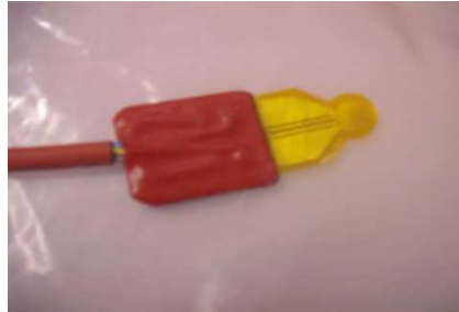
Figure III.35 : Sonde utilisée pour les mesure de conductivité thermique par la méthode de HOT-DISK
