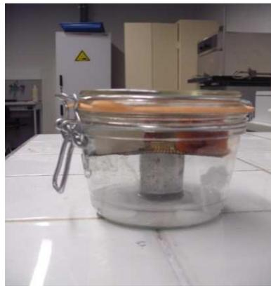
Figure III.4 : Disposition des échantillons dans le bocal
