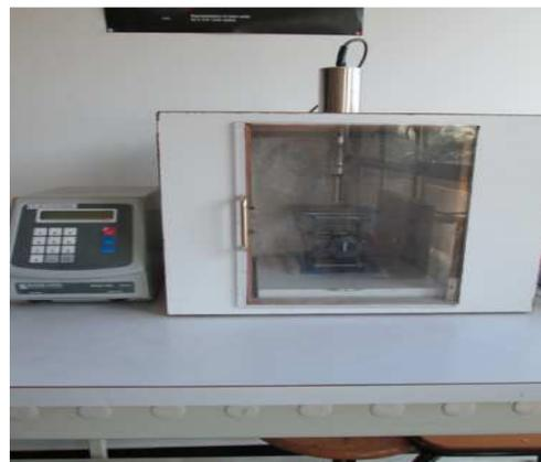
**Figure II.2: Sonotrode**
