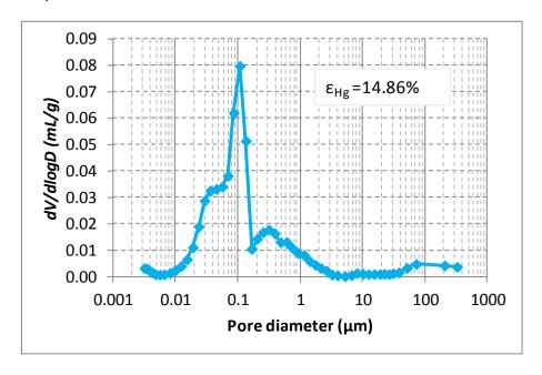
Figure IV. 21. Distribution de la taille des pores du béton voile
