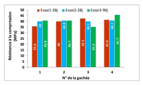
Figure IV. 19. Résistance à la compression
