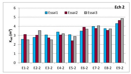
Figure IV. 30. Répétabilité des mesures de la perméabilité intrinsèque des échantillons prélevés suivant la ligne verticale E
