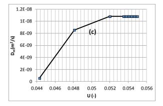
Figure III. 17. Coefficient de diffusion hydrique du BHP A1 (a), du béton C15 (b) [94] et du béton BO [39]
