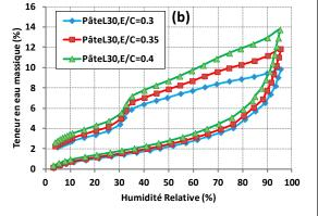
Figure II. 20. Comparaison des isothermes de sorption à  $20^{\circ}$ C de : (a)Pâte1 et (b) pâte L30 avec différents rapport E/C=0,3 ; 0,35 et 0,4 à 28 jours
