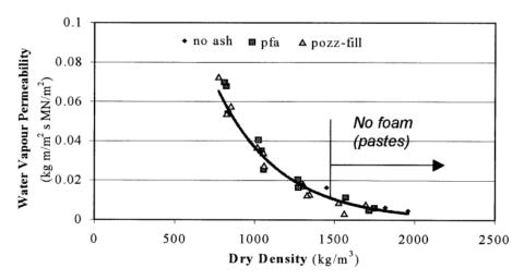
Figure I. 7. Perméabilité à la vapeur d'eau vs masse volumique sèche [42]
