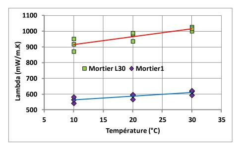
Figure II. 37. Comparaison de la conductivité thermique en fonction de la température du mortier1 et mortierL30 à 28 jours d'âge
