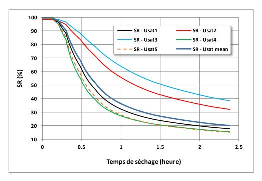
Figure IV. 15. Effet de la variabilité de la teneur en eau à saturation sur l'évolution du degré de saturation au cours du séchage
