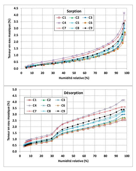
Figure IV. 34. Variabilité des isothermes de sorption et de désorption suivant la ligne verticale C à 20°C
