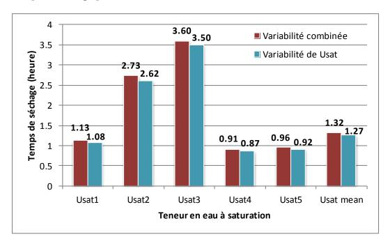
Figure IV. 17. Effet combiné de la variabilité du coefficient de diffusion et de la teneur en eau à saturation du mortier sur le temps de séchage nécessaire pour atteindre SR=30%
