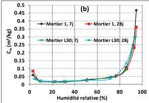
Figure II. 23. Capacité de stockage d'humidité à 7 jours et 28 jours à 20°C de la pâte de ciment 1 et L30 (a)et du mortier 1 et L30 (b)
