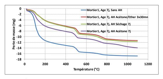
Figure II. 8. Évolution de la masse de l'échantillon au cours d'une ATG du mortier 1 en fonction des techniques d'arrêt d'hydratation utilisées
