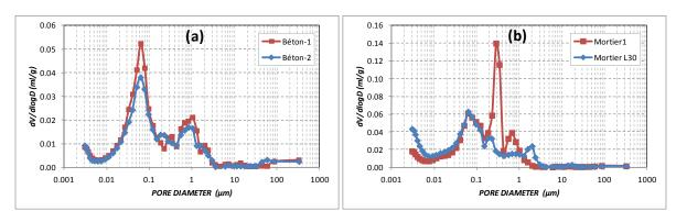
Figure II. 4. Distributions de la taille des pores obtenues par intrusion au mercure du béton (a) et du mortier 1 et L30 (b)
