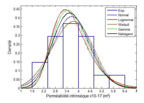
Figure IV. 32. Distribution de la perméabilité intrinsèque suivant les deux lignes verticales B et E et les lois de distribution associées
