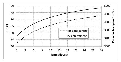
Figure IV. 43. Évolution de la pression de vapeur et de l'humidité relative dans le cas d'une simulation déterministe
