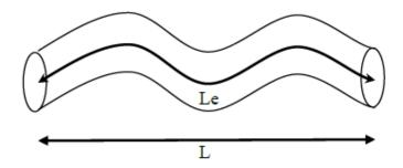
Figure I. 2. Tortuosité d'un pore
