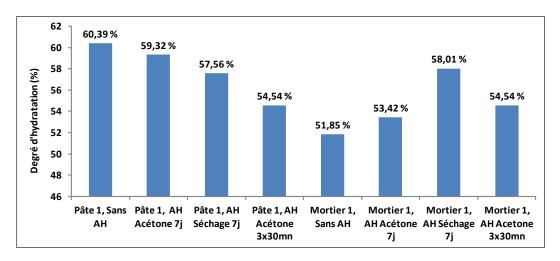
Figure II. 10. Degré d'hydratation des pâtes de ciment 1 et mortier 1 à l'âge de 7 jours
