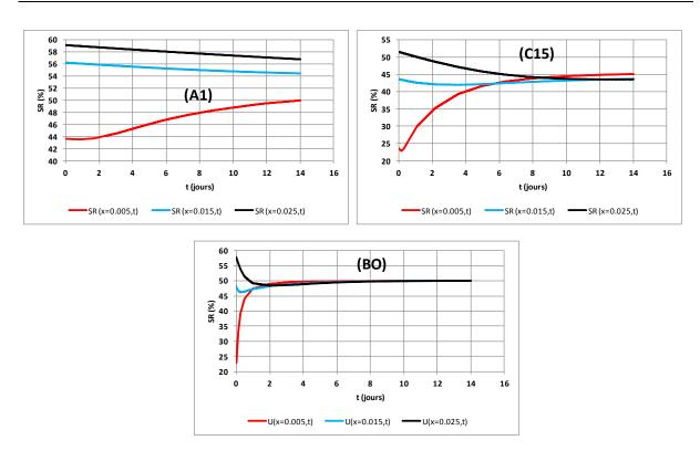
Figure III. 27. Évolution du degré de saturation des trois matériaux au cours de l'essai de carbonatation pendant 14 jours
