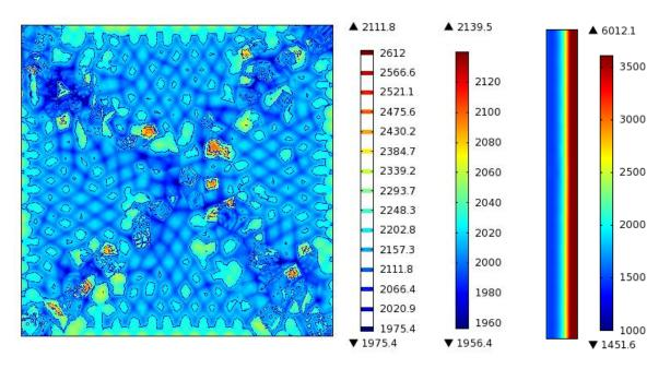
Figure IV. 44. Évolution de la pression de vapeur suivant une coupe surfacique du voile à une profondeur x=0,1m et une coupe suivant l'épaisseur à une hauteur de 1 m (déterministe)
