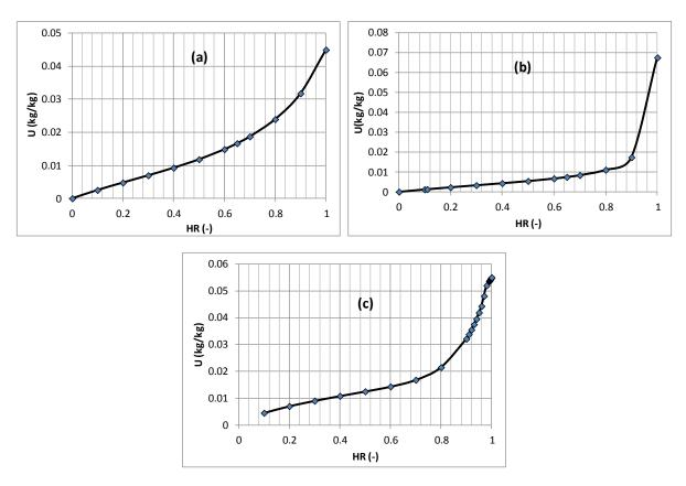
Figure III. 15. Isotherme de désorption des matériaux : (a) BHP A1, (b) béton C15 [94] et (C) béton courant BO [39]
