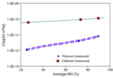
Figure I. 6. Perméabilité à la vapeur d'un contreplaqué et d'un isolant de cellulose [38]
