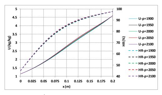
Figure III. 6. Évolution des profils hydriques et d'humidité en fonction de la masse volumique après 10h de transfert
