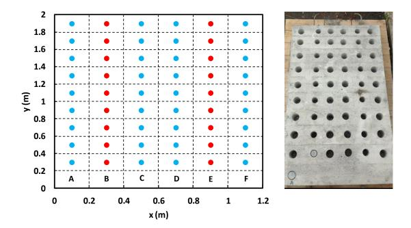
Figure IV. 18. Position des carottes dans le voile expérimental
