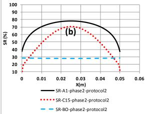
Figure III. 22. Comparaison des Profils de degré de saturation à l'issu de la phase2 des matériaux A1, C15 et BO selon le protocole 1 (a) et le protocole 2 (b)
