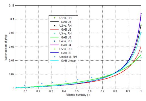
Figure IV. 10. Isotherme d'adsorption du mortier obtenue par le fit du modèle GAB avec différentes teneurs en eau à saturation
