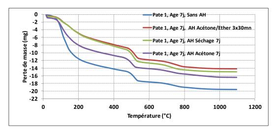
Figure II. 7. Évolution de la masse de l'échantillon au cours d'une ATG de la pâte de ciment 1 en fonction des techniques d'arrêt d'hydratation utilisées
