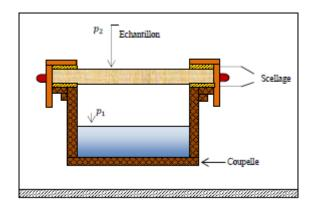
Figure I. 21. Schéma représentatif de la coupelle [20]
