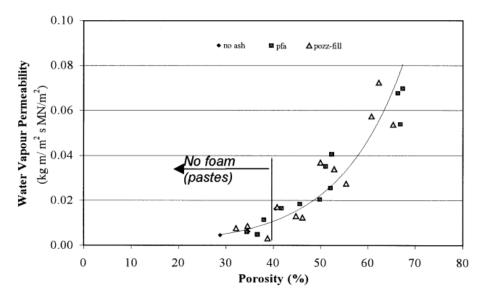
Figure I. 8. Perméabilité à la vapeur vs porosité [42]
