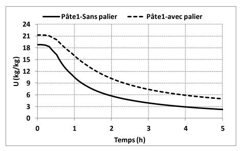
Figure III. 13. Comparaison de l'évolution de la teneur en eau au milieu de l'échantillon (x=0, 1m) en fonction du temps de séchage pour la pâte 1 à 28 jours d'âge
