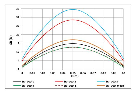
Figure IV. 14. Effet de la variabilité de la teneur en eau à saturation sur le profil de degré de saturation à l'issue du séchage
