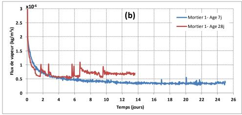
Figure II. 34. Évolution du flux de vapeur en fonction du temps de : (a) la pâte de ciment 1 et (b) du mortier 1 en fonction de l'âge
