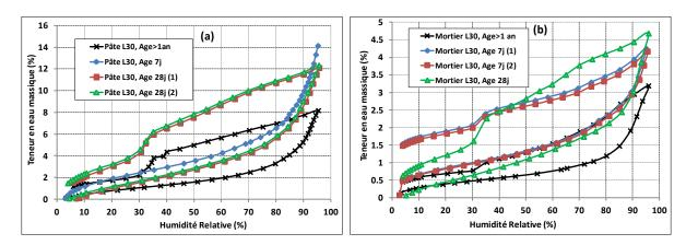
Figure II. 16. Comparaison des isothermes d'adsorption et de désorption à 20°C à 7jours, 28 jours et 1an de : (a) pâte de ciment L30, (b) mortierL30
