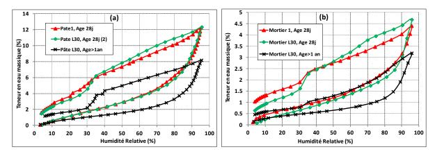
Figure II. 17. Comparaison des isothermes d'adsorption et de désorption à 20°C de : (a) pâte de ciment 1 et L30 (28j et 1an), (b) mortier 1 et L30 (28j et 1an)
