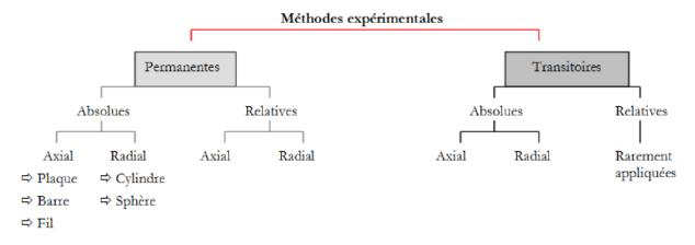
Figure I. 24. Vue d'ensemble sur les méthodes expérimentales de mesure de la conductivité thermique [98] [17]
