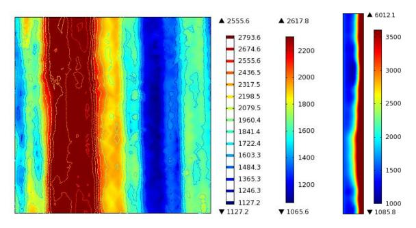
Figure IV. 48. Évolution de la pression de vapeur suivant une coupe surfacique du voile à une profondeur x=0.1m et une coupe suivant l'épaisseur à une hauteur de 1 m
