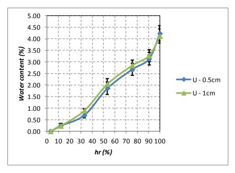
Figure IV. 36. Isothermes de désorption de la vapeur d'eau mesurées sur des échantillons de BHP de 5mm et 10mm d'épaisseur [94]
