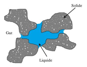
Figure I. 1. Représentation schématique d'un milieu poreux
