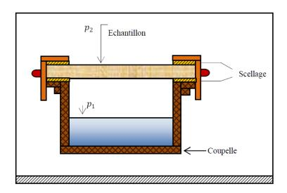
Figure II. 33. Schéma représentatif d'une coupelle
