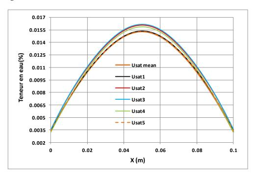
Figure IV. 13. Effet de la variabilité de la teneur en eau à saturation sur les profils de teneur en eau massique
