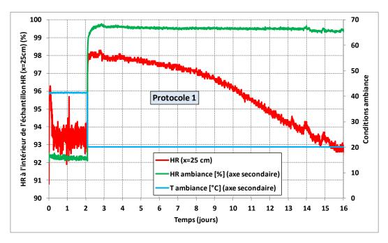
Figure III. 30. Évolution de l'humidité relative au centre de l'échantillon après séchage selon le protocole 1
