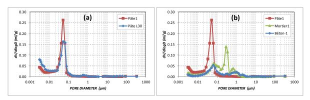
Figure II. 5. Distributions de la taille des pores obtenues par intrusion au mercure des pâtes de ciment (a) et comparaison du béton, mortier 1 et pâte 1 (b)
