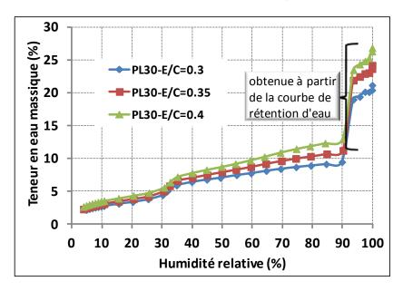
Figure II. 28. Courbe de désorption complète de la vapeur d'eau de la pâte de ciment L30 à 28 jours d'âge
