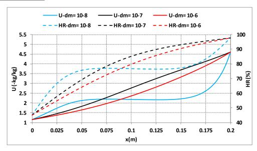
Figure III. 5. Évolution des profils hydriques et d'humidité en fonction du coefficient de diffusion avec une variabilité plus importante après 10h de transfert
