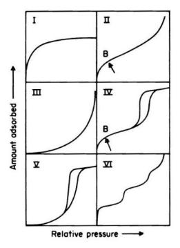
Figure II. 29. Classification des isothermes d'adsorption physique donnée par l'IUPAC [23]
