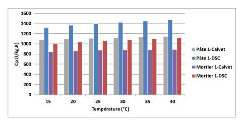
Figure II. 45. Comparaison des valeurs de Cp obtenues par DSC et par calorimétrie Calvet
