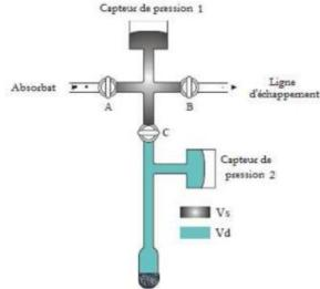
Figure II. 13. Représentation schématique d'un porte échantillon
