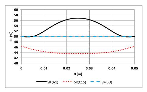
Figure III. 28. Profil de degré de saturation à l'issue de 14 jours d'essai de carbonatation
