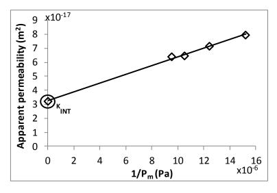
Figure IV. 27. Perméabilité apparente de l'échantillon B2 en fonction de l'inverse de  $P_m$  – Perméabilité intrinsèque
