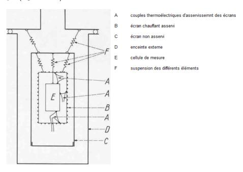
Figure I. 32. Schéma de montage d'un calorimètre adiabatique [108]
