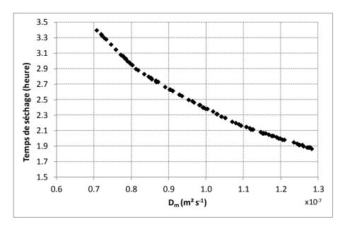
Figure IV. 5. Évolution du temps de séchage en fonction de la valeur du coefficient de diffusion d'humidité
