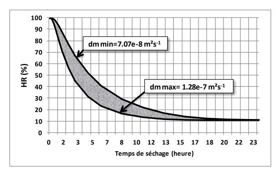
Figure IV. 6. Effet de la variabilité du coefficient de diffusion sur l'évolution de HR à x=0.05 m pendant 24 heures de séchage
