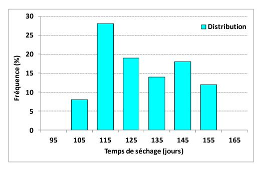
Figure IV. 8. Histogramme du temps de séchage nécessaire pour atteindre SR=60% à x=0,025 m du BHP A1
