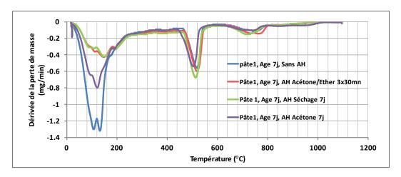
Figure II. 9. Dérivée des pertes de masse dTG de la pâte de ciment 1 en fonction des techniques d'arrêt d'hydratation utilisées
