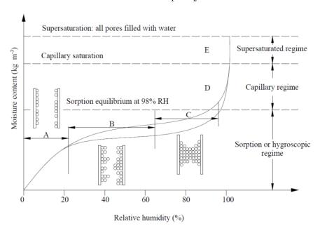
Figure I. 4. Diagramme schématique d'une courbe de sorption [21]
