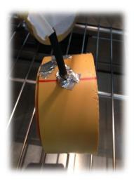
Figure III. 29. Photo du dispositif expérimental de suivi de l'humidité relative dans le matériau
