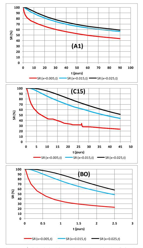
Figure III. 25. Évolution du degré de saturation des trois matériaux jusqu'à obtention du degré de saturation optimum (SR=50%) au centre de l'échantillon
