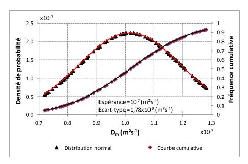
Figure IV. 2. Distribution normale et sa courbe cumulative du coefficient de diffusion d'humidité
