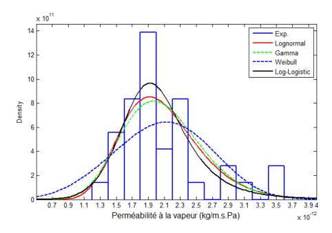
Figure IV. 25. Distribution de la perméabilité à la vapeur
