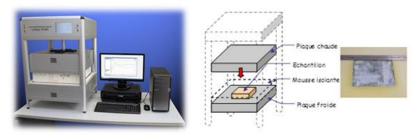
Figure II. 35. Dispositif de mesure de la conductivité thermique en régime permanent (λ-Meter EP 500)
