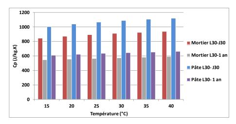
Figure II. 42. Comparaison de la chaleur spécifique des matériaux à substitution du ciment par du laitier à l'âge 30 jours et à 1 an
