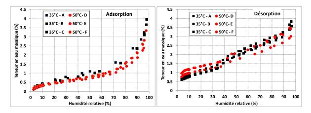
Figure II. 22. Effet de la température sur l'adsorption et la désorption de la vapeur d'eau du béton REF1
