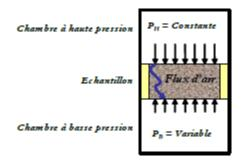
Figure IV. 26. Schéma de principe de la méthode de perméabilité au gaz [15]
