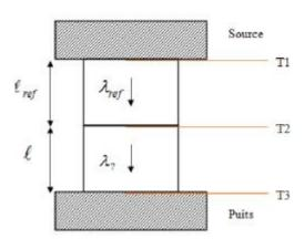
Figure I. 25. Principe de la méthode de comparaison [17, 98]
