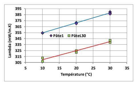
Figure II. 36. Comparaison de la conductivité thermique en fonction de la température de la pâte1 et pâteL30 à 28 jours d'âge
