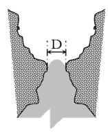
Figure I. 16. Diamètre mesuré par la porosimètre [15]
