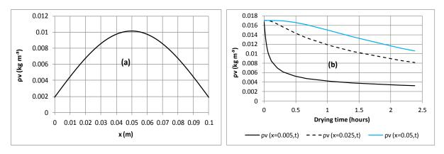
Figure IV. 12. (a) Profil de teneur en vapeur à l'issu du séchage; (b) son évolution à différentes profondeurs dans l'échantillon
