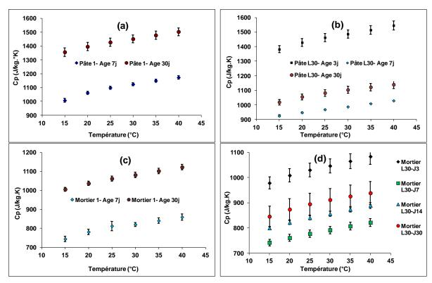
Figure II. 40. Évolution du Cp en fonction de la température et de l'âge de la pâte1 (a), pâte L30 (b), mortier 1 (c) et mortier L30 (d)
