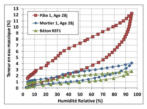
Figure II. 18. Comparaison des isothermes d'adsorption et de désorption à 20°C de la pâte de ciment 1, mortier 1 et du béton REF1
