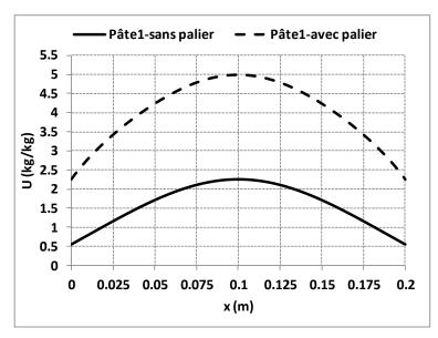
Figure III. 12. Comparaison des profils de teneur en eau à l'issue de 5 heures de séchage de la pâte1 avec et sans palier de saturation à 28 jours d'âge
