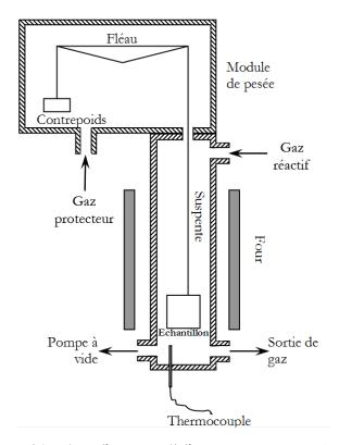
Figure II. 6. Représentation schématique d'un appareil d'ATG (type Setaram - SETSYS Évolution 16/18) [15]
