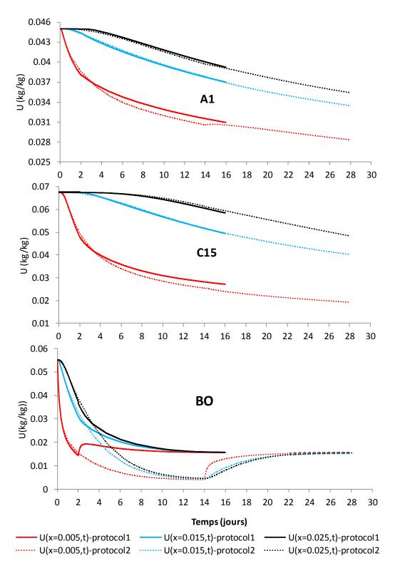
Figure III. 23. Évolution de la teneur en eau au cours des deux phases 1 et 2 selon les deux protocoles de pré-conditionnement 1 et 2
