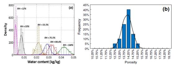
Figure I. 33. (a) distribution statistique de la teneur en eau à l'équilibre du béton A1 [94, 118, 120] ;(b) Distribution de la porosité du béton A2 après un séchage à 105°C [118]
