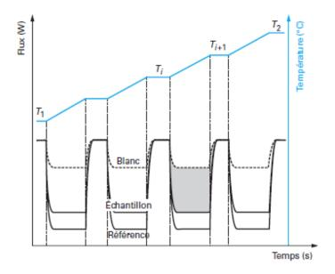
Figure I. 31. Thermogramme obtenu par la méthode par pallier [106]
