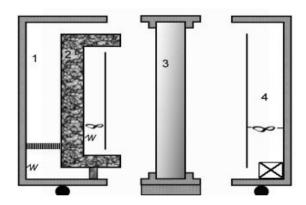
Figure I. 26. Schéma de principe du dispositif de la boite chaude gardée
