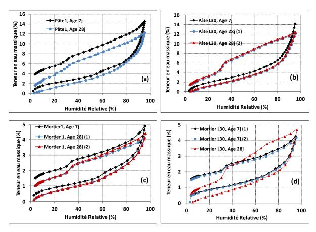
Figure II. 14. Comparaison des isothermes d'adsorption et de désorption de la vapeur d'eau à 20°C à 7 et 28 jours de : (a) pâte de ciment 1, (b) pâte de ciment L30, (c) mortier1 et (d) mortier L30
