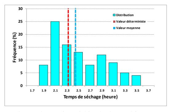
Figure IV. 4. Histogramme du temps de séchage nécessaire pour atteindre SR=30%
