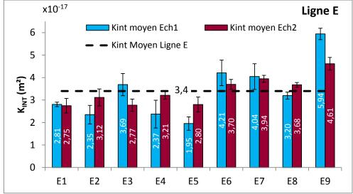
Figure IV. 31. Reproductibilité des mesures de la perméabilité intrinsèque suivant les deux lignes verticales B et E
