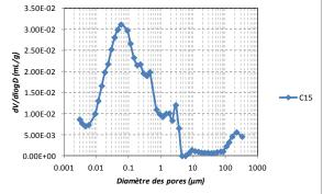
Figure III. 14. Distributions de la taille des pores obtenues par intrusion de mercure du BHP A1 et du béton C15 [94]
