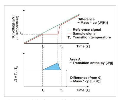
Figure II. 39. Principe de mesure de la chaleur spécifique par DSC
