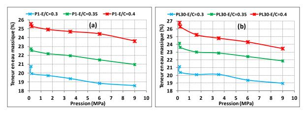
Figure II. 26. Courbe de rétention d'eau en fonction du rapport E/C de la pâte de ciment 1 (a) et de la pâte de ciment L30 (b) à l'âge 28 jours
