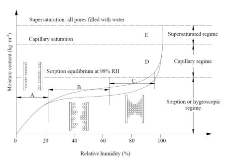
Figure II. 11. Diagramme schématique d'une courbe d'isotherme d'adsorption et de désorption [21]
