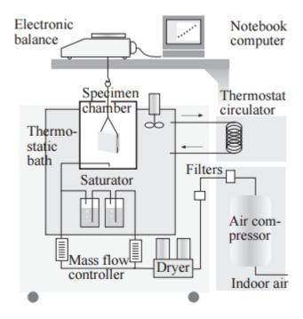
Figure I. 18. Système de mesure des isothermes de sorption [93]
