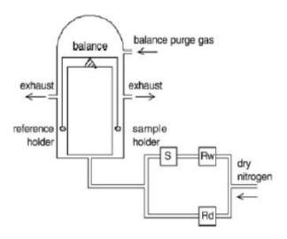
Figure I. 20. Schéma simplifié du DVS [95]
