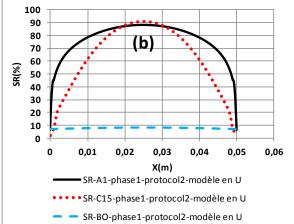
Figure III. 20. Comparaison des Profils de degré de saturation après séchage des matériaux A1, C15 et BO selon le protocole 1 (a) et le protocole 2 (b)
