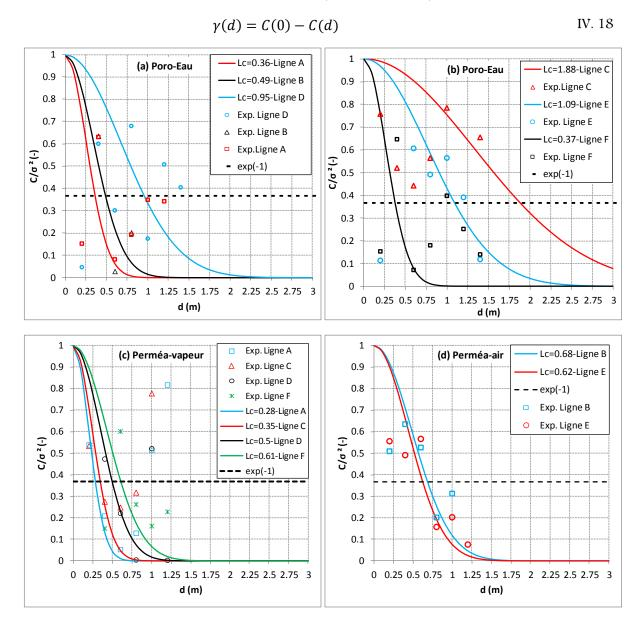
Figure IV. 37. Identification des longueurs de corrélation à partir des variogrammes pour (a & b) la porosité, (c) la perméabilité à la vapeur et (d) la perméabilité à l'air
