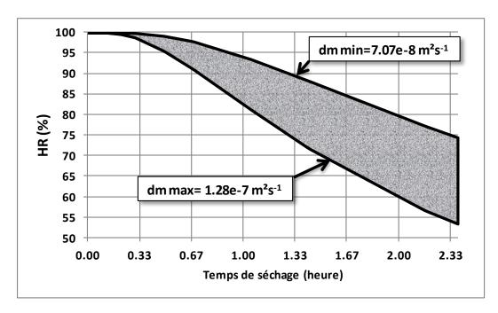
Figure IV. 7. Effet de la variabilité du coefficient de diffusion sur l'évolution de HR à x=0.05 m pendant le temps de séchage déterministe (2.38 h)
