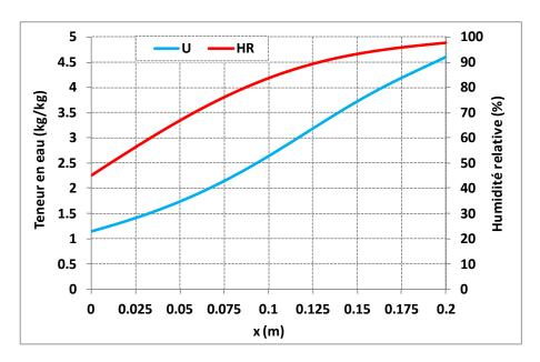
Figure III. 2. Profils de teneur en eau et d'humidité du mortier après 10h de transfert
