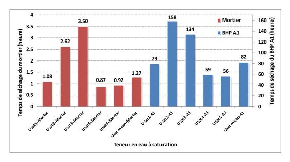
Figure IV. 16. Effet de la variabilité de la teneur en eau à saturation sur le temps de séchage
