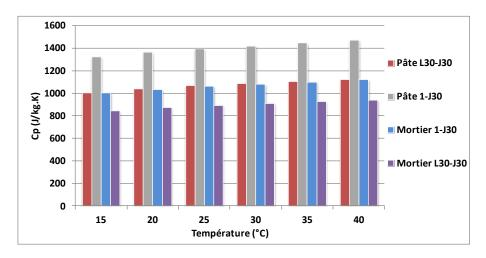
Figure II. 41. Comparaison de la chaleur spécifique des différents matériaux testés à l'âge 30 jours
