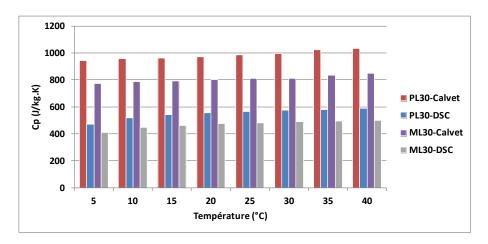
Figure II. 46. Comparaison des valeurs de Cp obtenues par DSC et par calorimétrie Calvet après un pré-conditionnement par séchage à 105°C des matériaux âgés de plus d'un an
