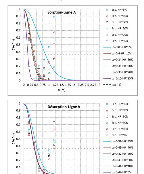
Figure IV. 38. Identification des longueurs de corrélation à partir des variogramme pour la sorption et la désorption suivant la ligne A et en fonction de HR
